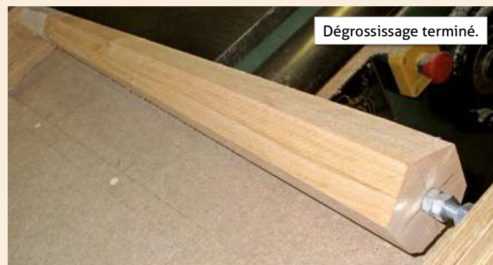
Blocage de la pièce à l'aide d'une cale pour effectuer les passes de dégrossissage.
