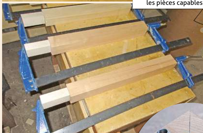
Assemblage des carrelots de sycomore aux carrelots de merisier pour former les pièces capables.
