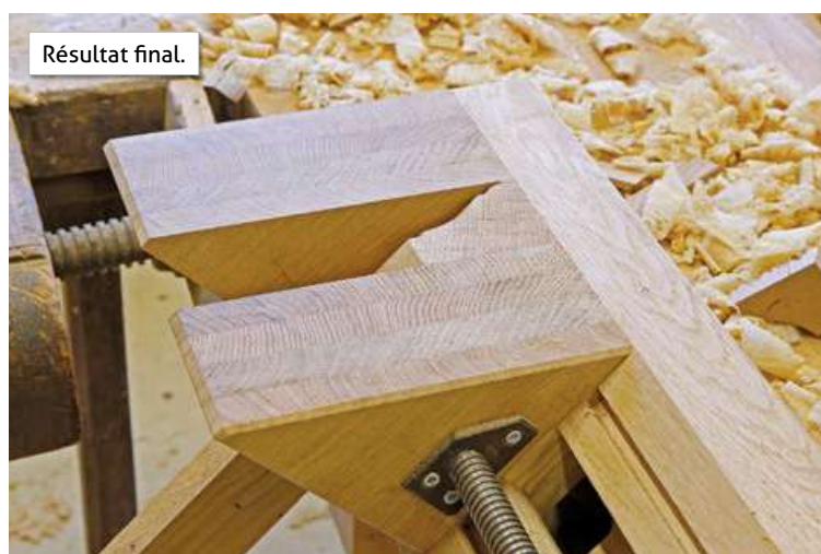
Résultat parfait d'un onglet réalisé d'après le même procédé.
