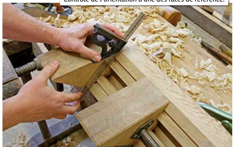
Contrôle de l'orientation d'une des faces de référence.
