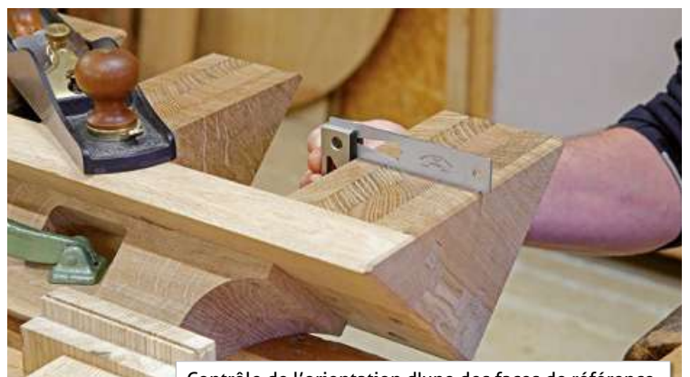
Contrôle de l'orientation d'une des faces de référence.
