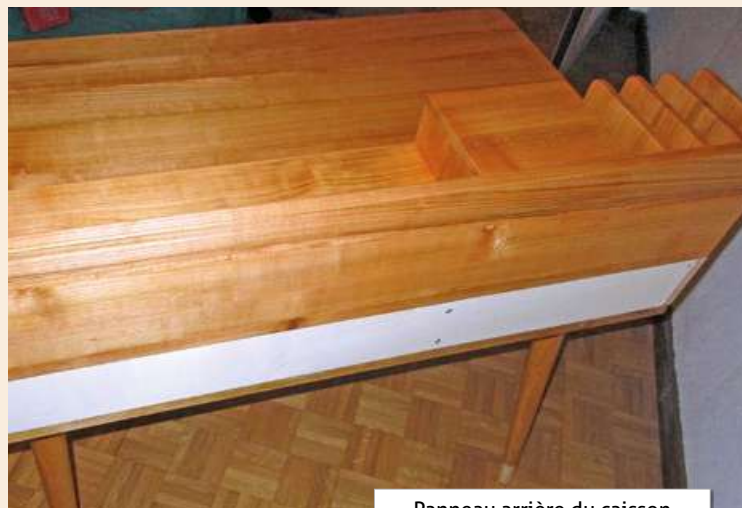
Panneau arrière du caisson positionné en feuillures et vissé.
