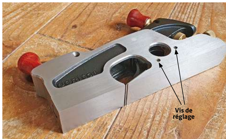
Deux vis sont accessibles sur chacun des flancs de certains modèles, afin de pouvoir régler le positionnement latéral du fer.
