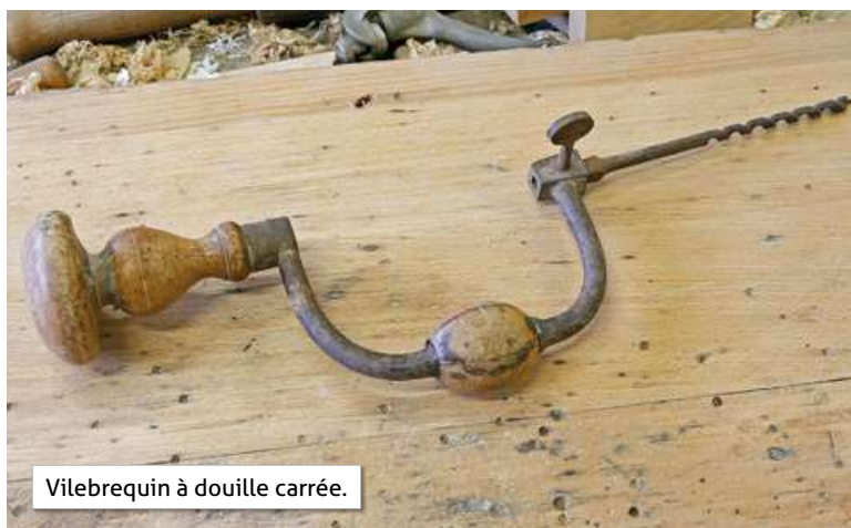
Les mèches à queues pyramidales n'ont aucune chance de glisser dans le mandrin !
