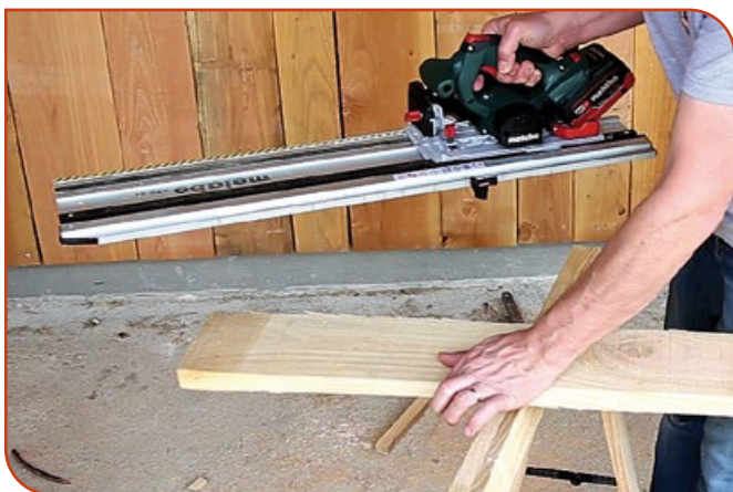
La scie vient se « clipser » sur le rail pour en devenir solidaire.
