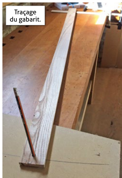
Traçage du contour des pièces à débiter à l'aide du gabarit.
