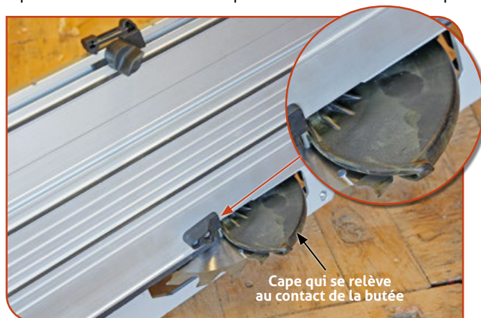
Scie en position de travail (système vu de dessous).
