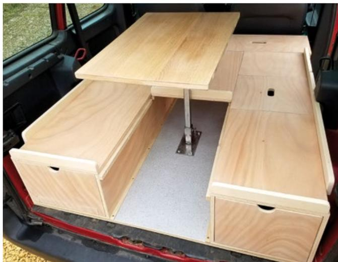
Le support du pied sous le plateau est déporté pour deux raisons : la première pour qu'il ne gêne pas les jambes et la deuxième afin de permettre de faire pivoter le plateau de table de 180° pour le positionner plus vers l'avant.
