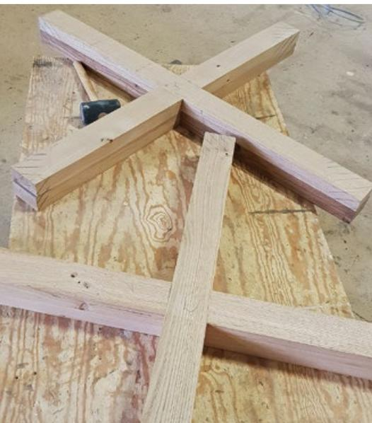
**D'abord le piétement.** J'ai obtenu mes sections de pieds en collant deux lames de chêne entre elles. Un simple assemblage à mi-bois relie les pieds par deux, sous forme de croix. Une barre cylindrique en fer plein maintient l'écartement des couples ainsi constitués. Elle est verrouillée par une vis traversante qui joue le rôle de goupille en venant s'insérer par le dessous (à la croisée des pieds de chacun des couples).
