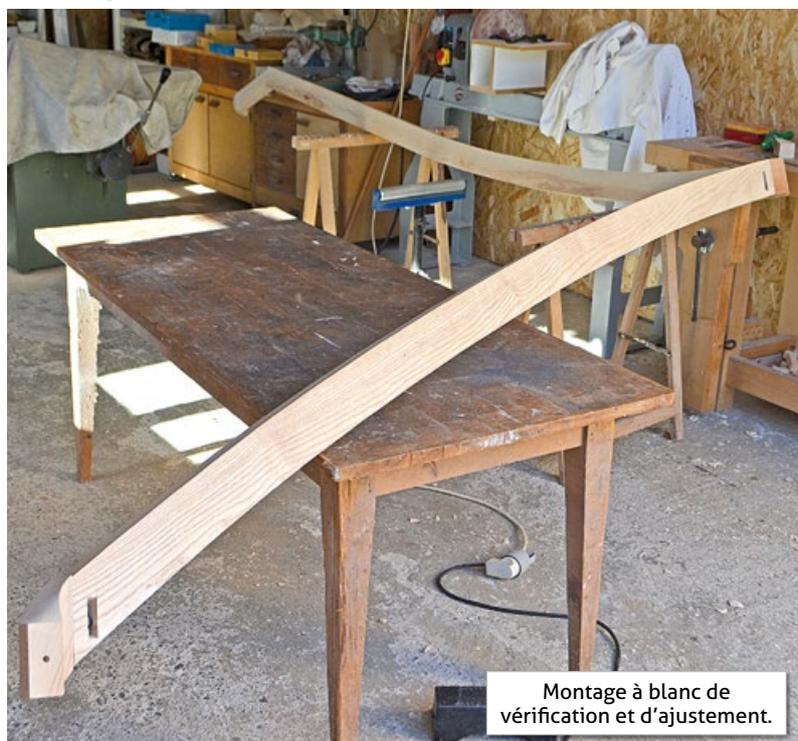
Montage à blanc de vérification et d'ajustement.
