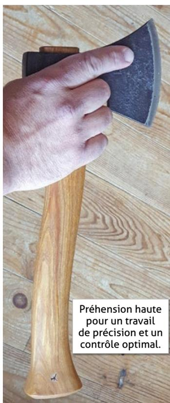
Préhension haute pour un travail de précision et un contrôle optimal.
