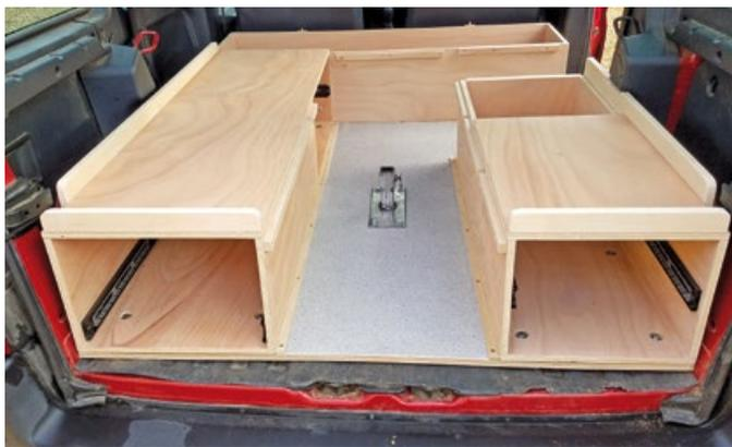
Le caisson gauche est composé de deux tiroirs tandis que celui de droite est composé d'un tiroir et d'un petit coffre en complément. Le caisson droit est plus court que le caisson gauche pour permettre un passage par la porte latérale (mon Berlingo ne dispose que d'une porte latérale).
