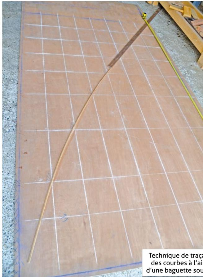
Technique de traçage des courbes à l'aide d'une baguette souple.
