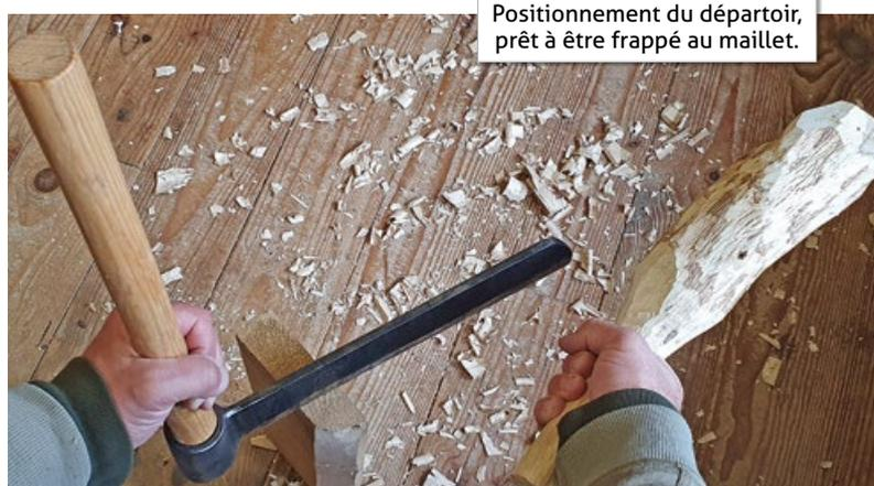
Avec les coups, la lame va se frayer un chemin entre les fibres et s'enfoncer dans le bois. Une fois que la lame a bien progressé dans la matière, le manche est utilisé pour faire levier et aider le bois à fendre. Il faut néanmoins conserver le contrôle de l'horizontalité de l'outil en frappant la lame à l'endroit adéquat au fur et à mesure des coups.
