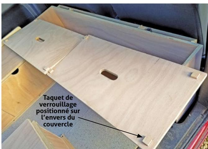
Taquet de verrouillage positionné sur l'envers du couvercle
