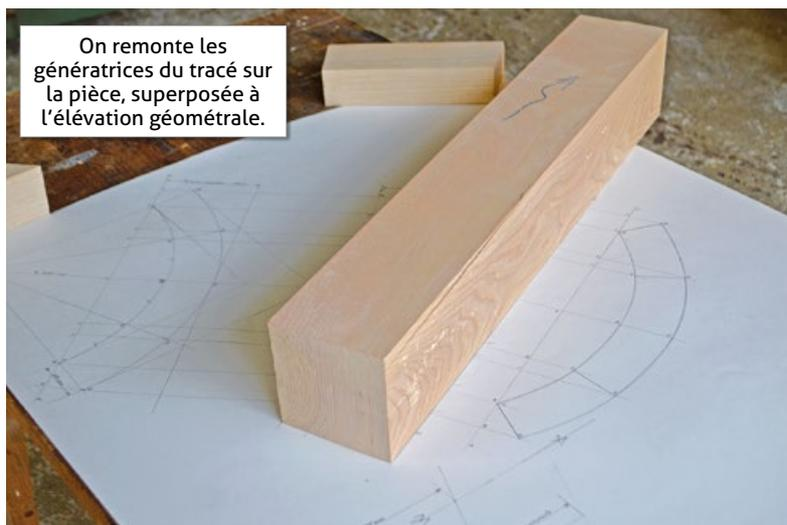
On remonte les génératrices du tracé sur la pièce, superposée à l'élévation géométrale.
