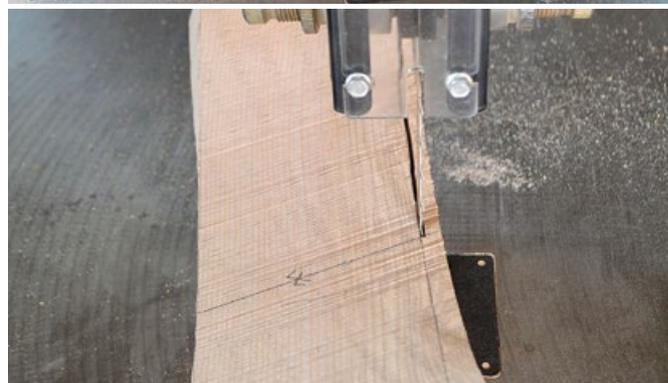
Pour que la coupe soit parfaite, la pièce doit être basculée en référence aux segments rayonnants du calibre rallongé tracés grâce au report des points : au fur et à mesure de l'avancement, chacun des segments doit venir s'aligner au droit de la denture de la lame.
