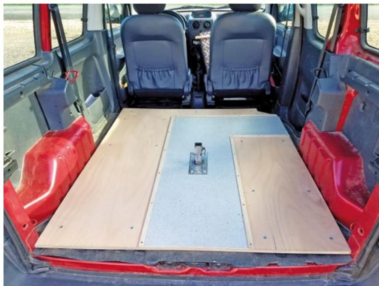
Ce plancher n'atteint pas les sièges avant. Il s'arrête au niveau du décrochement situé à l'aplomb de l'avant de la banquette arrière (retirée), en contrebas, qui sert habituellement de repose-pieds aux passagers.
