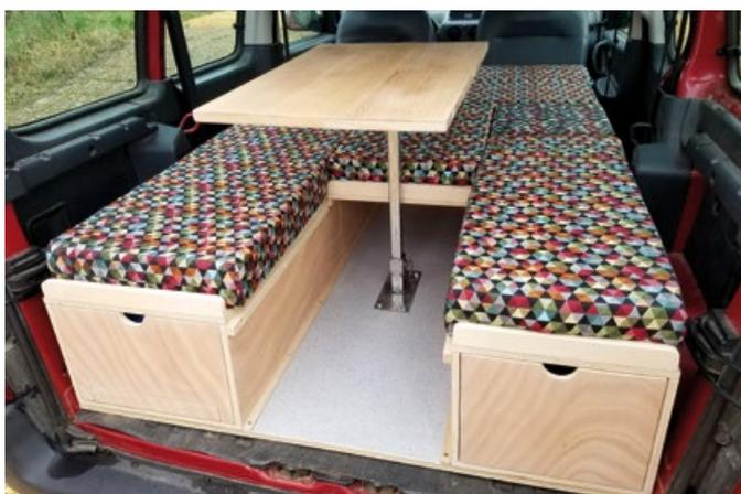
Il suffit alors de démonter le plateau de table et de le poser sur les tasseaux en l'inversant avec l'autre tablette de l'allée (qui a les mêmes dimensions mais qui possède un rebord pour empêcher le matelas de glisser vers l'arrière).
