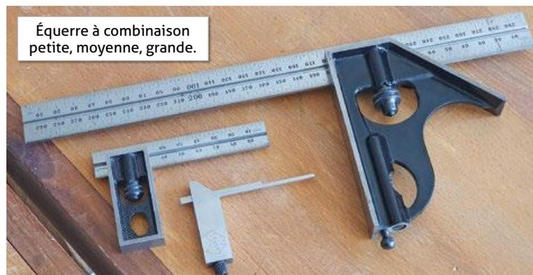
Cette caractéristique est intéressante à plus d'un titre : outre la fonction d'une équerre à talon classique, une équerre à combinaison permet de tracer des lignes perpendiculaires en fond de feuillures. Elle s'utilise également comme jauge pour vérifier la profondeur d'une mortaise, ou encore comme trusquin à tracer... Nous y reviendrons.
