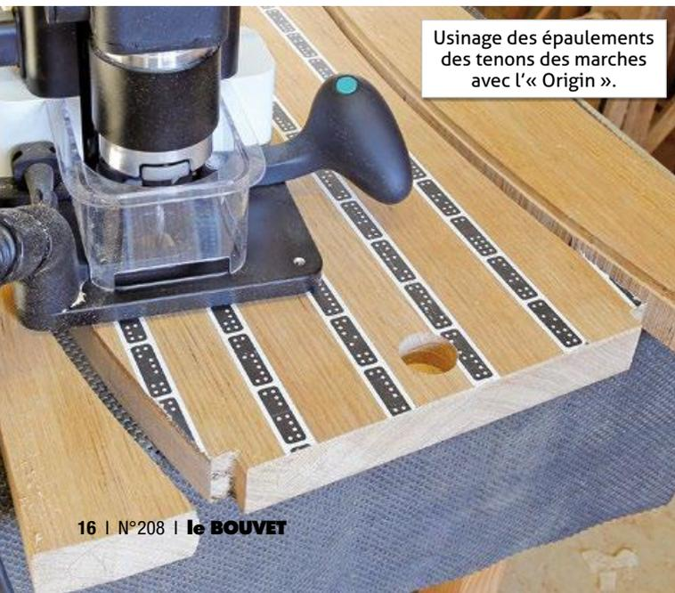
Usinage des épaulements des tenons des marches avec l'« Origin ».
