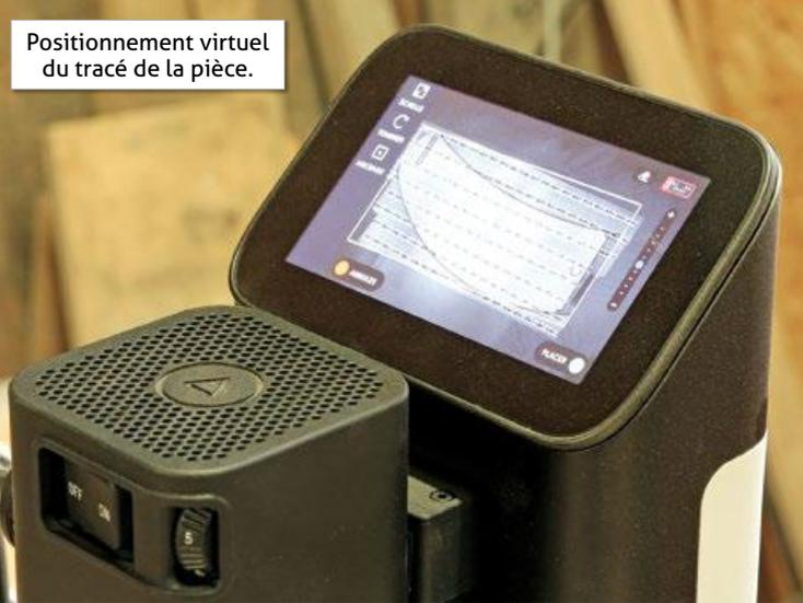
On peut même créer une grille ortho-normée qu'on peut orienter à notre convenance et dont on peut déterminer la précision (de quelques dixièmes à plusieurs dizaines de millimètres). Cela permet de mieux se repérer et de superposer différents fichiers d'usinage, au besoin.
