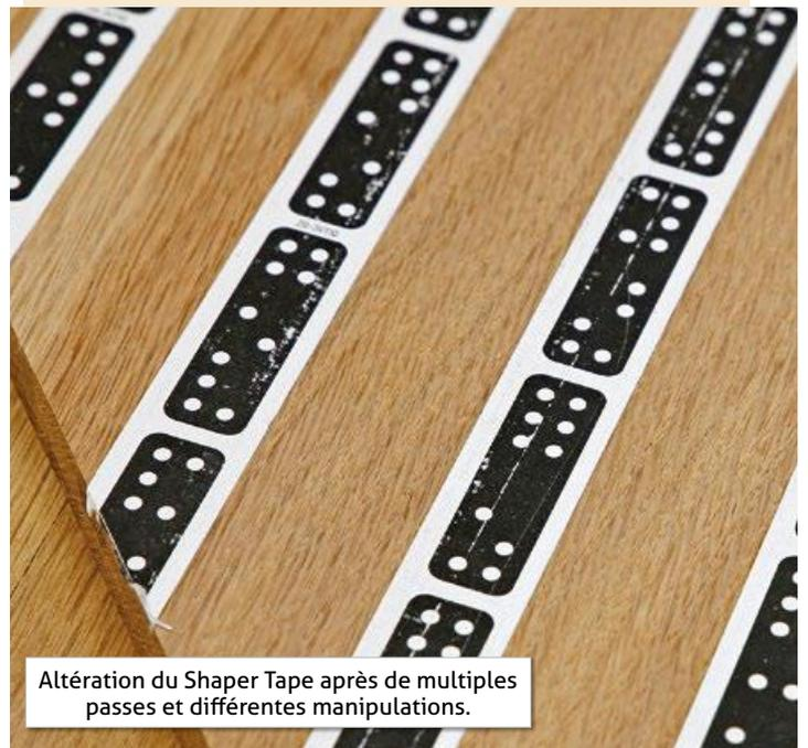
Altération du Shaper Tape après de multiples passes et différentes manipulations.
