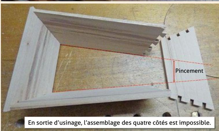
En sortie d'usinage, l'assemblage des quatre côtés est impossible.
