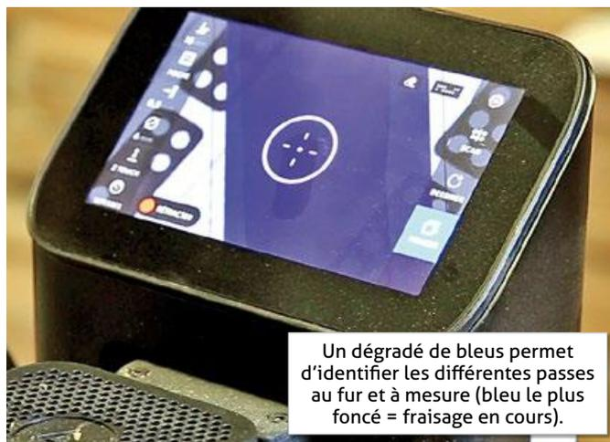
Un dégradé de bleus permet d'identifier les différentes passes au fur et à mesure (bleu le plus foncé = fraisage en cours).
