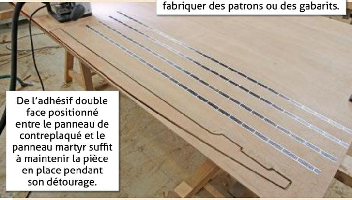
De l'adhésif double face positionné entre le panneau de contreplaqué et le panneau martyr suffit à maintenir la pièce en place pendant son détournage.
