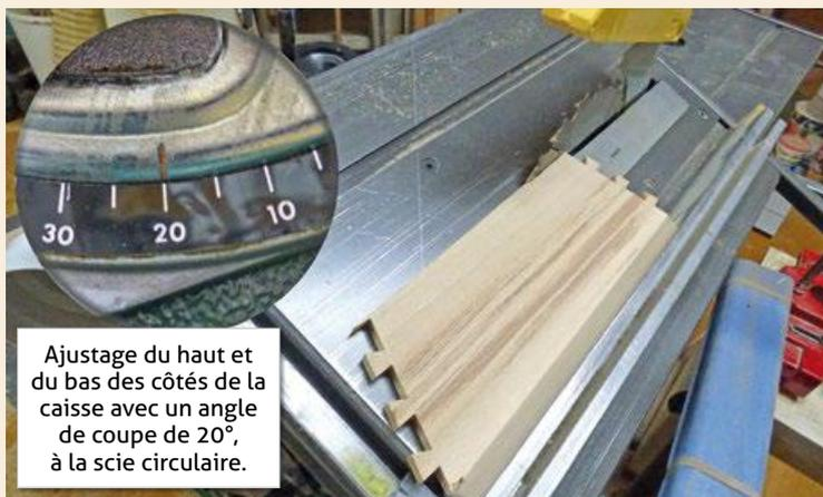
Ajustage du haut et du bas des côtés de la caisse avec un angle de coupe de 20°, à la scie circulaire.
