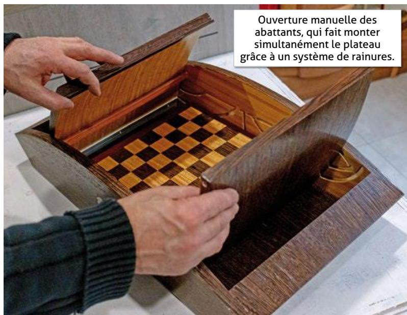
Ouverture manuelle des abattants, qui fait monter simultanément le plateau grâce à un système de rainures.
