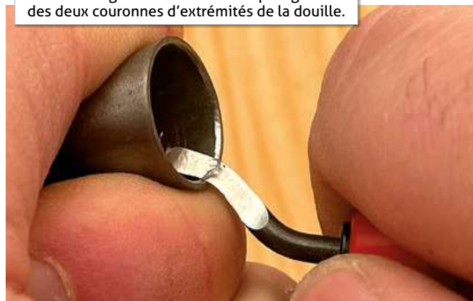
Chanfreinage de l'intérieur de la plus grande des deux couronnes d'extrémités de la douille.
