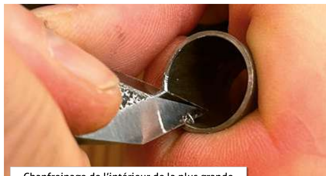
Chanfreinage de l'intérieur de la plus grande des deux couronnes d'extrémités de la douille.
