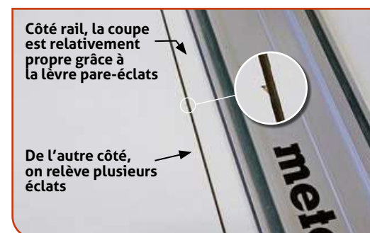
Analyse d'une coupe démontrant l'efficacité de la lèvre en tant que pare-éclats.
