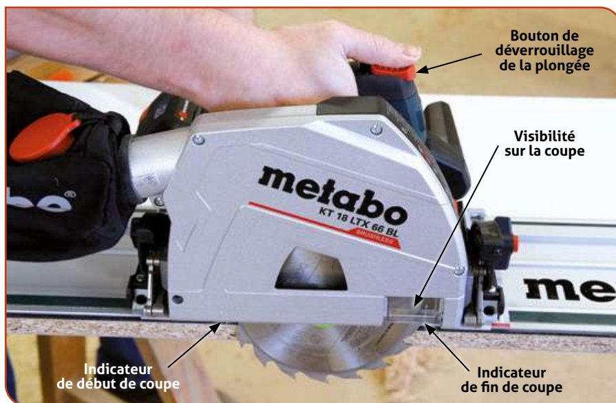
Indicateurs de début et de fin de coupe et fenêtre de vue sur la coupe.
