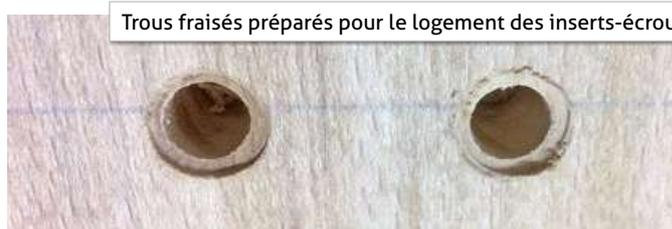
Trous fraisés préparés pour le logement des inserts-écrous.
