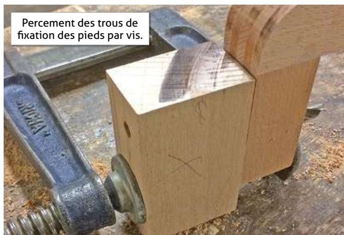
Percement des trous de fixation des pieds par vis.
