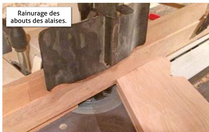
Il y a deux rainures par about d'aise et l'usinage se fait « à la retourne ».
