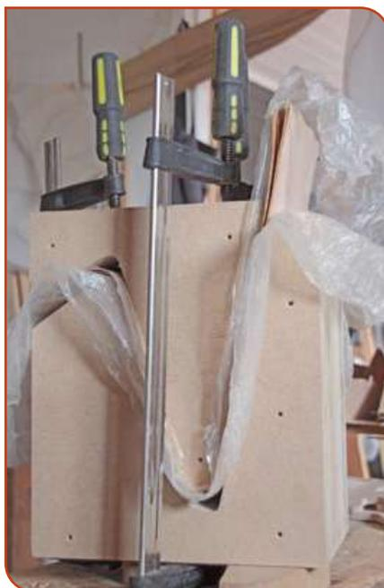
*Les serre-joints permettent une mise sous presse progressive.*
