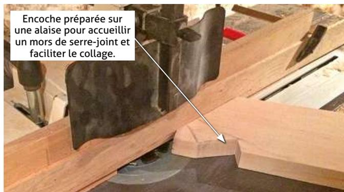
Un dernier montage à blanc, avant de coller, assure que toutes les pièces se positionnent correctement, sans bâillement.
