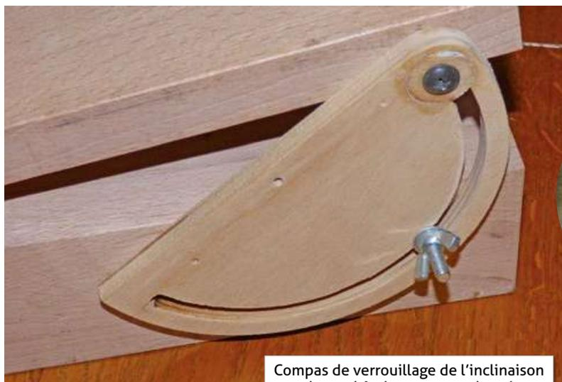
Compas de verrouillage de l'inclinaison du surchâssis, en contreplaqué
