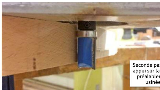
Seconde passe, en appui sur la partie préalablement usinée.
