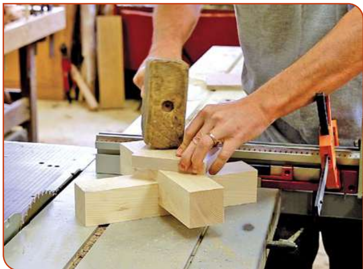
L'assemblage est parfaitement ajusté et nécessite l'utilisation d'un maillet pour l'emboîtement des pièces.
