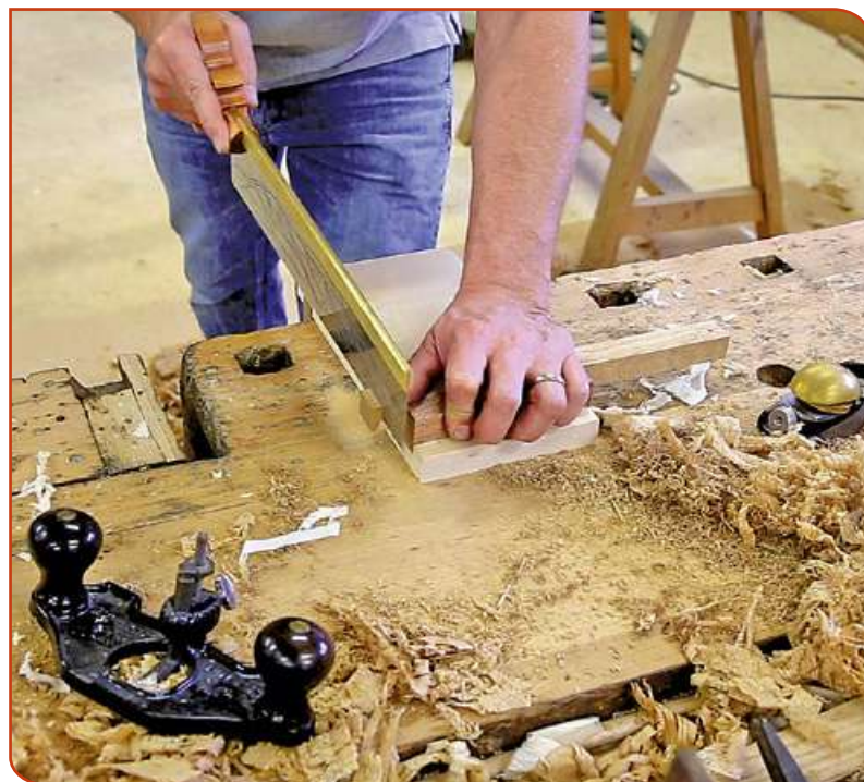
Mise en œuvre immédiate de ma planche de sciage.
