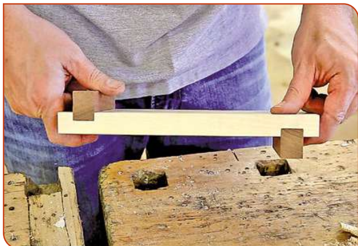
Les deux tasseaux (butées) s'encastrent parfaitement dans les rainures, en force.
