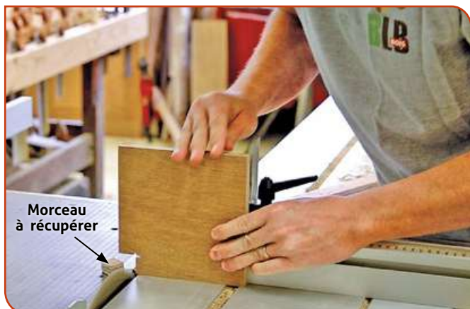
On pratique deux traits de scie perpendiculaires de façon à décrocher un angle et le récupérer.
