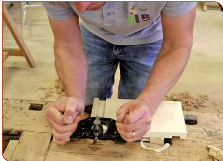
Je nettoie le fond de mes entailles à l'aide d'une guimbarde.
