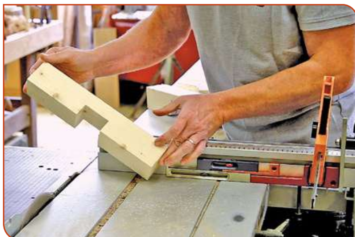
Une entaille à mi-bois est ainsi usinée dans chacune des deux pièces.
