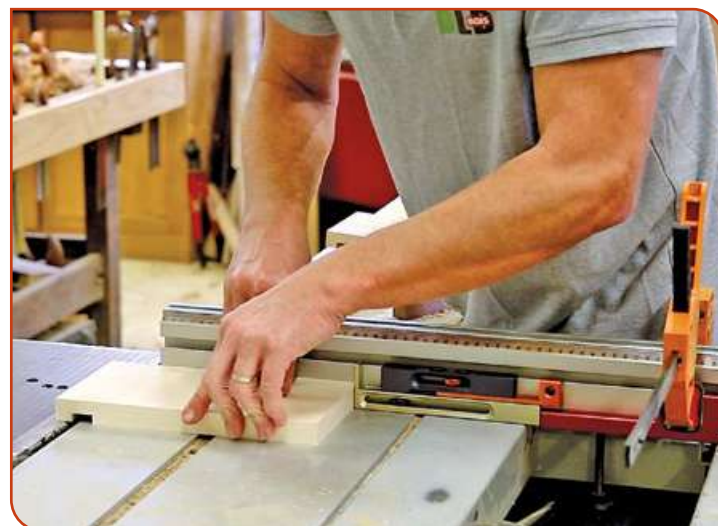
J'usine les rainures selon le même processus que celui utilisé pour les entailles à mi-bois.
