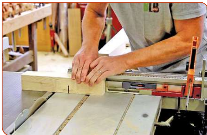
Deuxième trait de scie pour délimiter l'entaille.
