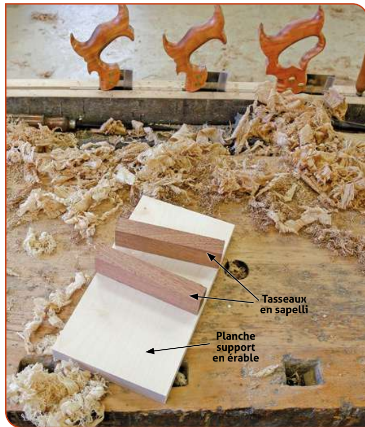
Pour fabriquer ma planche de sciage, il faut que j'encastre deux tasseaux de quelques millimètres dans une planche support.
