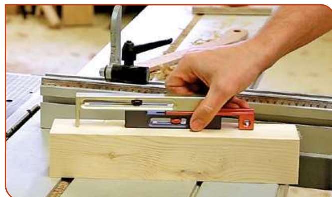
Le kerfmaker réglé après prise en compte de l'épaisseur de la pièce et du trait de scie.
