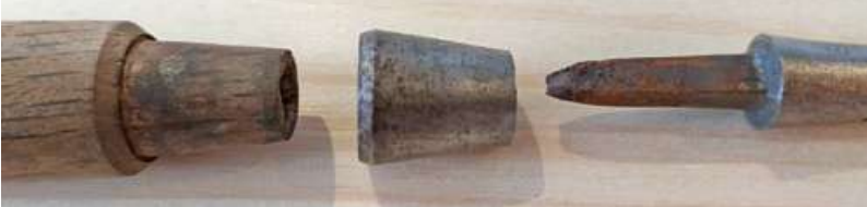
Montage du manche d'un ciseau japonais avec douille et soie combinées.
