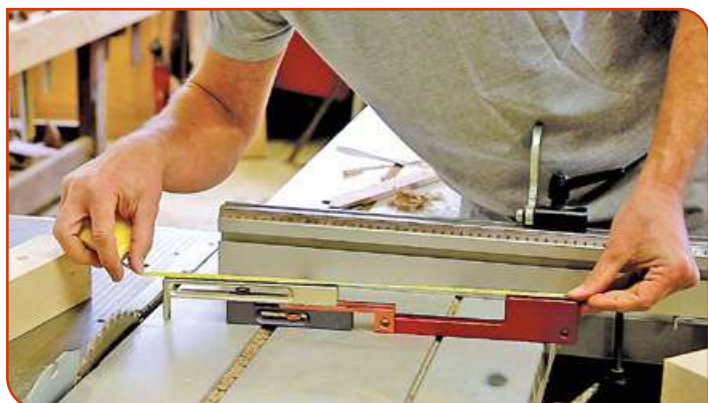
Prise de mesure pour effectuer le réglage de la butée du guide du chariot de la scie circulaire stationnaire.
