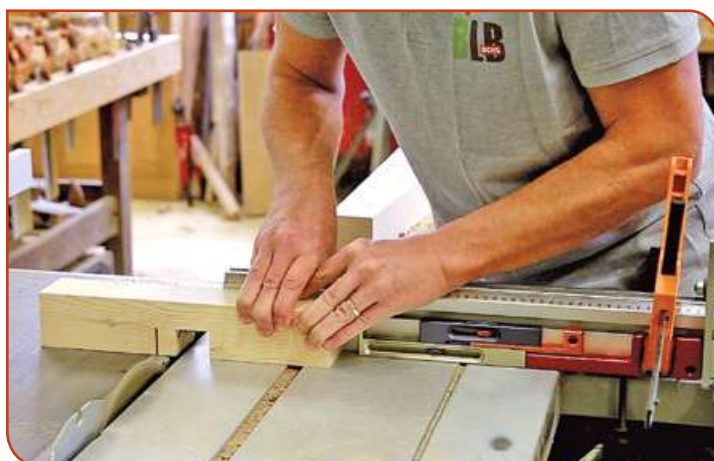
Évidement du reste de la matière à éliminer pour créer l'entaille.
