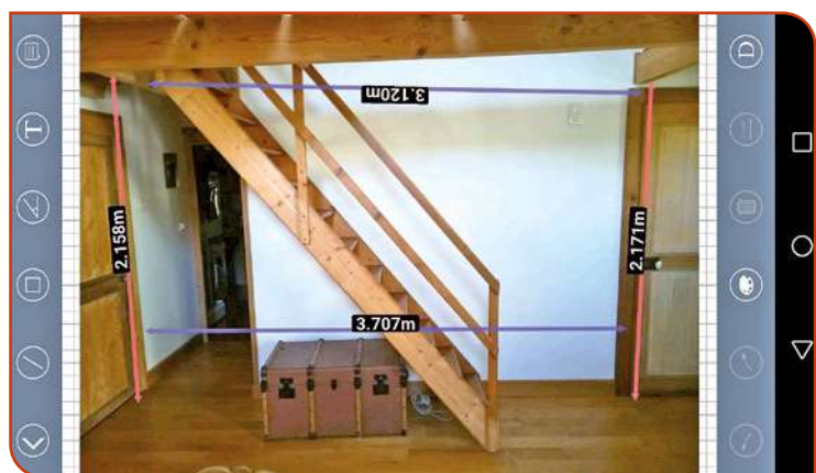
Exemple de prise de mesures pour le remplacement d'un escalier vu de côté...
