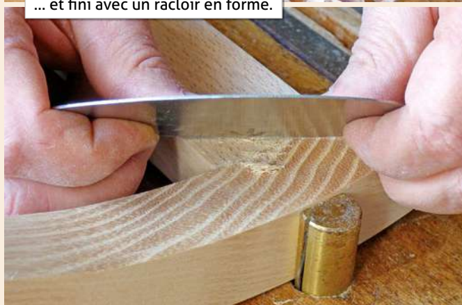
... et fini avec un racloir en forme.
