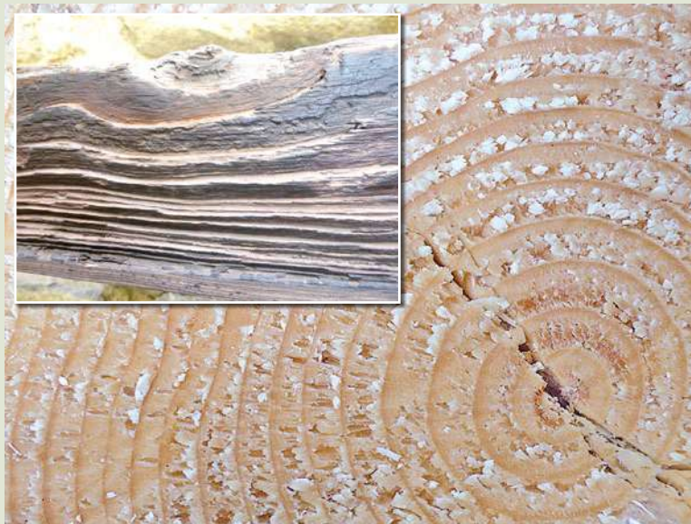
Coupe transversale (en bout) d'un épicéa. On distingue nettement la différence de structure, de densité entre bois de printemps et d'été.
