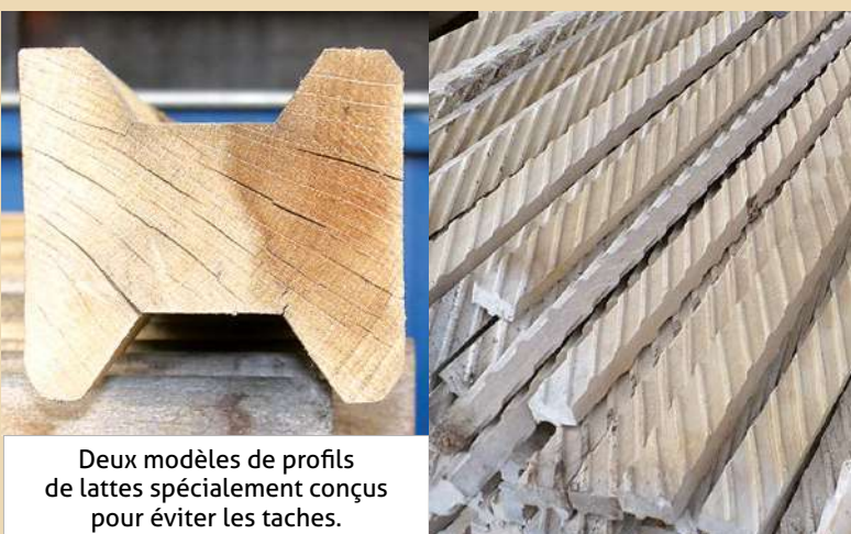
Empilement avec des lattes en plastique profilé.
