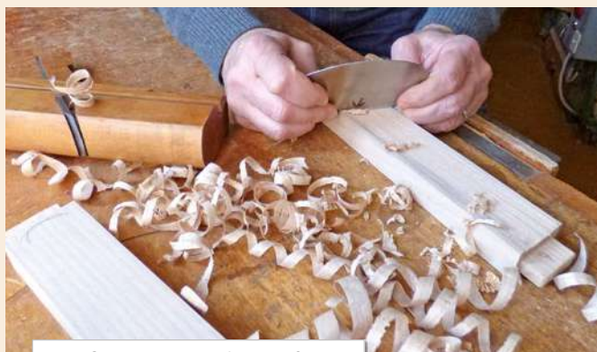
... et fini avec un racloir en forme.
