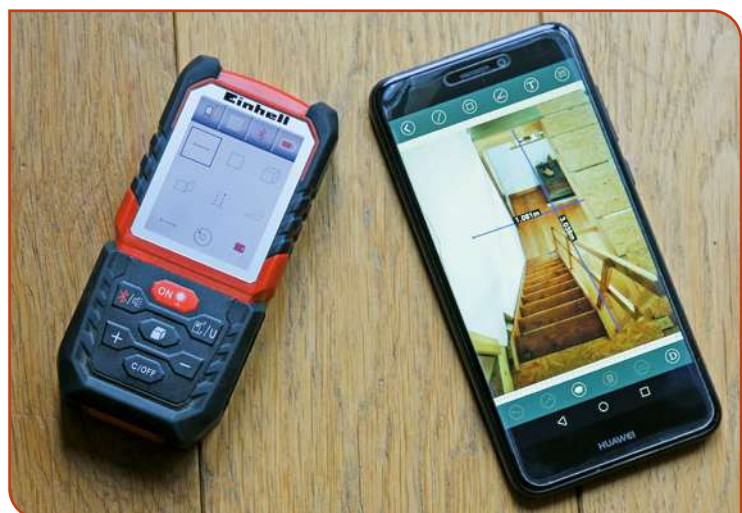
Les cotes prises avec le télémètre sont directement intégrables sur des photos de situation
