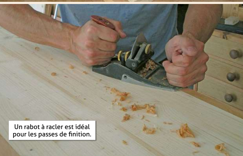
Affleurage des alaises recouvrant les chants du 3-plis
