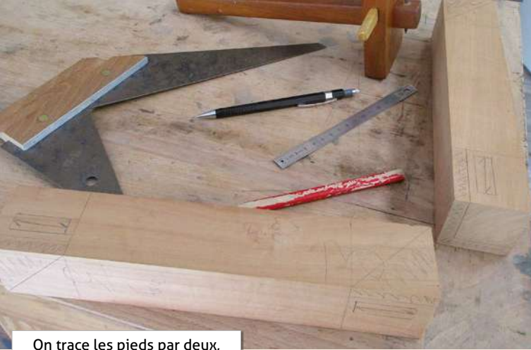
On trace les pieds par deux, dos à dos, sur une même pièce.
