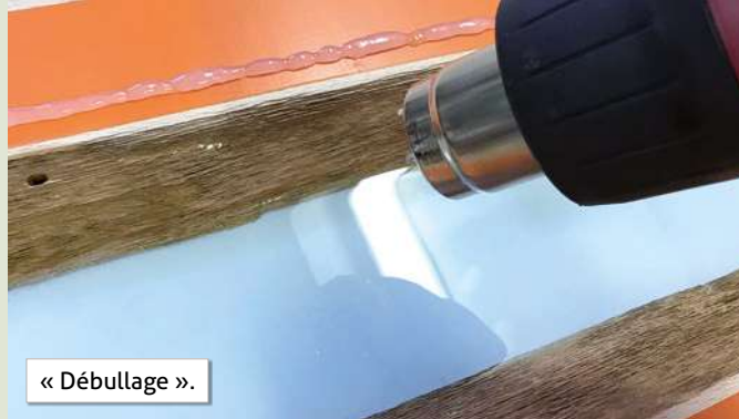
État de surface, parfaitement lisse, après « débullage ».
