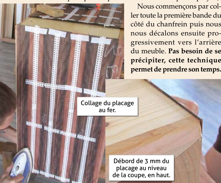
Avant de coller le placage du dessus, on encolle le chant du placage fraîchement posé.
