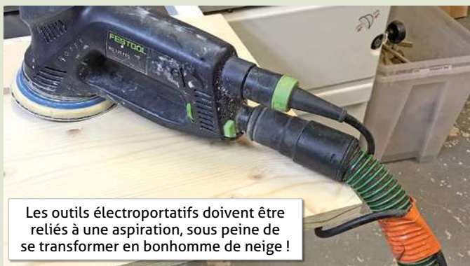
Copeaux de résine collés sur le tuyau de l'aspirateur à cause de leurs propriétés électrostatiques.
