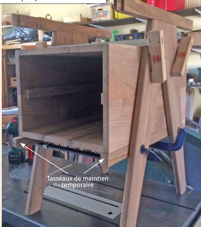
Montage et fixation du caisson entre les compas qui lui sont attenants.
