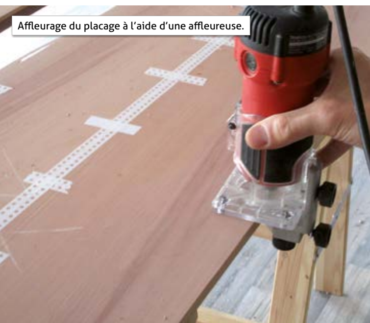
Principe de fonctionnement d'une affleureuse.
