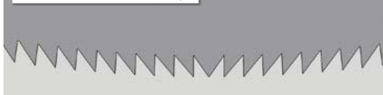
Forme d'une lame de scie à placage.
