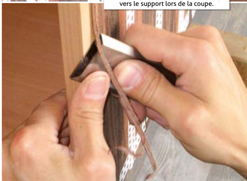
On s'arrange pour repousser le placage vers le support lors de la coupe.
