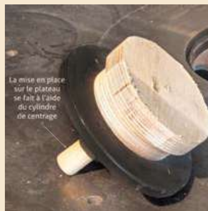
Ébauche et contre-cale fixées sur le plateau du tour
