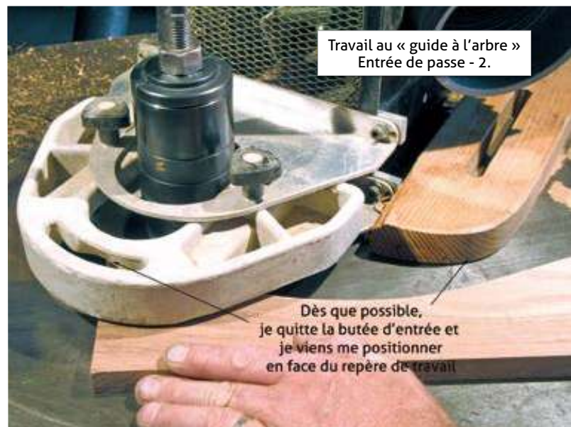
Travail au « guide à l'arbre » Mise en place de la butée d'entrée.
