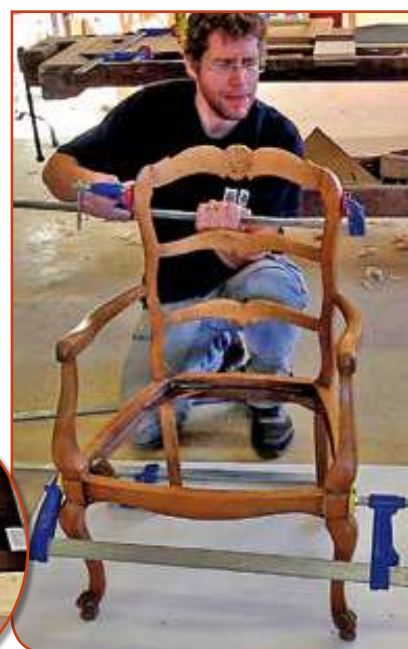
Après collage, il ne reste plus qu'à éliminer les surplus de colle au cutter.
