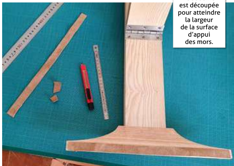
La suédine, comme très souvent dans le cas de collages de matériaux non homogènes, est collée à l'aide de colle époxy.
