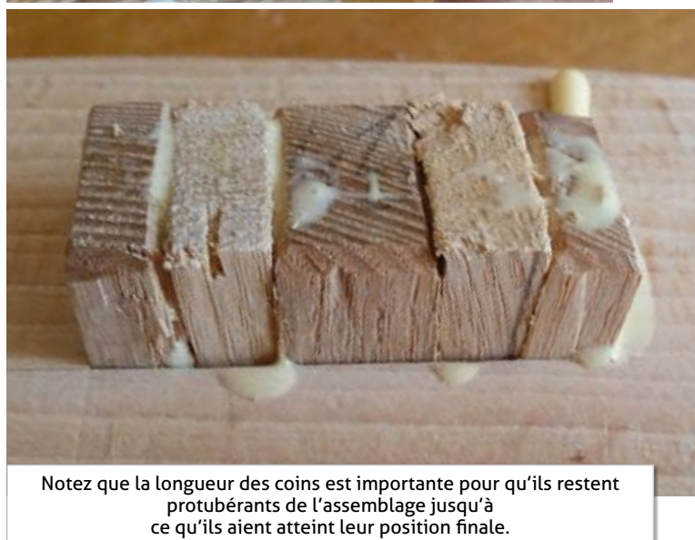
Les coins sont enfoncés alternativement, de manière progressive et équilibrée dans les deux fentes. Ceci permet de garantir une bonne répartition des pressions sur les interfaces de l'assemblage.
