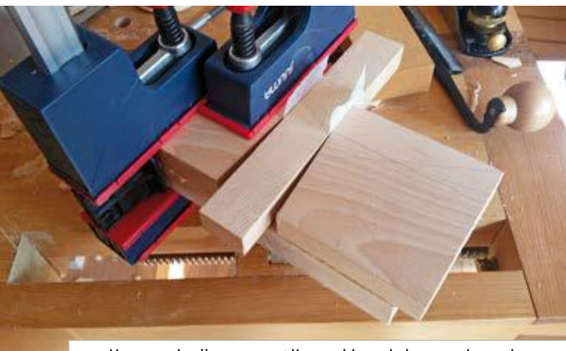
Un second collage permet l'assemblage de la seconde partie. Un tasseau dont la largeur correspond à la largeur du tenon est utilisé pour espacer les deux parties du pli central
