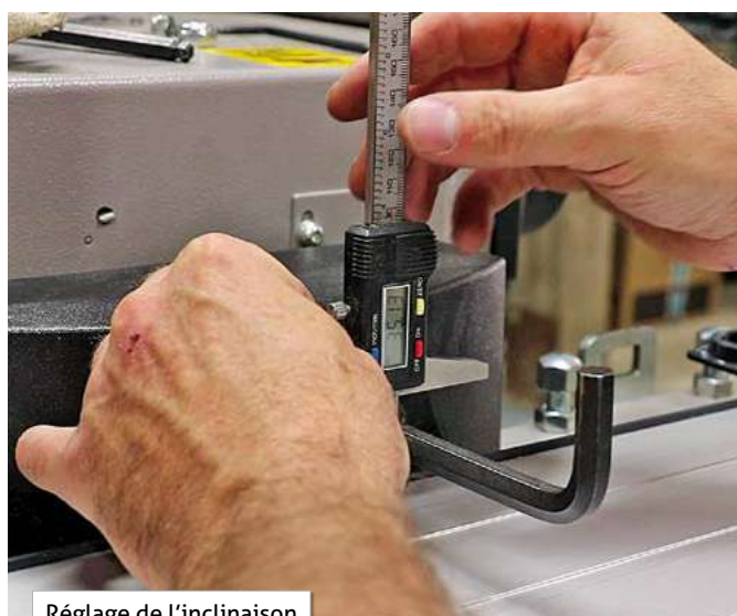
Réglage de l'inclinaison du chariot
