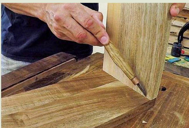
7 On marque les lignes d'arasement selon le profil des côtés
