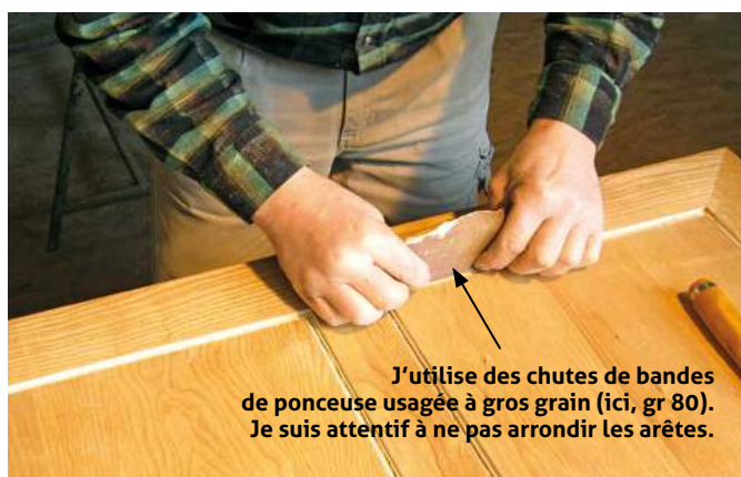
17 Nettoyage des rainures
