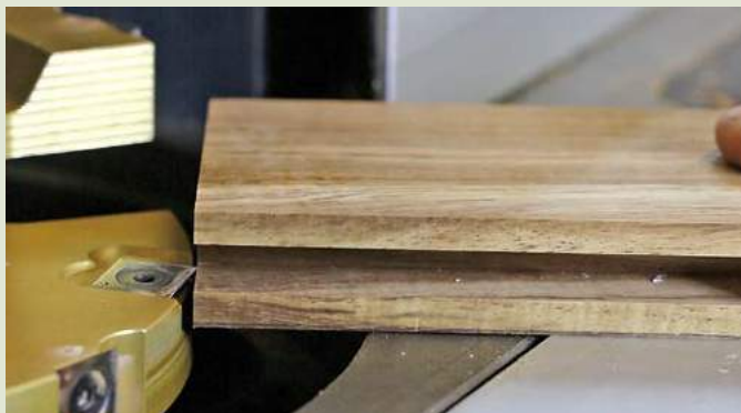
33 Les tenons inclinés sont réalisés en appui contre un martyr triangulaire
