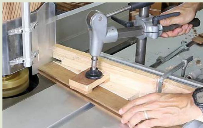
33 Les tenons inclinés sont réalisés en appui contre un martyr triangulaire
