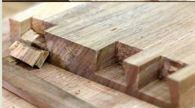
18 Pour le nettoyage des inter-queues, j'utilise une baguette de l'épaisseur du recouvrement
