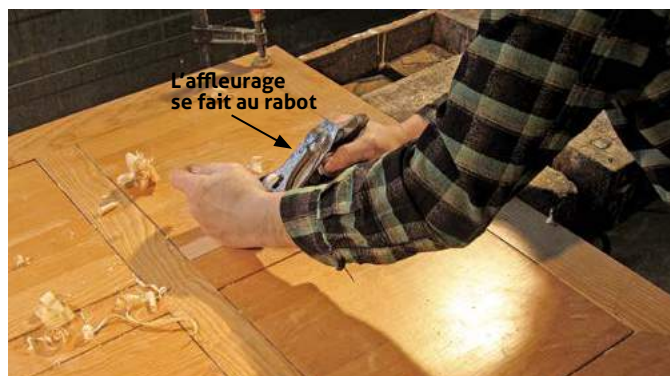
9 Réparation d'un panneau : éliminer une gerce et réduire le joint périphérique. Phase 4 : affleurage de la pièce
