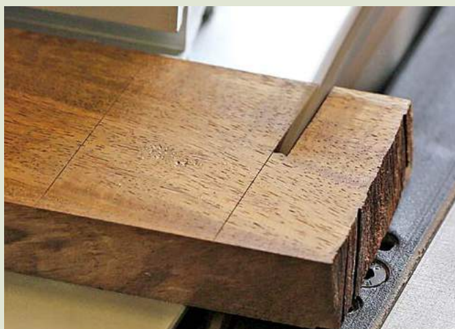
30 Mise à dimension des pièces selon les reports effectués d'après l'épure
