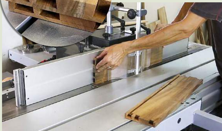
23 La rainure doit déboucher dans les queues d'aronde basses
