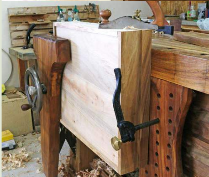
28 J'ajuste les dimensions de mes tiroirs au rabot
