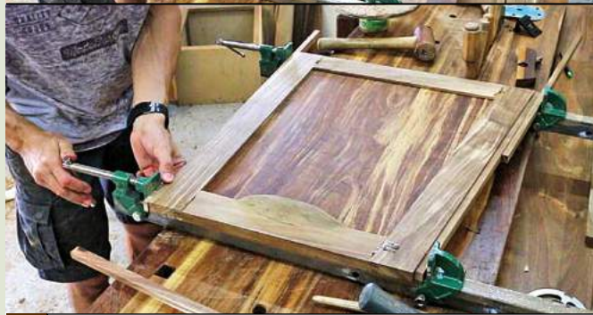
38 Collage de la porte, après la finition du panneau
