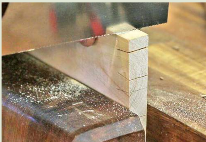
12 Découpe des épaulements en plaçant le côté à l'horizontale dans la presse
