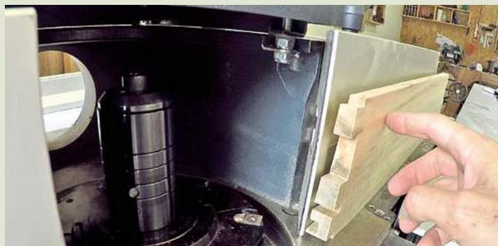
24 L'usinage de la rainure des côtés nécessite soit d'avoir un arbre de toupie inclinable, soit de réaliser une petite adaptation
