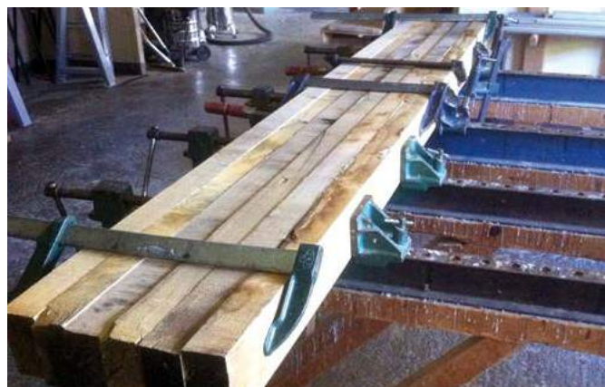
14 Les poteaux sont deux pièces assemblées par collage
