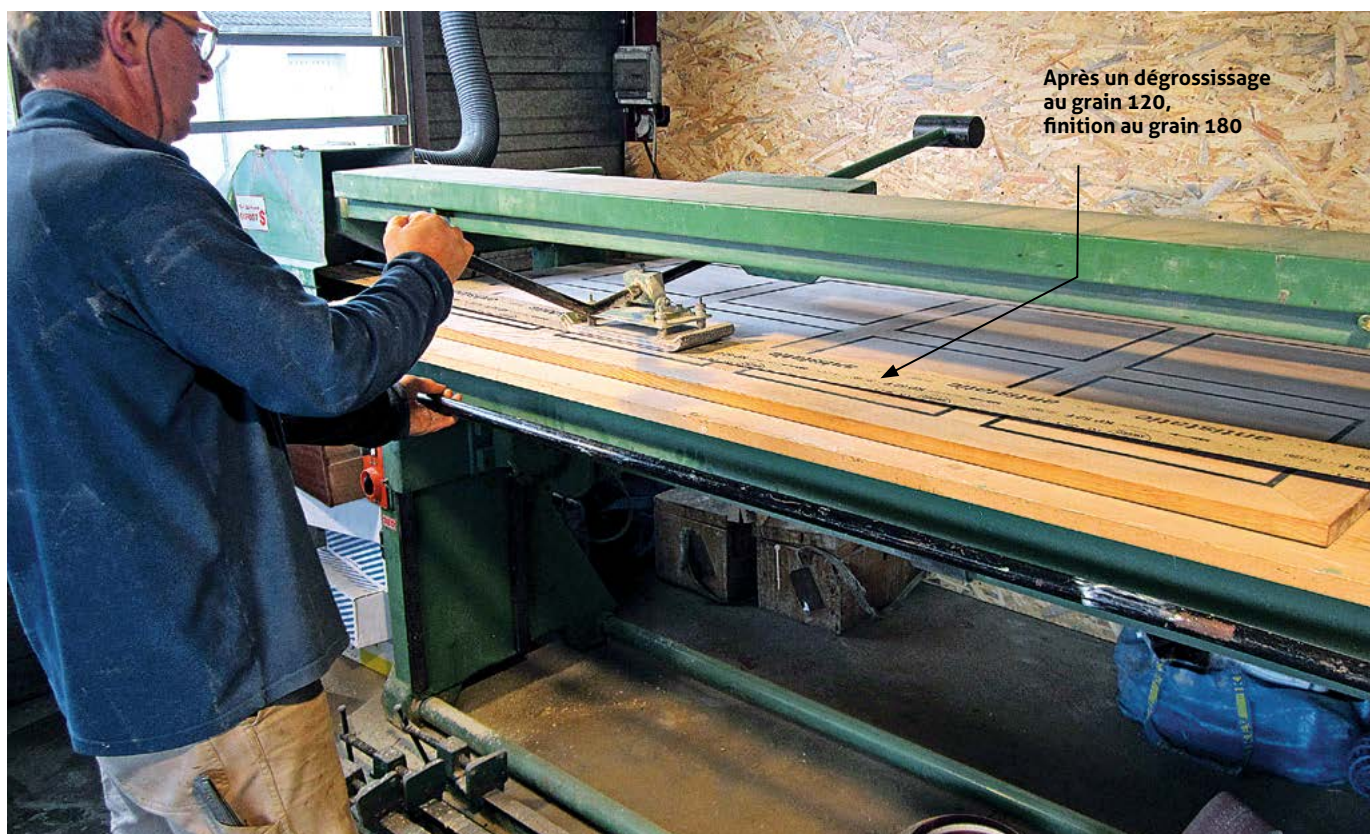
22 Ponçage des joints à la ponceuse longue bande
