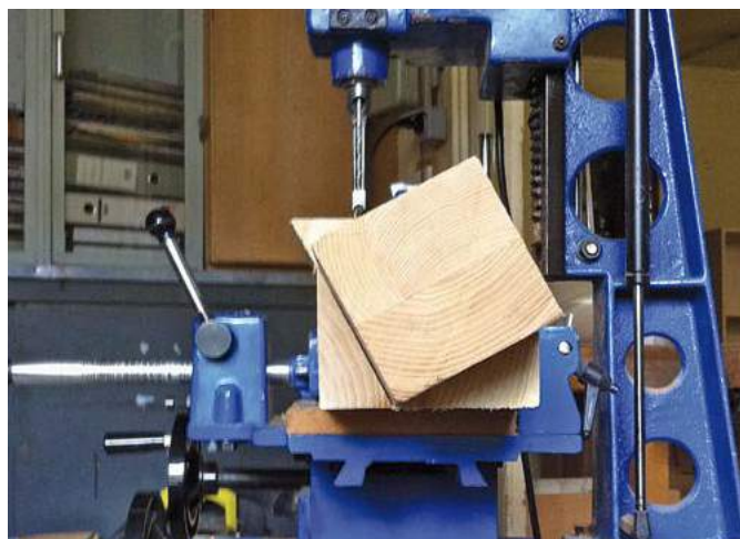
20 Les poteaux avant sont calés pour être mortaisés
