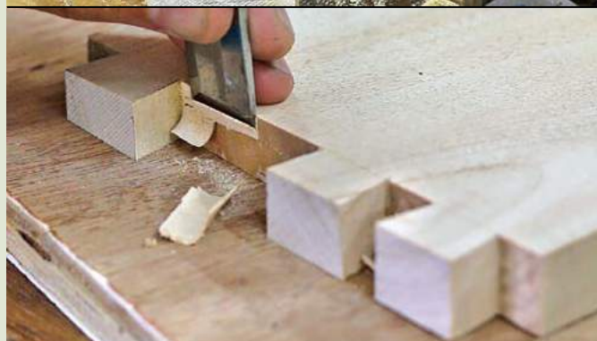
14 Nettoyage des inter-queues au ciseau, pièce tenue à plat par un valet
