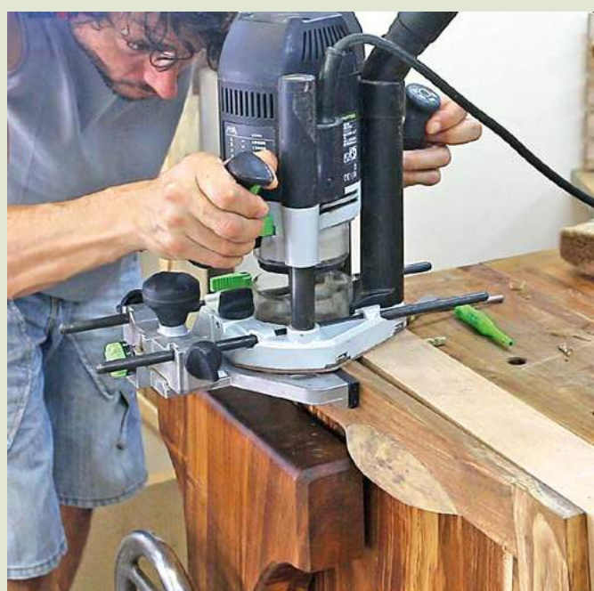
42 Il faut stabiliser la défonceuse pour travailler sur le chant
