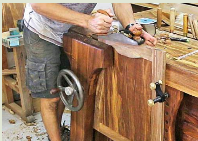
40 Les derniers ajustements se font au rabot
