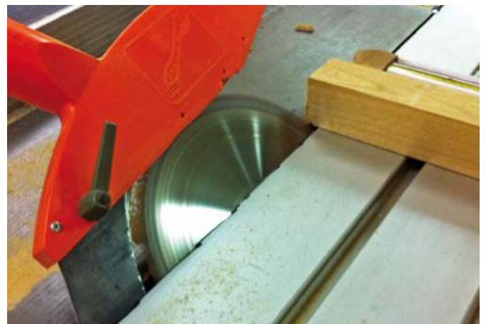
26 Usinage des têtes de poteau
