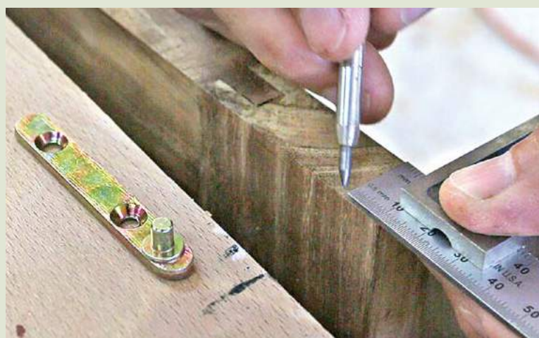
41 Traçage de l'emplacement des pivots
