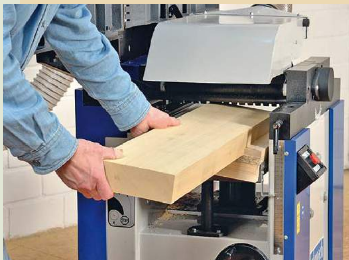
A Un montage fixe, qui permet de raboter des pièces inclinées
