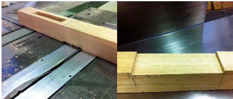
22 Usinage d'une encoche de positionnement pour le poteau à l'extrémité de la rampe, en haut
