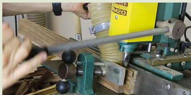
35 C'est seulement une fois toutes ces opérations terminées que j'usine mes mortaises
