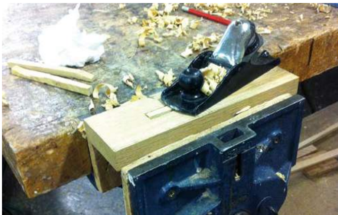
27 Réalisation des chevilles avec une boîte à chevilles « maison »
