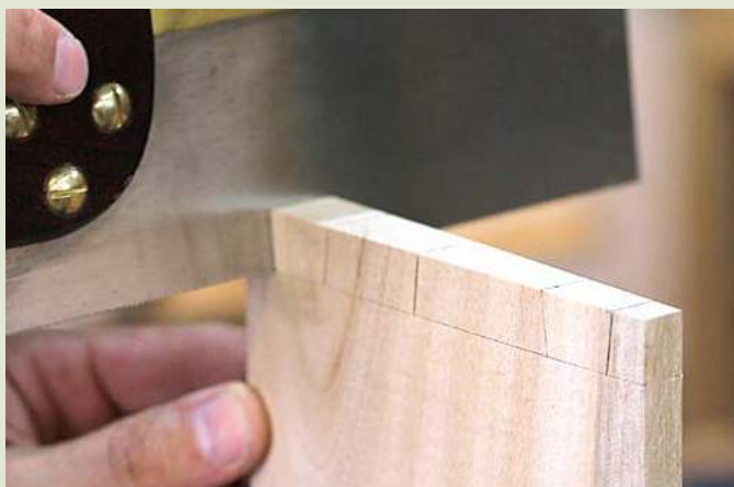
11 Sciez bien perpendiculairement à la face extérieure des côtés
