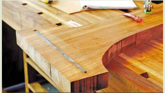
14 La partie « mors » de ma mâchoire mobile est armée d'une barre métallique
