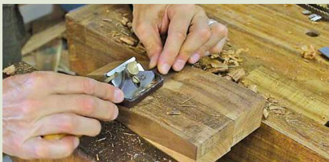
33 Reprise de l'état de surface de la courbe des pieds, simultanément, au Wastringue.
