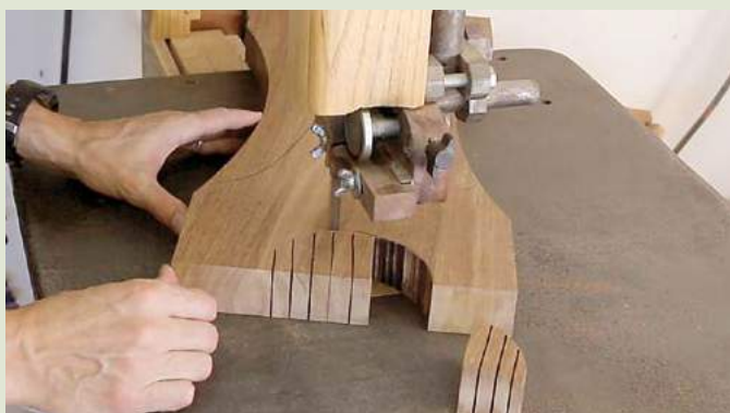
29 Chantournage à la scie à ruban
