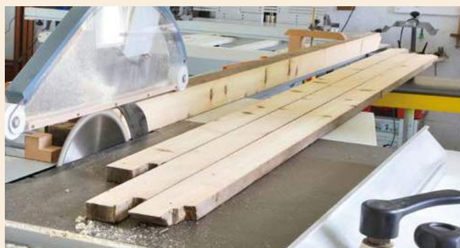
9 Ces pièces seront utilisées brutes de sciage, sans aucun corroyage
