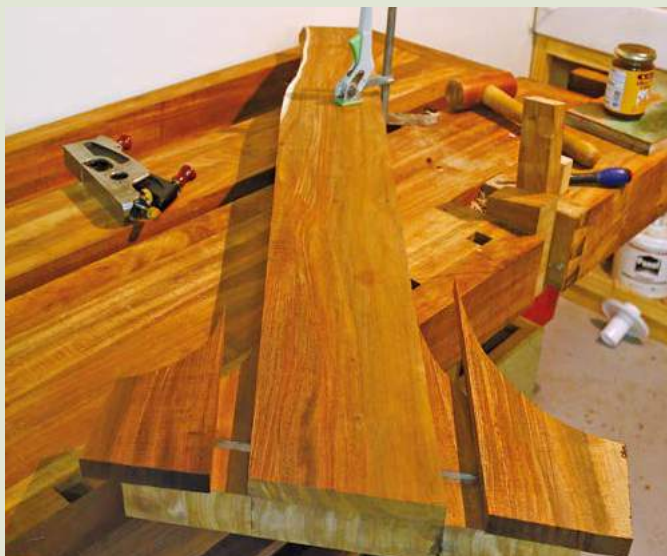
13 La mâchoire de la presse est constituée de deux épaisseurs de bois
