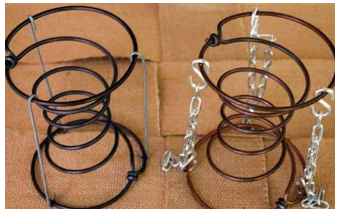
Différents systèmes de maintien de la compression des ressorts durant l'opération de guindage
