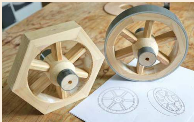
32 Moyeux, rayons et jantes sont assemblés avant le détournage extérieur de la jante
