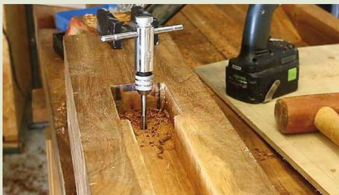
23 Taraudage des trous de fixation du Crisscross
