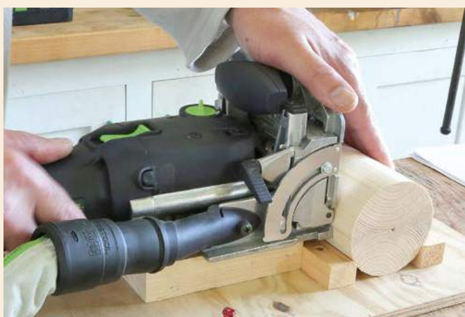
28 Un montage d'usinage me permet de fraiser les mortaises des moyeux...
