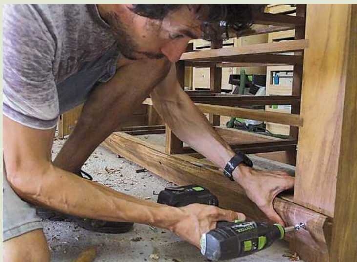
42 Fixation du rail de coulissement bas de la servante
