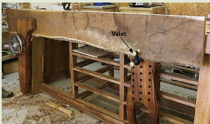
26 L'utilisation d'une servante mobile, associée à la presse, apporte un confort de travail indéniable
