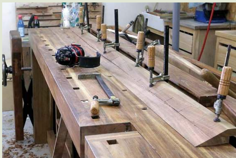
41 Une fois la règle centrale ôtée, je peux glisser mes serre-joints dans l'espace libéré et me servir de mon établi comme surface de référence pour mon collage
