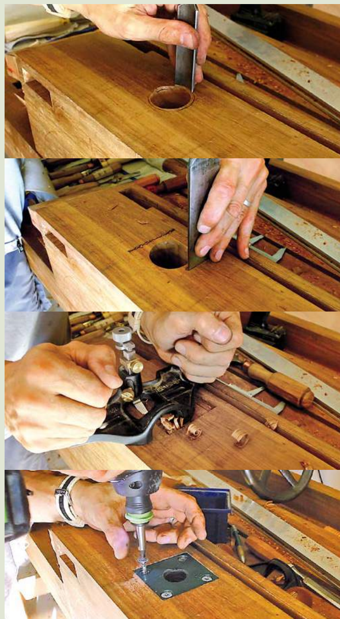
19 Aménagement du logement de l'écrou
