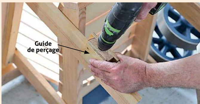
45 J'utilise un guide de fortune pour percer à la perceuse à main
