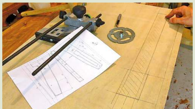
16 Tracé du gabarit : contour décalé de 1,5 mm
