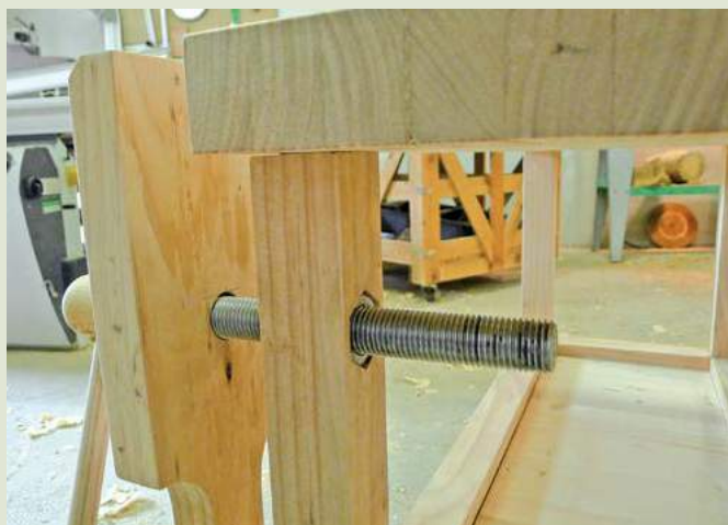
5 Une presse économique, dont la vis de serrage est une simple tige filetée
