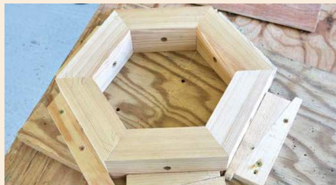
23 Tout commence par la fabrication d'un cadre, sous la forme d'un hexagone
