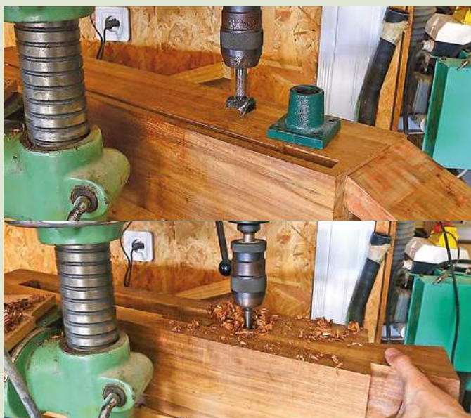
18 Perçage du conduit de la vis au travers du pied
