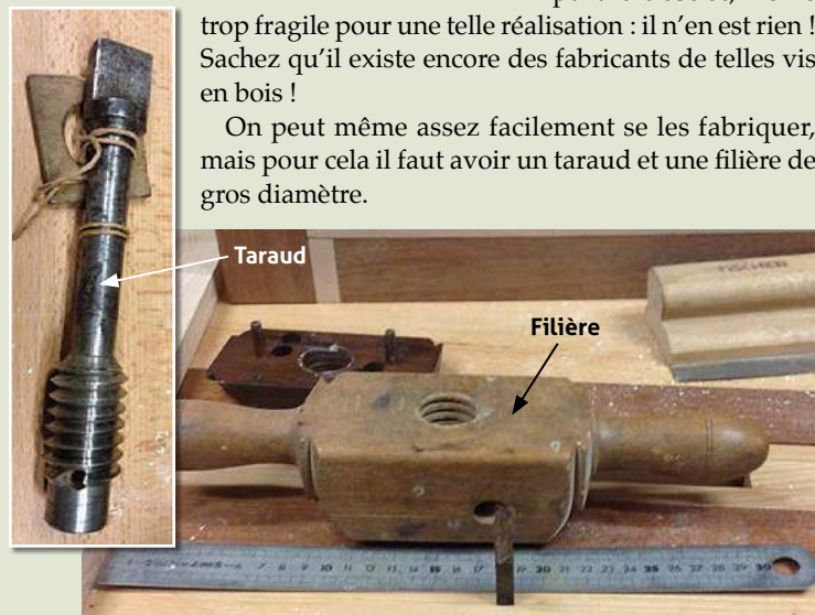
4 Les outils pour se fabriquer un système avec une vis en bois : taraud et filière
