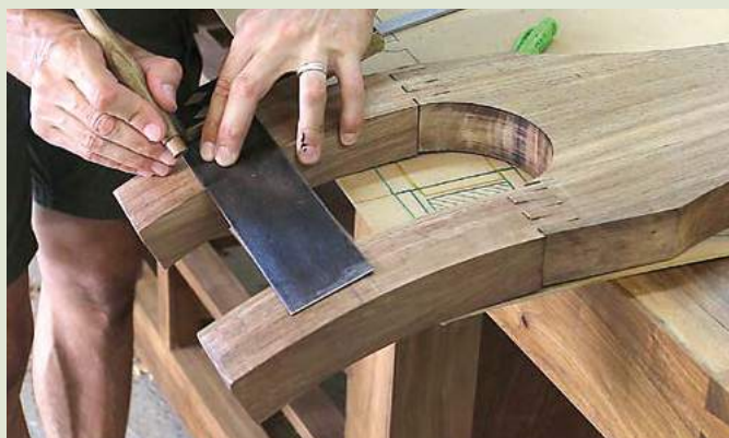
36 Traçage des arasements des tenons à encastrier dans le patin du bas
