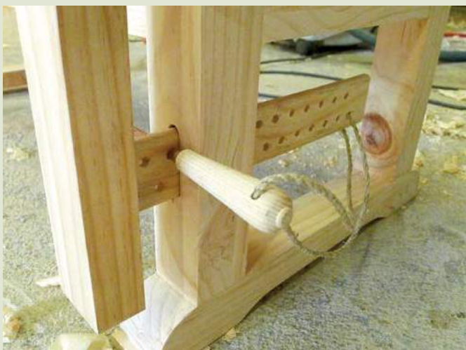
6 Principe le plus courant employé pour l'équilibrage et le guidage de la position de la mâchoire mobile
