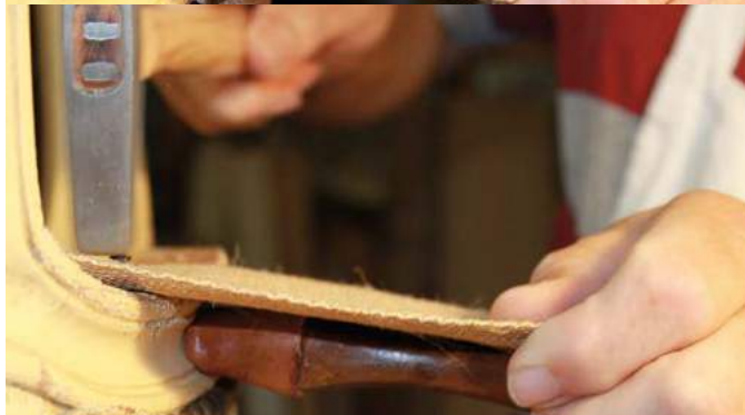
8 Manipulation du tire-sangles pour tendre une sangle et la pointer
