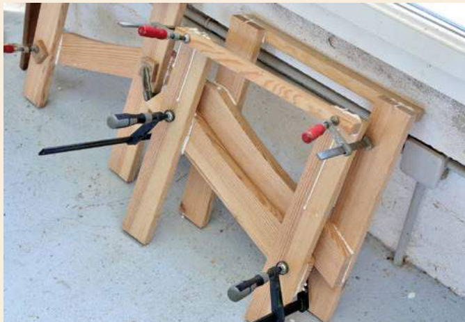
39 On commence par monter les fauteuils en sous-éléments...
