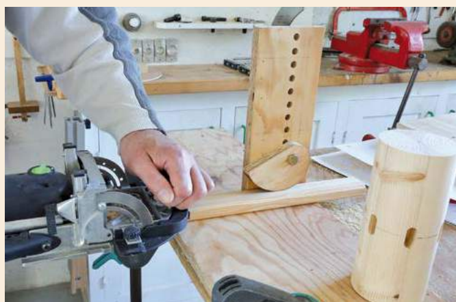
30 Un autre montage d'usinage permet de fraiser les rayons en bout
