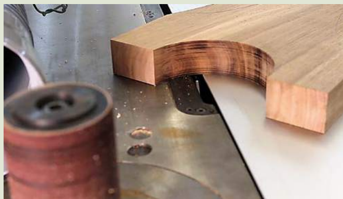
31 ... et au rouleau ponçeur : gare aux traces de brûlures !
