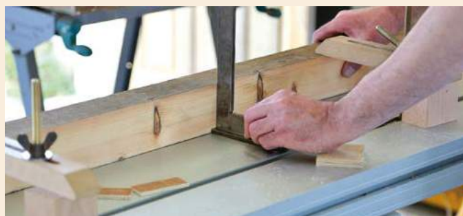
6 La première face créée doit être calée perpendiculairement au chariot
