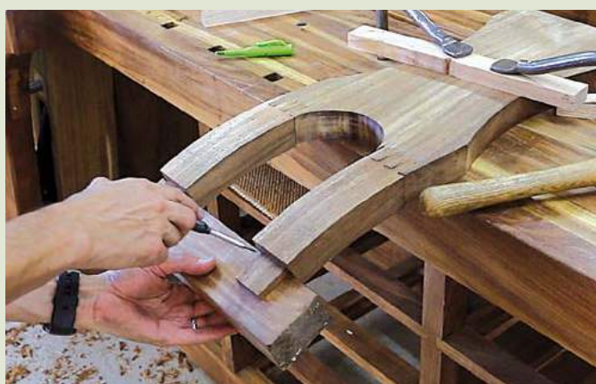
38 Repérage de l'emplacement des mortaises sur le patin
