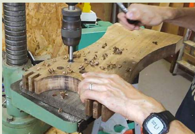
40 Perçage du réseau de trous amenés à recevoir taquets ou valets
