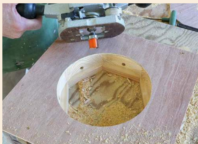
26 Le détourage du contour intérieur se fait au gabarit, en deux temps
