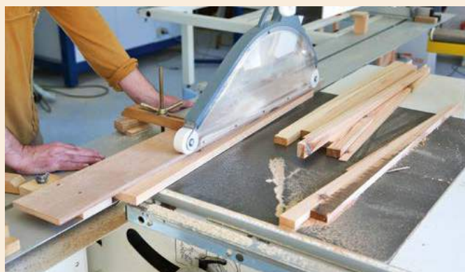
10 Voici un un dispositif simple pour faire des découpes au tracé
