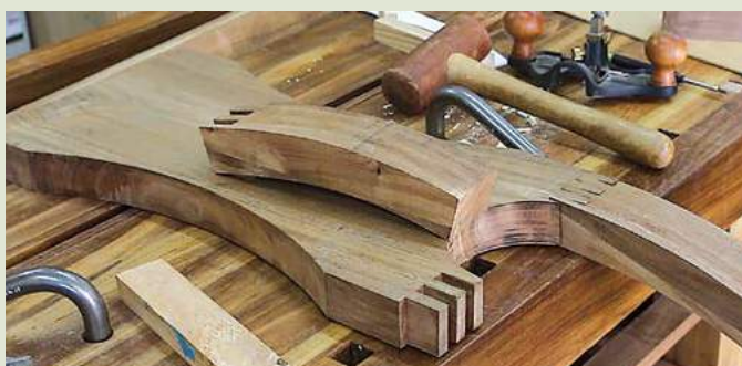
34 Des assemblages à enfourchements multiples pour assembler corps et pieds
