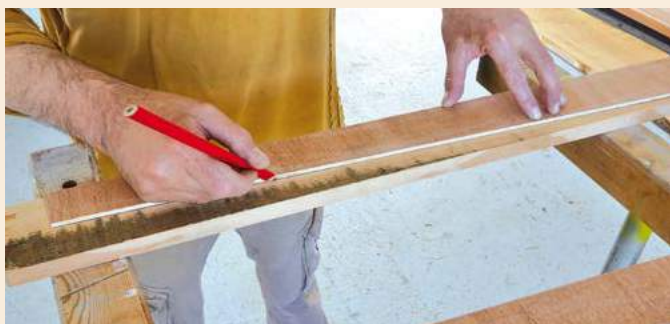
17 Certains gabarits me servent aussi à tracer le contour de mes pièces...
