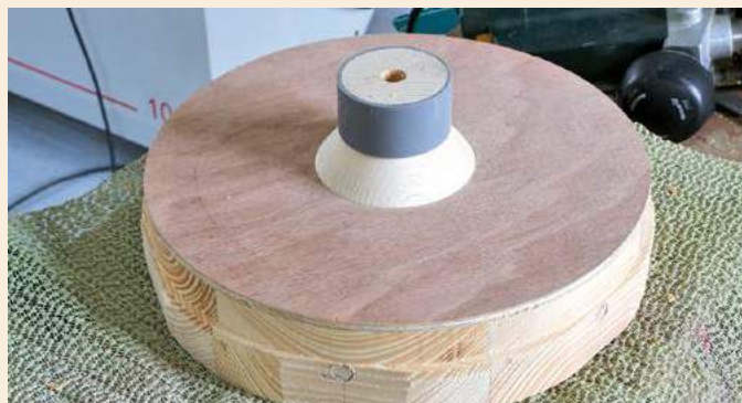
33 Détourage extérieur de la jante au gabarit, positionné par rapport au moyeu
