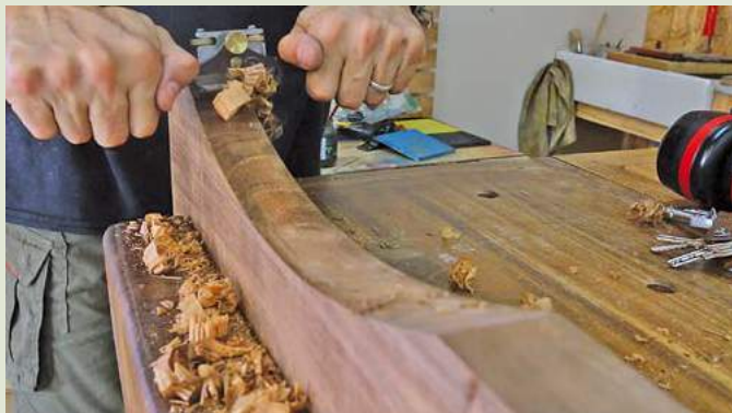
30 L'état de surface des chants de mes échancrures est fini au wastringue...
