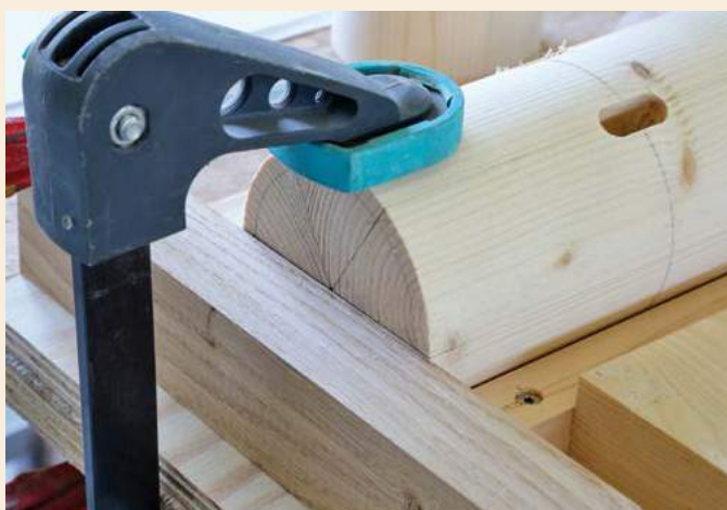
29 ... grâce au repérage des axes de perçages en bout de pièces
