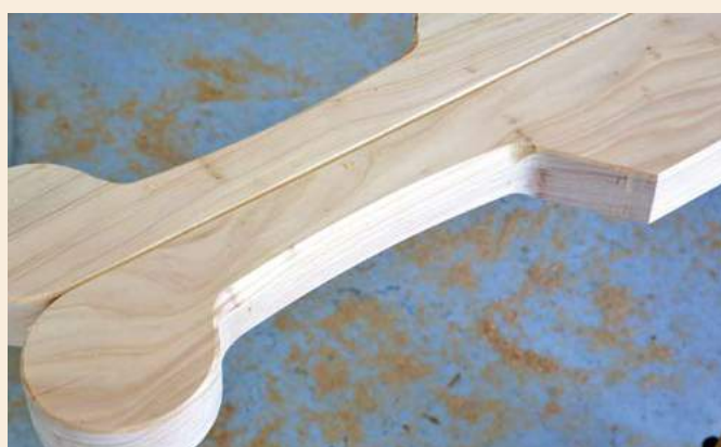
38 Reste à raccorder les chanfreins usinés sur les poignées
