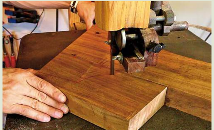
15 Chantournage de la forme de la presse à la scie à ruban
