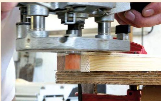
16 Travail au gabarit, avec une fraise à copier
