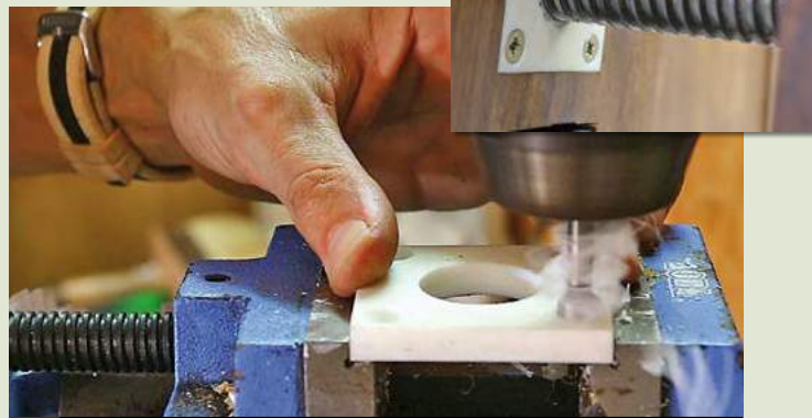
24 L'intégration de guides en plastique favorise la fluidité de la progression de la vis
