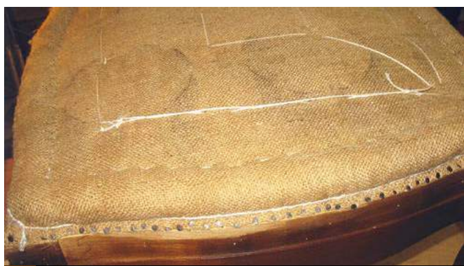
22 Gros plan sur le type de bourrelet à créer
