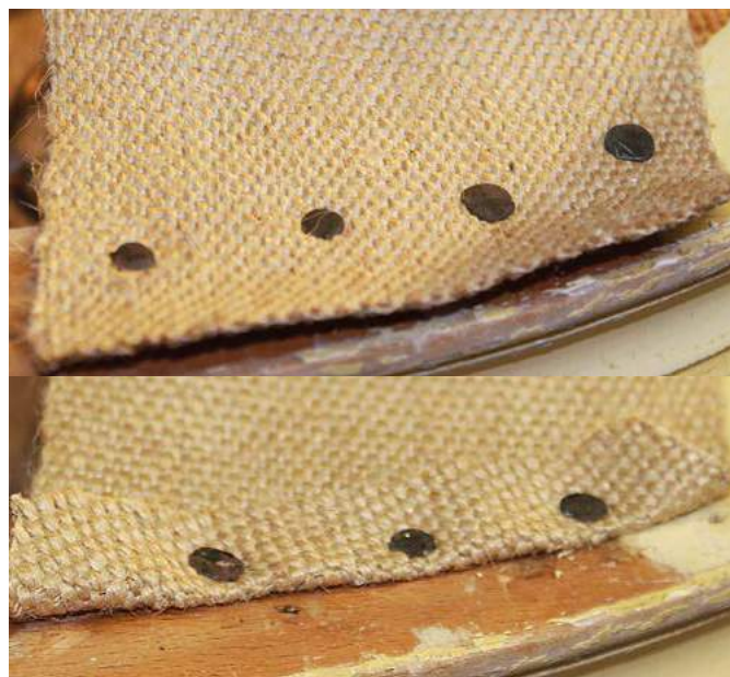
7 Les sangles sont fixées à chacune de leurs extrémités sous forme d'un rempli
