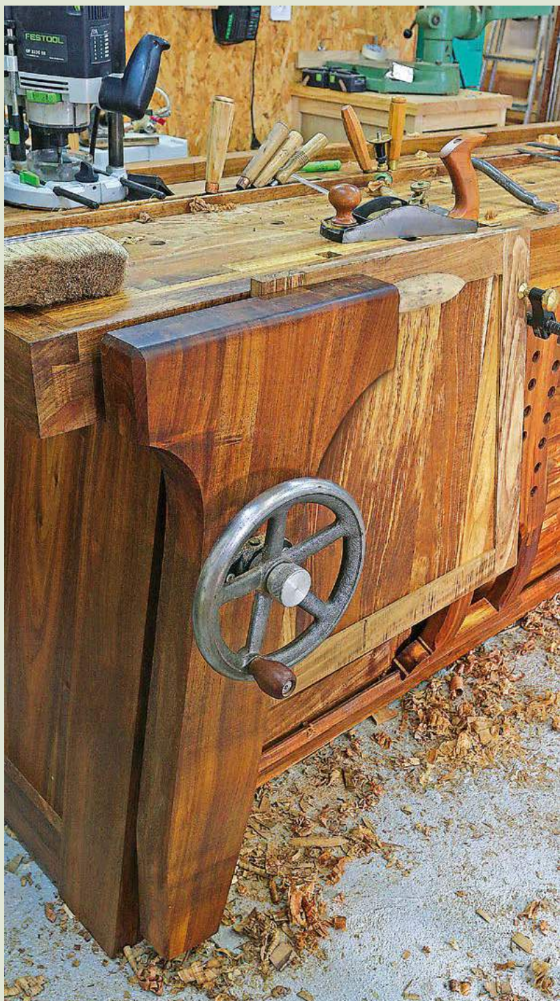
44 Comme expliqué dans le tout premier article de cette série consacrée à la fabrication d'un établi, une porte est facilement maintenue dans la presse avant
