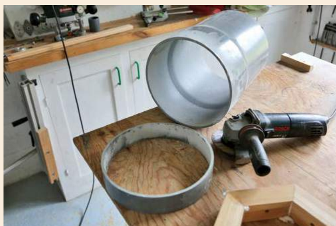
34 Je tronçonne une buse de PVC...
