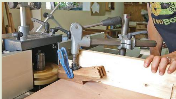
37 Usinage du tenon des pieds courbes en appui sur le tombant de scie à ruban
