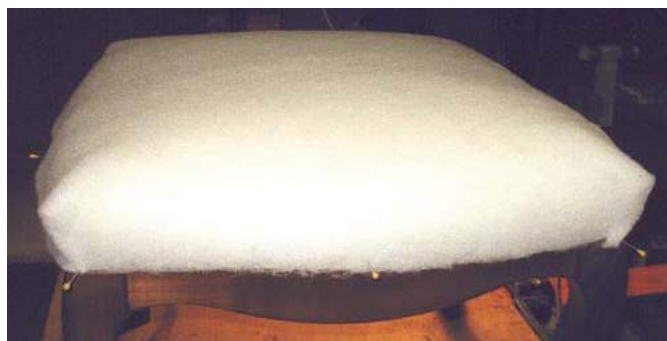
29 Ouate acrylique maintenue en position par des houzeaux
