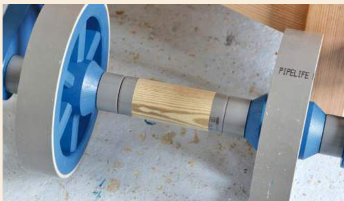
46 Une entretoise en PVC maintient l'écartement des roues
