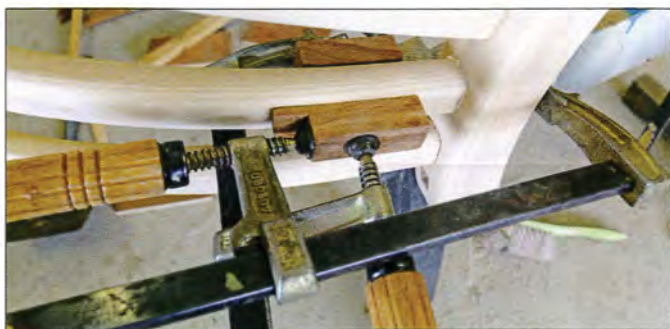
39 Deux cales en forme et deux serre-joints à chaque extrémité
