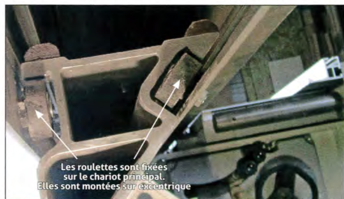
22 Chariot de dressage : roulettes caoutchoutées
