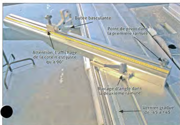
34 Accessoire : guide d'onglet (dispositif adapté pour deux rainures)
