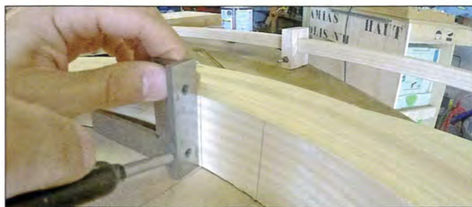
26 ... je reporte les axes de mes mortaises et les traits de coupes sur les anneaux porteurs
