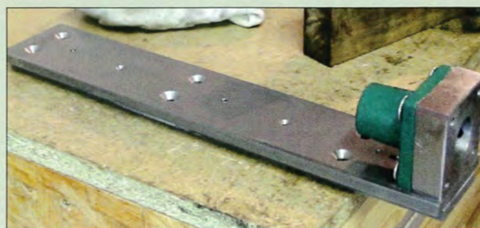
7 Partie fixe solidarisée avec le plateau de l'établi
