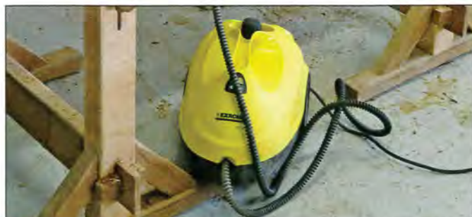
7 Un nettoyeur vapeur en guise de générateur de vapeur
