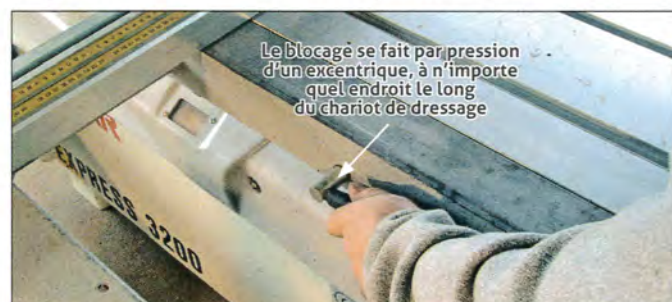
25 Verrouillage du chariot de mise d'équerre
