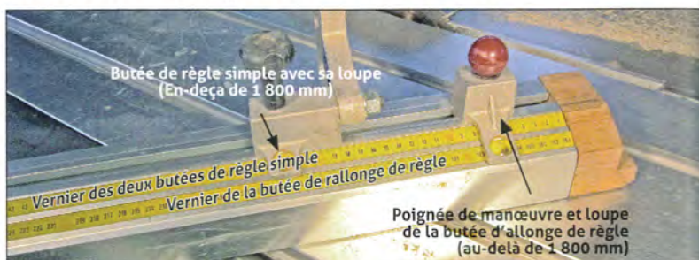
31 Règle de mise d'équerre : butées à loupe
