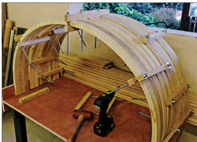
14 Pour conserver leur forme, elles devront être contraintes ainsi pendant une à deux semaines, le temps de sécher
