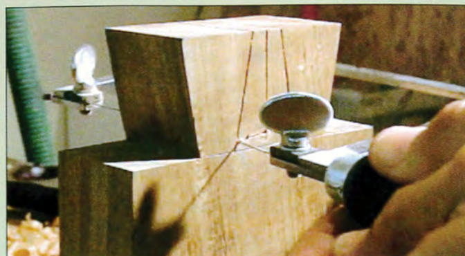
11 ... ou en dégrossissant à la scie à chantourner
