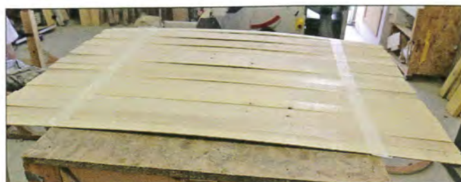
21 Je solidarise provisoirement les lamelles avec de l'adhésif...
