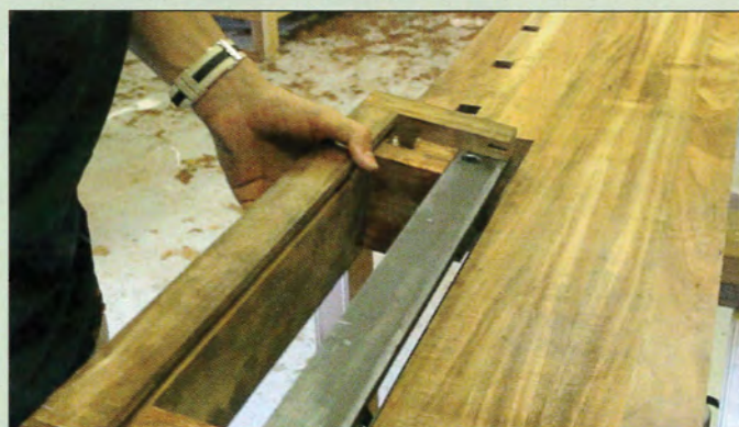
20 Je suspends la partie mobile de la presse en position sur la glissière principale
