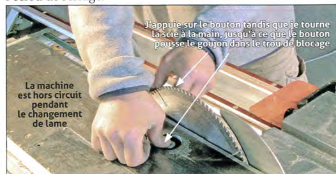
32 Changement de lame : le blocage se fait par un bouton situé sur l'arbre
