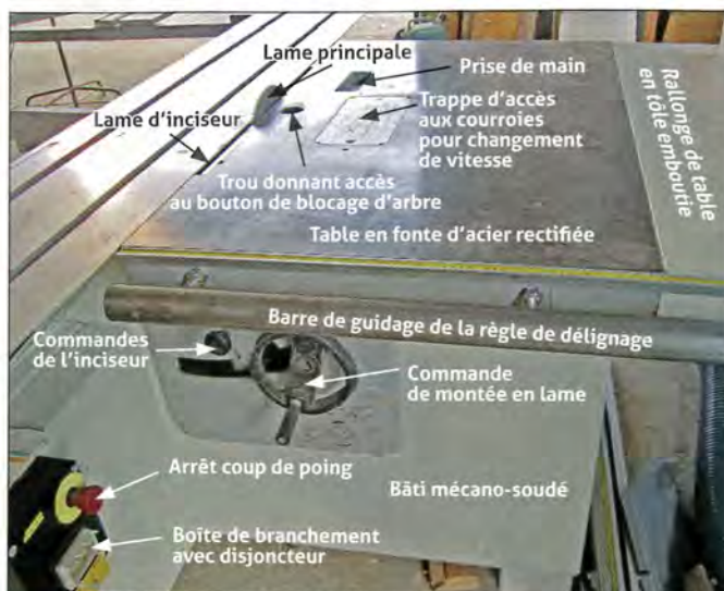
13 Scie à format : le corps de scie
