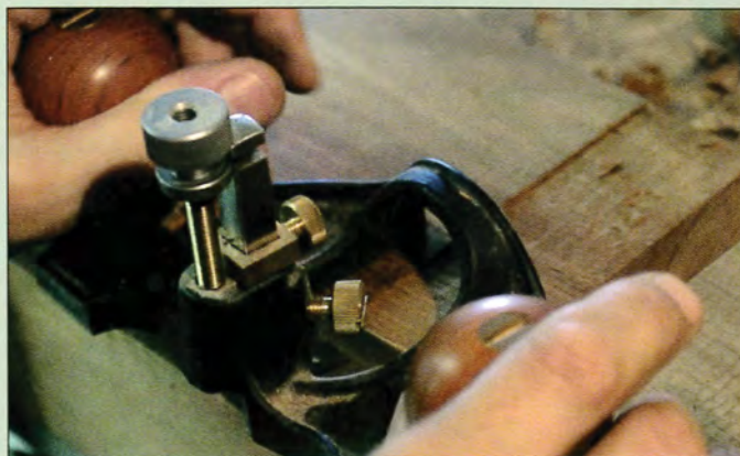
9 Utilisation de la guimbarde pour créer l'épaulement
