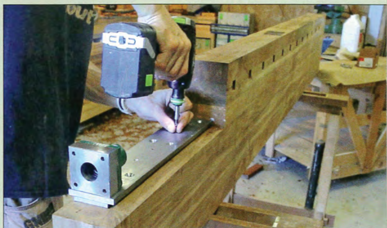
19 Je fixe la glissière principale provisoirement avec deux vis à bois
