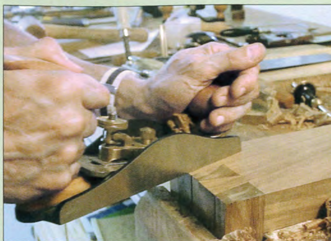
14 Un rabot à angle faible est idéal pour affleurer l'assemblage
