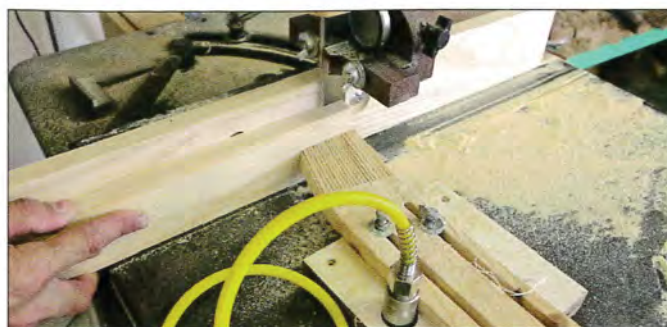
15 J'assure le débit répétitif des lamelles avec ma scie à ruban...
