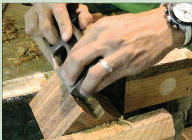
15 Les blocs-supports des patins doivent être façonnés avec minutie
