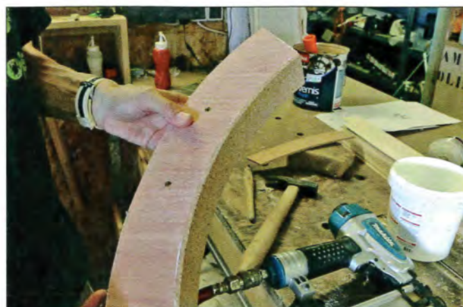
17 Le contre-moule est garni de liège pour absorber les irrégularités
