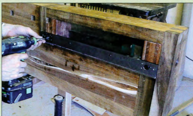
24 Je remonte l'ensemble et je positionne le patin inférieur
