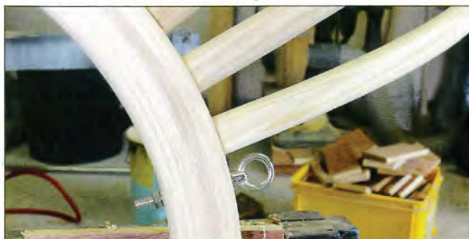
40 Pour arrimer le fauteuil en hauteur, j'utilise de l'accastillage de bateau en inox
