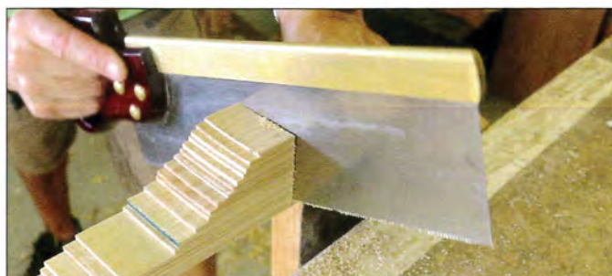
27 J'effectue la mise à dimension de mes anneaux
