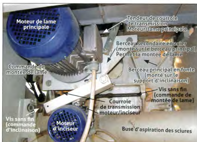
14 Scie à format : bloc moteurs/lames et leurs berceaux
