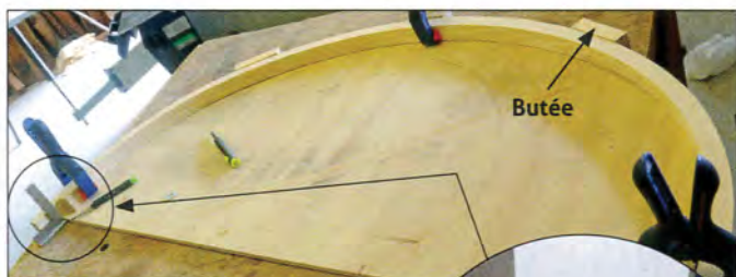
32 J'utilise un gabarit pour tracer précisément les tenons sur toutes les lattes
