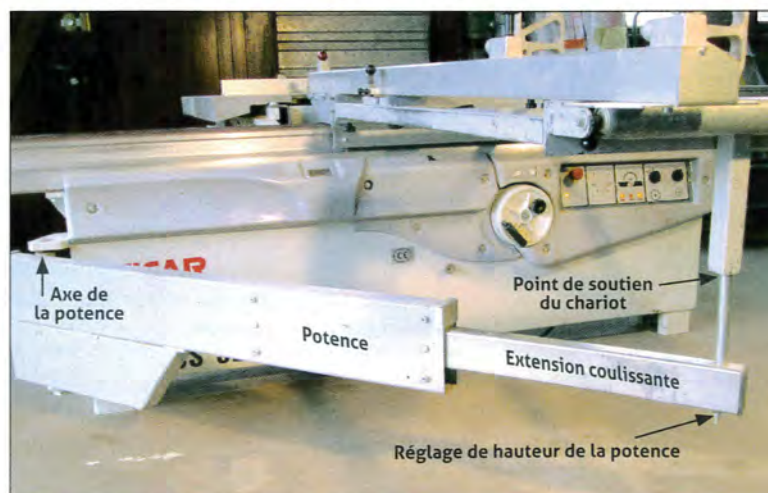
26 Chariot de mise d'équerre : potence de soutien
