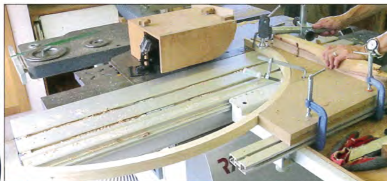
35 Le support de tenonnage me sert également à usiner les épaulements
