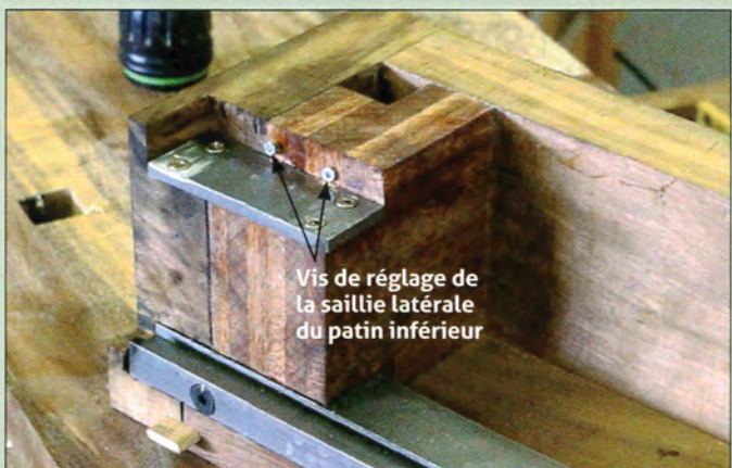
18 ... en agissant sur la saillie de deux vis à bois engagées dans la feuillure du bloc-support
