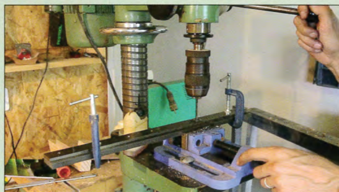
6 Les pièces à assembler sont percées simultanément
