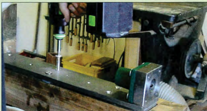
22 Je démonte la partie mobile et je fixe la glissière définitivement
