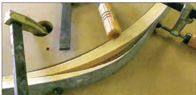
8 La mise en place sur le moule prend trop de temps ! Voici le résultat du premier essai
