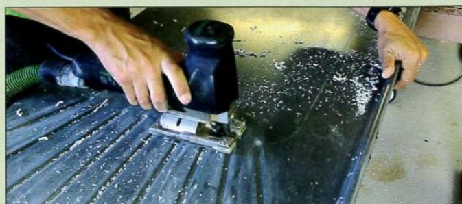
23 L'évidement est réalisé à la scie sauteuse...
