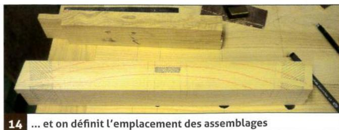
14 ... et on définit l'emplacement des assemblages
