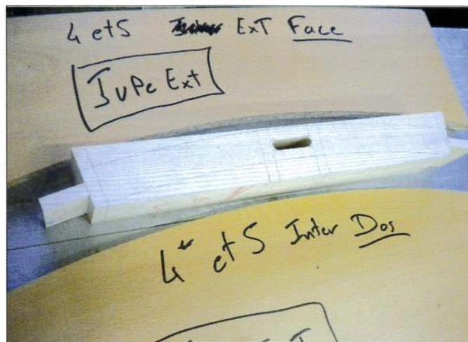
25 Un gabarit pour le parement, et un pour le contreparement
