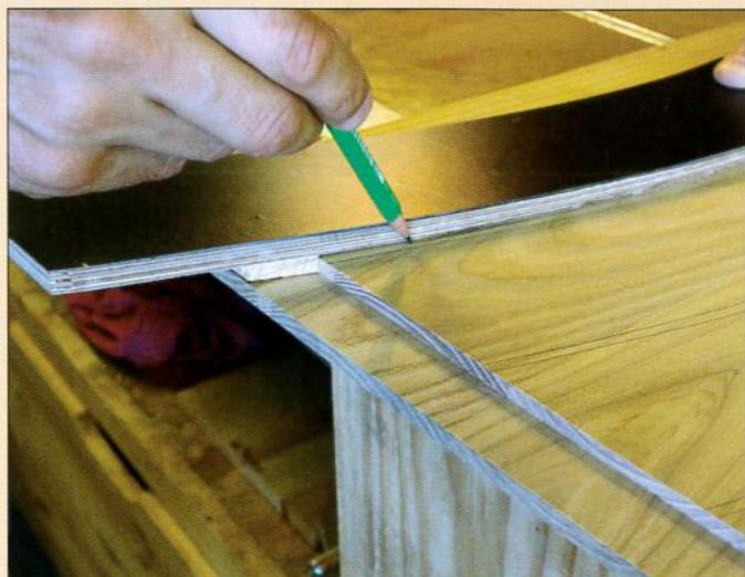
7 Le tracé des pièces s'effectue à l'aide d'un gabarit qui se cale sur les arasements
