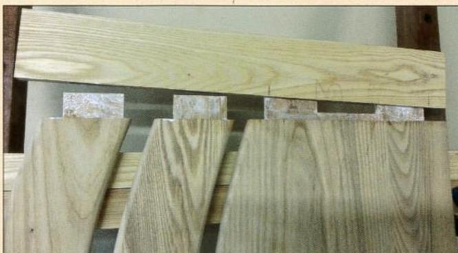
9 Détail de l'assemblage montants-traverses
