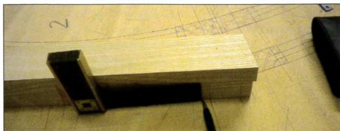
13 La pièce étant positionnée sur l'épure, avec l'équerre, on relève les tracés
