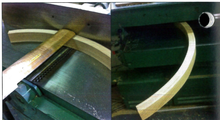
21 Attention à l'orientation des pièces durant les phases de corroyage
