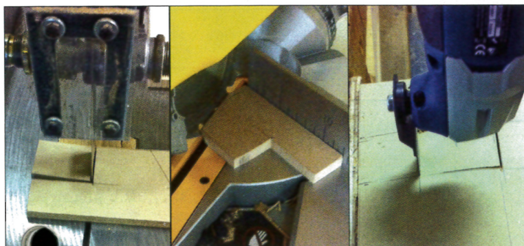
23 Découpe des éléments du montage d'usinage
