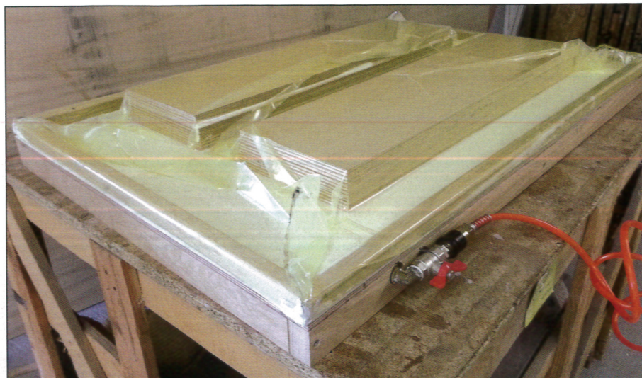
20 Contrairement à un collage classique à « plat joint », les pièces ne glissent pas.
