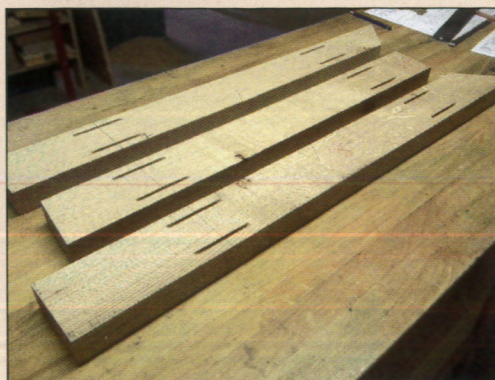
12 ... à la lamelleuse à environ 15 mm du bord
