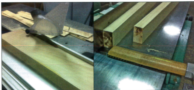
17 L'ensemble des lames est obtenu à partir de deux pièces « capables »
