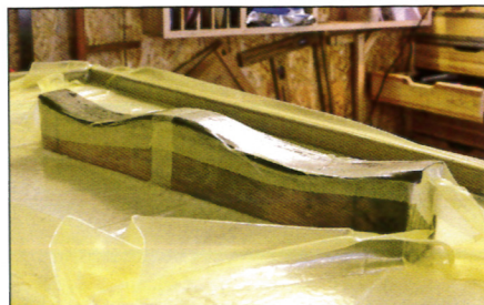
19 Couvercle fermé, pompe en marche, la poignée prend forme. Test réussi !
