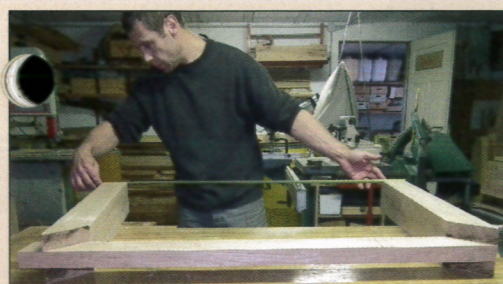
20 ... positionnez le second pied, et tracez la seconde coupe du pli ④ de la traverse
