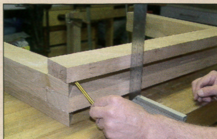
28 Tracez les coupes à réaliser sur le pli ⑤
