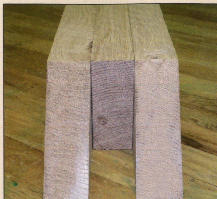
10 Positionnez les différents plis et repérez l'emplacement des futures entailles
