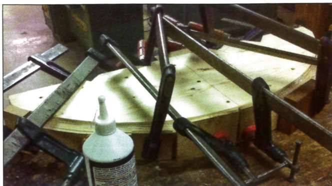
20 Chantier de collage d'un pied
