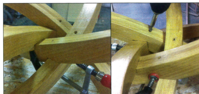
33 Fixation des pieds par vissage dans les faces inférieures
