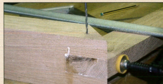
26 Vous pouvez compléter l'assemblage avec une vis
