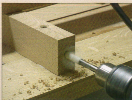
54 Unissez les renforts ⑪ et ⑫ au renfort ⑨ avec des tourillons
