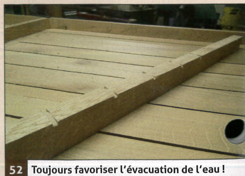
49 Un tasseau maintenu par des cales sert d'appui aux serre-joints
