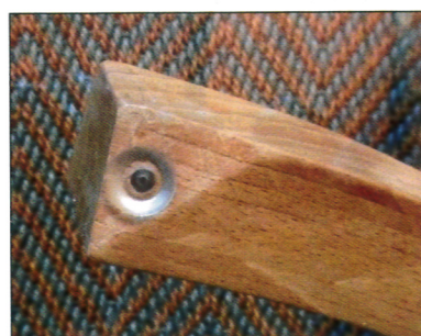
36 Le maintien discret du plateau, par pions
