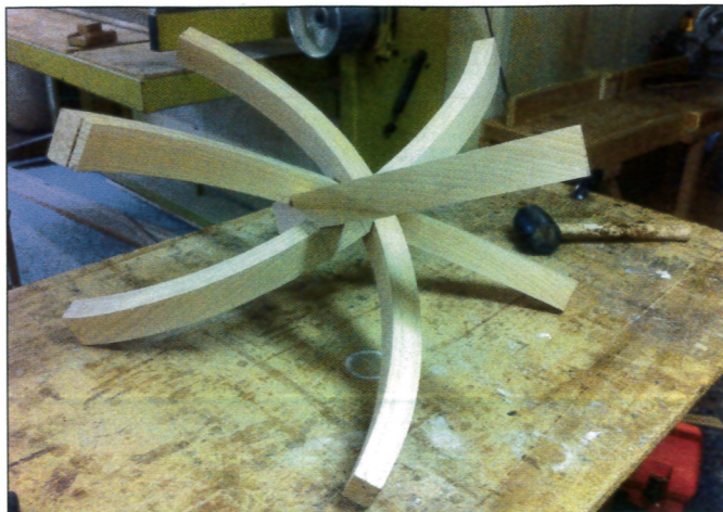
28 Premier montage à blanc de l'ensemble
