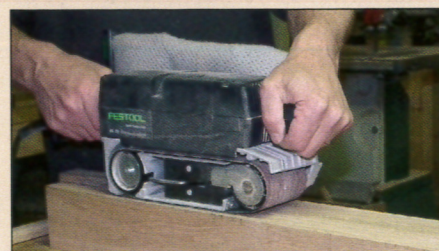
16 ... et égalisez l'état de surface à la ponceuse
