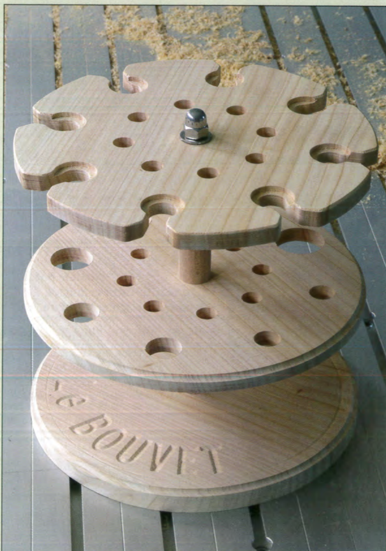
39 Assemblage. Les entretoises sont en hêtre
