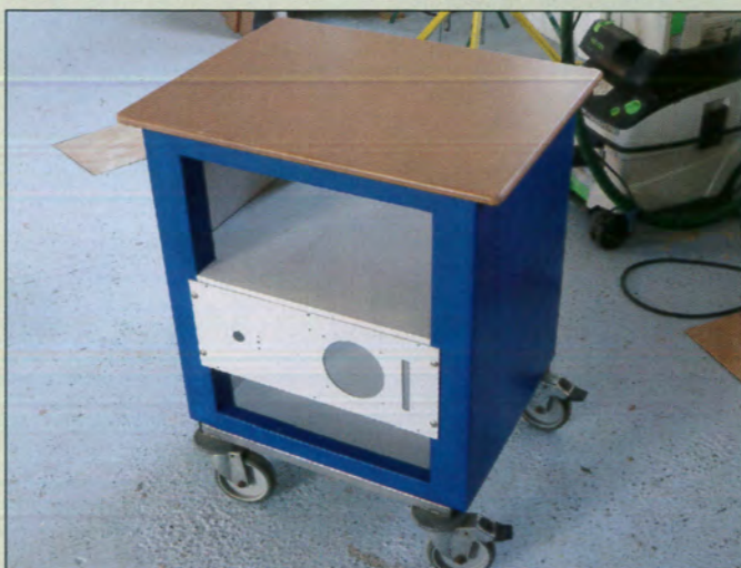
9 Ma servante en pin et MDF, prête à recevoir l'ordinateur : sa façade est en aluminium de 3 mm façonnée à la défonceuse et calibrée à la scie à format
