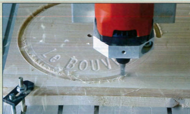
25 Découpe de la pièce en trois passes de 5 mm à 1 800 mm/min
