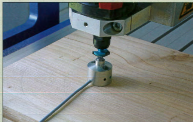
18 Le palpeur de hauteur de la fraise
