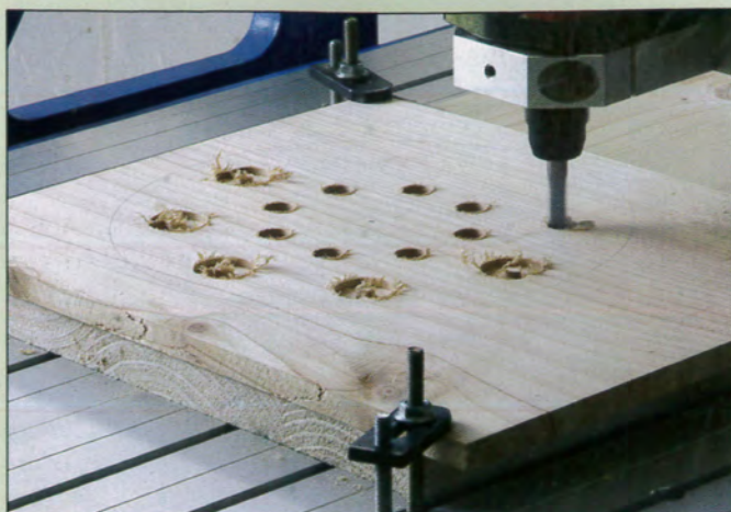
31 Création d'arcs de cercles, qui deviendront des feuillures, en mode « contour interne »
