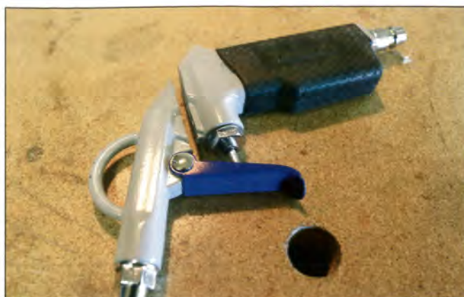
4 Je commence par couper la partie supérieure de la soufflette...
