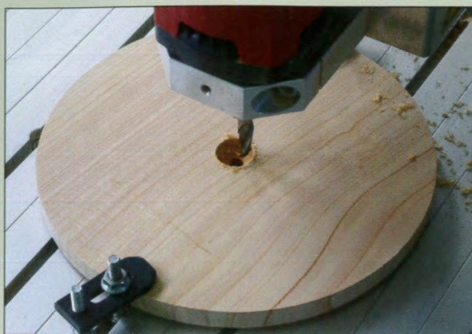
28 Retournement de la pièce, et fraisage du lamage
