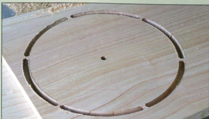
26 Les attaches conservées sur l'envers de la pièce, visibles ici, permettent de maintenir la pièce jusqu'à la fin de l'usinage
