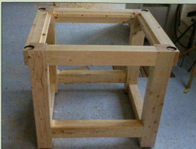
8 Le meuble support, largement dimensionné, est en lamellé-collé de sapin
