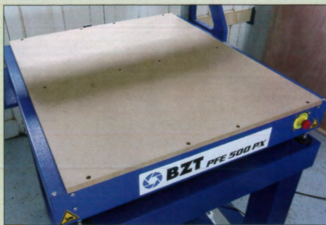
4 La table en MDF permet d'y fixer directement les pièces à usiner
