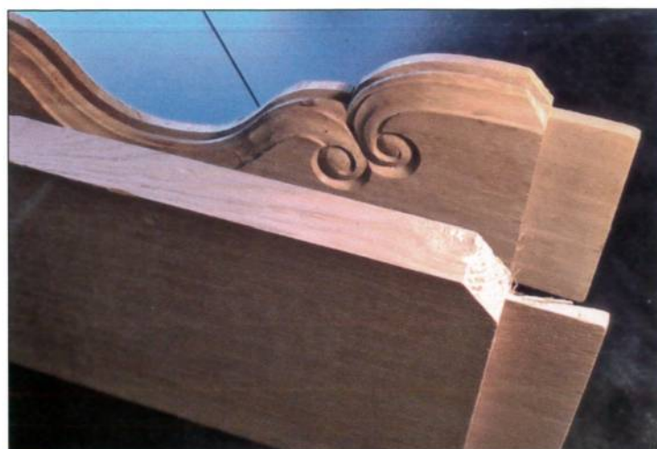
17b Usinage uniquement à l'outil à chanfrein
