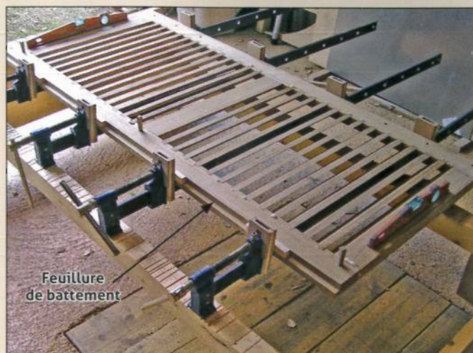
25 Troisième phase : encollage et assemblage final
