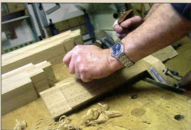
14 Une fois usinés à 45°, les chants sont terminés au rabot racloir
