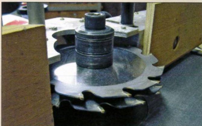
13 Pour les joues des tenons, des traverses, deux lames de scie sont montées sur toupie
