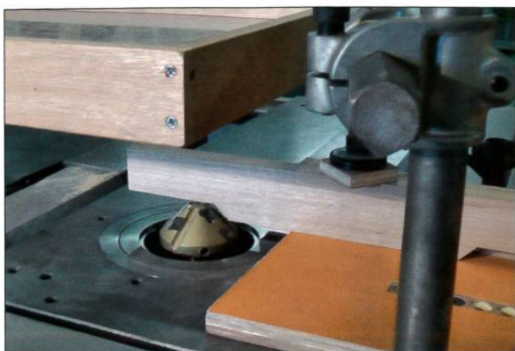
16 Usinage de l'onglet avec l'outil « à chanfrein » en bout d'arbre
