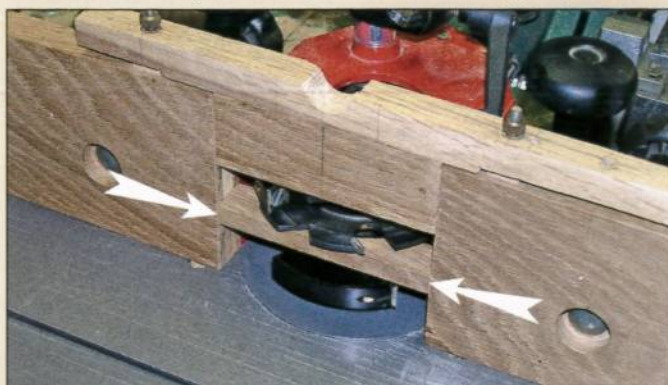
19 Je mets en place un guide continu avec barrette pour éviter que les lames soient happées
