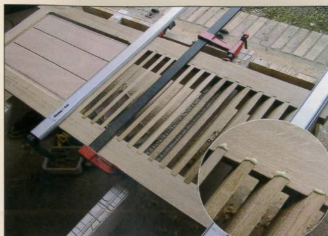
24 Deuxième phase : encollage des lames sur le premier montant : la colle exsude durant sa prise
