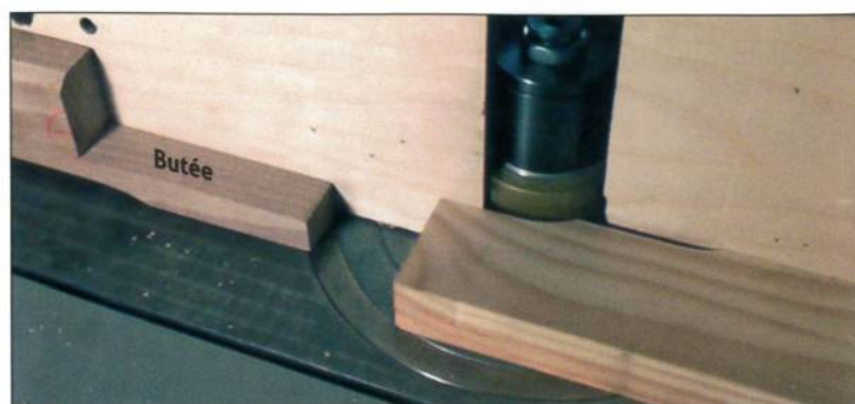
14 Les montants sont dégrossis au calibre, avec un décalage des joues du guide et une butée d'arrêt
