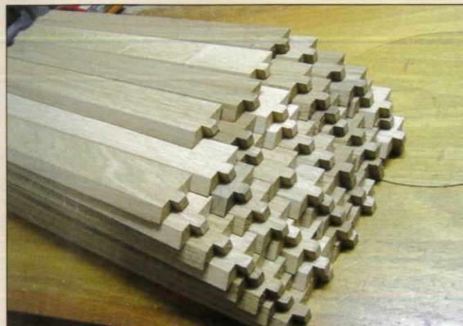
21 ...voici à leur tour mes lames terminées (après un « mouchage » des tenons pour favoriser leur pénétration)
