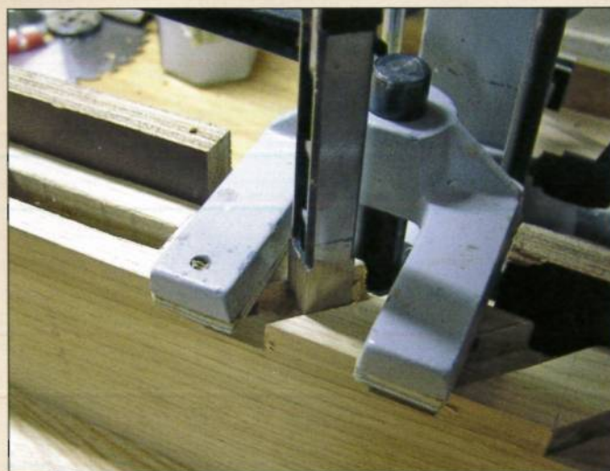
10 Pour la partie femelle de nos persiennes, ce sera des petites mortaises de 12 x 12 mm...
