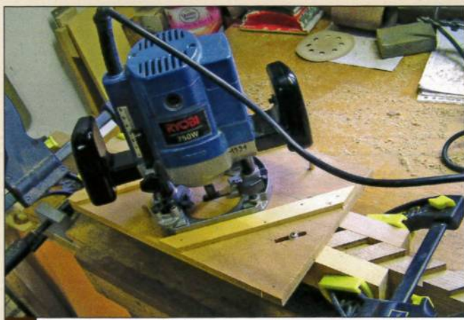
7 Avec ce montage d'usinage, on usine un montant à la fois
