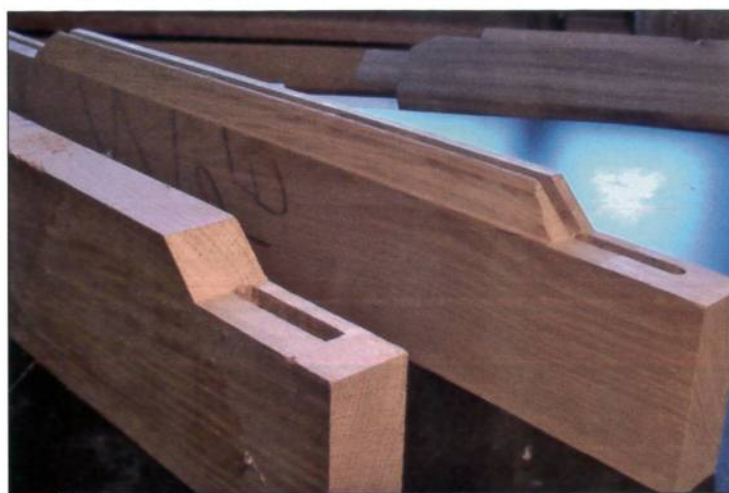
17a Usinages au calibre + outil à chanfrein en bout d'arbre
