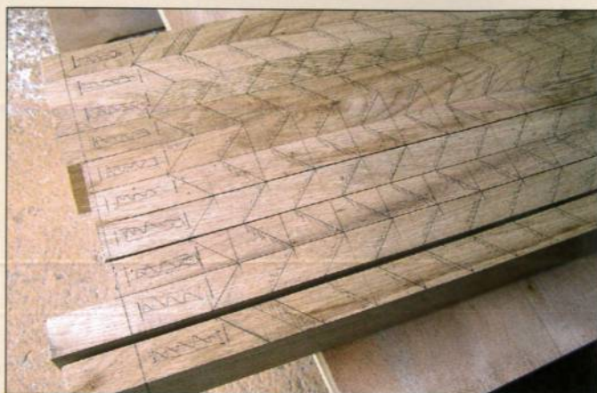
4 Tous les éléments sont tracés sur les chants des montants
