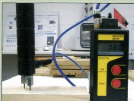
7 Mesure électrique, avec humidimètre
