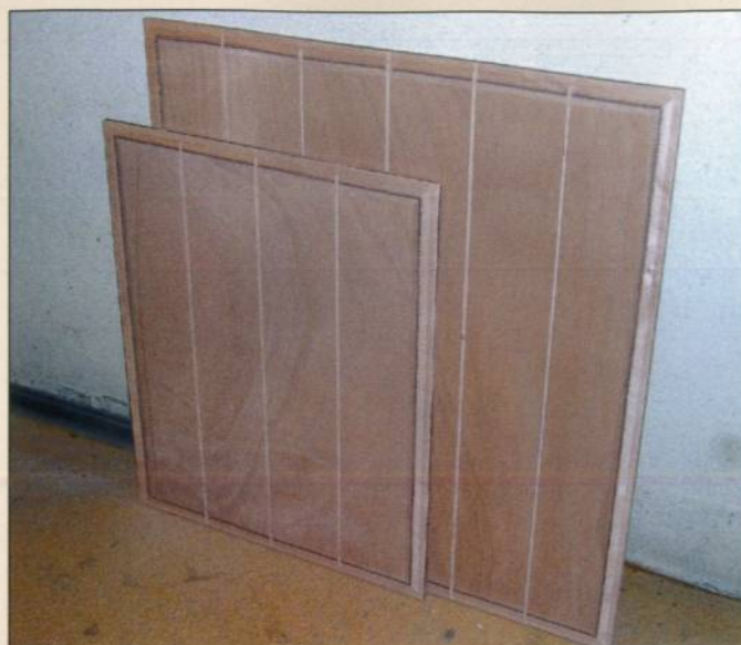
22 Panneaux en contreplaqué « marine » de 15 mm
