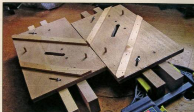
5 Montages d'usinage à entailles de ma première paire de volets
