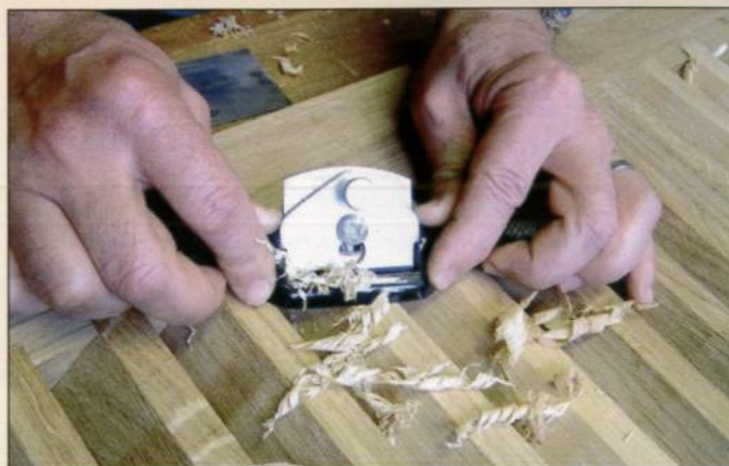
26 Si nécessaire, les lames sont affleurées au niveau des montants
