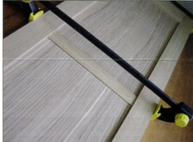
24 Montage final avec entretoise (latte) calibrant le parallélisme des montants au niveau des panneaux de contreplaqué.
