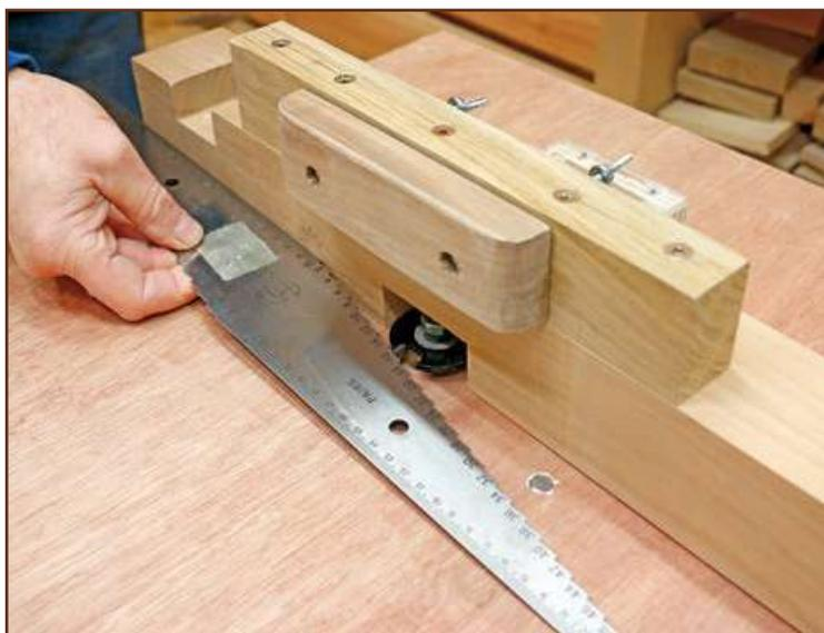
En faisant pivoter le guide sur son axe (la vis avec l'écrou papillon), vous allez déterminer cette valeur, qui sera la profondeur d'usinage dans le bois. Dès que vous pensez que le réglage est bon, serrez à la table l'autre extrémité du guide avec un serre-joint ou une presse et serrez l'écrou papillon.
