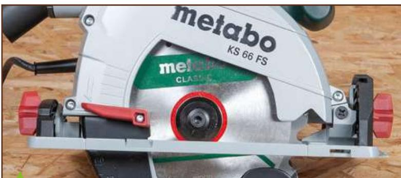
Le réglage de l'inclinaison se fait généralement à l'avant mais parfois aussi en même temps à l'arrière, d'où plus de rigidité (si du moins la liaison bloc moteur-semelle n'est pas trop souple).
