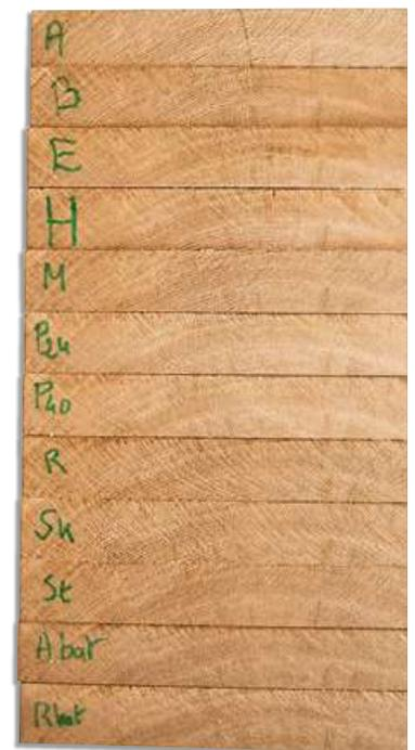
L'état de coupe en tronçonnage et en délignage, machine par machine (repérée par la ou les première(s) lettre(s) de son nom, avec deux lames pour Parkside. Les deux scies à batteries sont incluses. C'est bien pour Metabo, ça le serait probablement pour AEG sans son défaut de parallélisme. Pour les autres, une meilleure lame serait nécessaire, mais qu'attendre de plus quand on connaît le prix d'une bonne lame : au minimum le prix de la Parkside complète... livrée avec deux lames !
