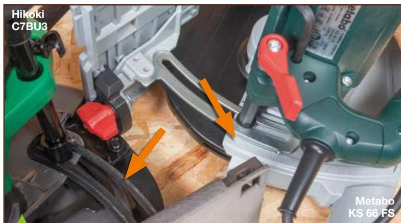
Grand écart entre Hikoki et Metabo, les deux machines les plus chères du test : Hikoki ne cherche même pas à graduer le réglage de profondeur, alors que Metabo pousse au contraire la précision jusqu'au millimètre (est-ce bien utile ?).
