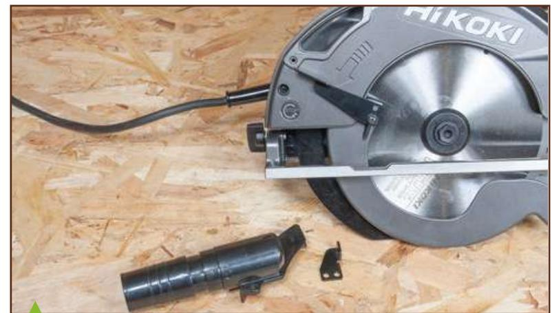
Situation inhabituelle sur la Hikoki : il y a deux leviers. Si l'on veut installer le capteur d'aspiration, il faut remplacer celui d'origine par un second plus court (fourni), sinon le capteur empêche l'ouverture du capot.
