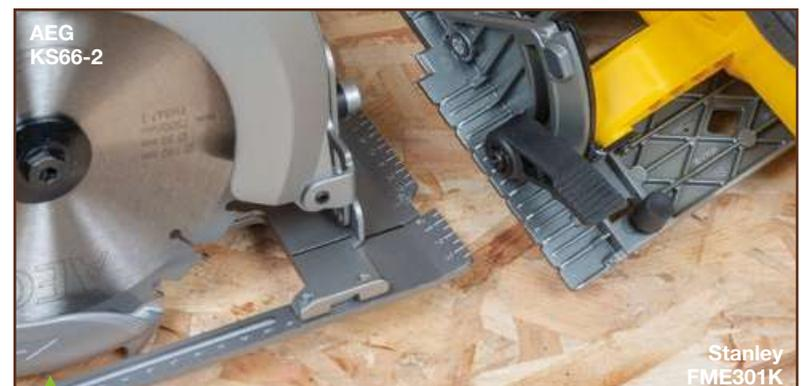
De nombreuses semelles sont graduées ou crantées, et je n'en vois vraiment pas l'intérêt vu la précision qu'on peut attendre d'un guidage à l'œil. Quant au rôle des graduations sur le côté gauche de la semelle d'AEG, cela reste pour moi un mystère.
