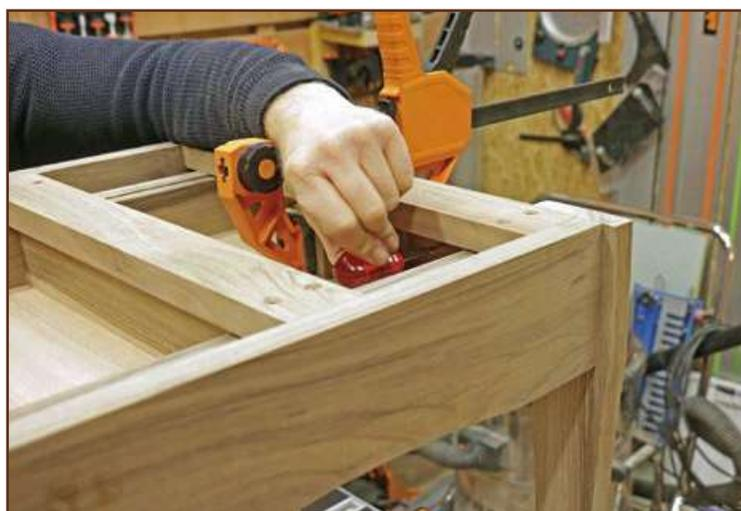
Sinon, je vous conseille de marquer l'emplacement des vis avec une pointe à tracer (ou une simple vis) en passant par les trous de la caisse du tiroir. Vous pouvez ensuite enlever le tout, repositionner la caisse sur la façade et mettre les vis en place.
