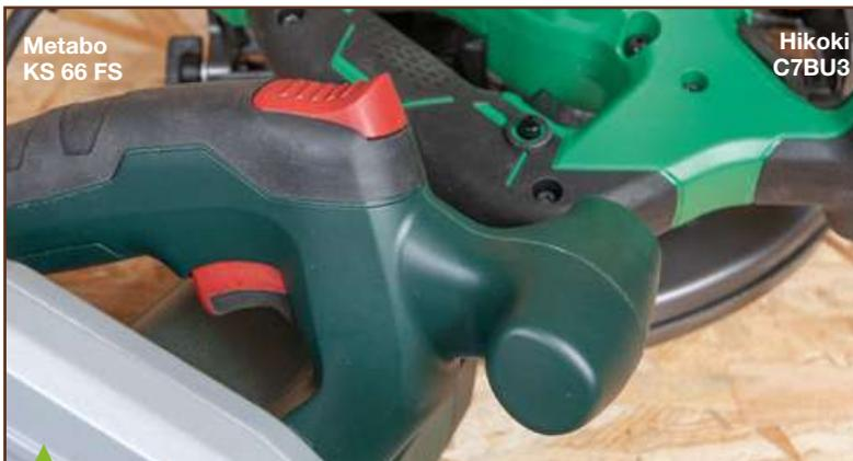
Si la plupart des machines ont un poussoir de sécurisation de la gâchette transversal, appuyé soit par la droite soit par la gauche, Metabo et Hikoki se distinguent avec respectivement un poussoir par-dessus (cela fonctionne aussi très bien) et un très petit poussoir à gauche uniquement (donc plus difficilement utilisable en tenue gauchère).
