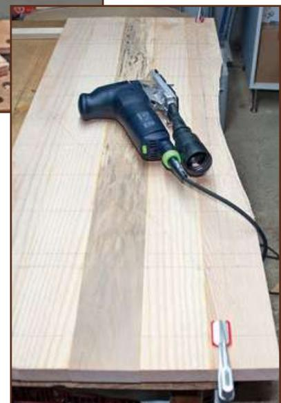
J'ai enfin tracé trois repères de positionnement sur le gabarit : début, fin et milieu de la courbe. À l'aide des deux gabarits précédemment fabriqués, j'ai commencé par effectuer les tracés (extrémité côté mur et courbes avant). Puis les découpes à la scie sauteuse. J'ai ensuite réalisé les détourages en fixant les gabarits sur le plateau avec de l'adhésif double face. J'ai utilisé une semelle de défonceuse en Plexiglas pour mieux voir l'usinage.
