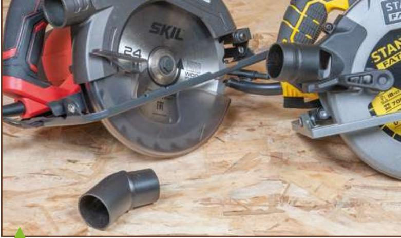
La sortie de Skil est dirigée vers l'arrière, mais un manchon est livré qui permet de l'orienter à convenance, à l'instar de la Metabo. La sortie de Stanley (livrée démontée, comme celle d'Hikoki) est dirigée sur le côté. Elle comporte curieusement une ouverture latérale dont je me demande la raison d'être.
