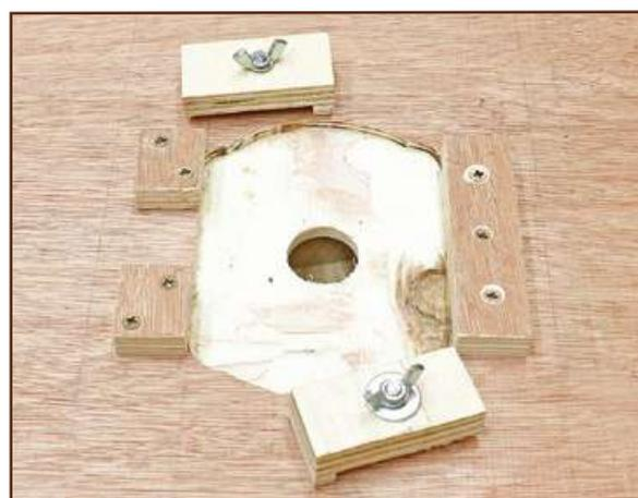
Deux autres cales munies de vis et d'écrou papillon, que j'ai appelées « brides » viendront serrer le socle de la défonceuse et la maintenir solidement au plateau.
