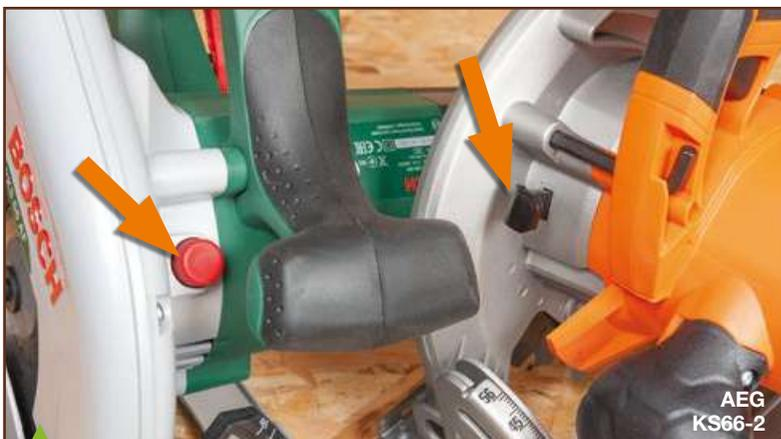
Un poussoir de blocage d'arbre gainé de plastique est plus confortable qu'une simple tôle repliée. Surtout si le ressort de rappel est très puissant, comme sur l'AEG. Heureusement celui-là reste très accessible, ce qui n'est pas toujours le cas.
