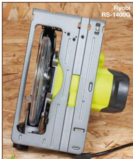
Lorsque les semelles sont rainurées (Bosch, Einhell, Metabo, Ryobi) on peut aisément fabriquer son propre rail de guidage, avec du contreplaqué mince et un tasseau. Et pourquoi pas, en fonction des besoins de circonstance, imaginer d'autres gabarits de coupe à des angles précis.
