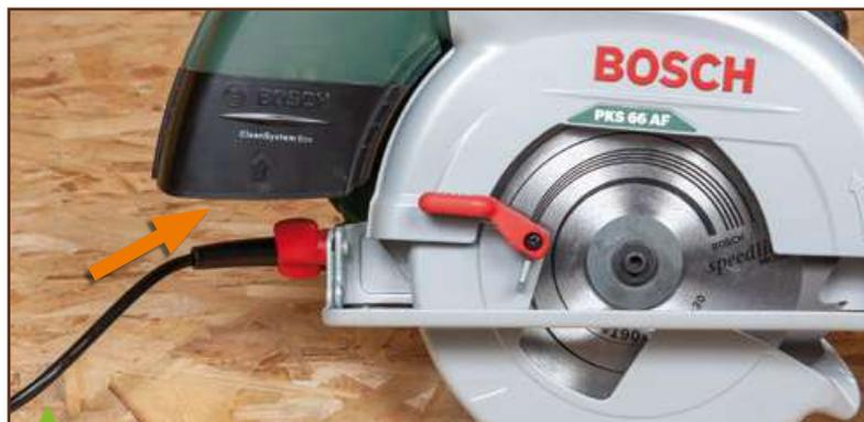
La Bosch est livrée avec une cassette de récupération des sciures, qui s'emmanche à l'emplacement également prévu pour le tuyau d'aspirateur. Cela pourra dépanner, par exemple pour faire des débits dans un chantier en intérieur sans disposer d'un aspirateur. Mais il faudra vider très souvent !
