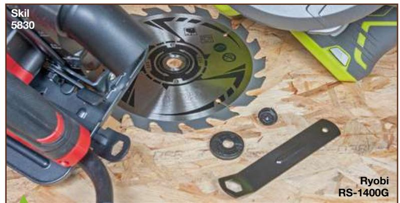
Si la plupart des lames sont maintenues par un boulon six pans creux, la Skil et la Ryobi font exception (encore que le boulon Ryobi ait les deux empreintes). Ces deux machines ont donc une clef de service plate, plus encombrante à loger sur la machine qu'une clef Allen.
