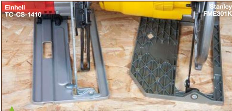
Semelle en tôle emboutie ou semelle moulée ? J'avoue ne pas trop voir d'avantage entre les unes et les autres, c'est plutôt le soin apporté à la fabrication qui fait la différence. À noter sur la photo : la présence d'un couteau diviseur impose que le capot de lame soit fendu... ce qui évite aussi que des copeaux s'y accumulent !
