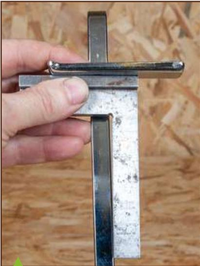
Et qu'attendre d'un guide qui n'est même pas perpendiculaire à sa tige, donc pas parallèle à la lame (Einhell) ? Voilà qui en dit long sur le niveau des tolérances de fabrication. Ou est-ce sur l'importance accordée par les fabricants à cet accessoire ? Pour une fois je serais presque d'accord avec eux !
