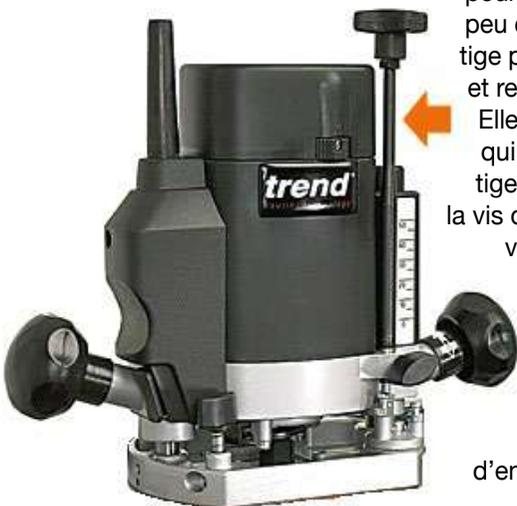
Le micrométrique de la Trend T5 se monte aussi sur des modèles d'autres marques.
