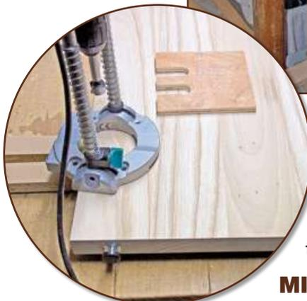
J'ai ensuite découpé les passages de la tuyauterie, rapportés à l'aide du gabarit. Les perçages sont réalisés à l'aide d'un support de perçage mobile et les entailles à la scie japonaise, avec bien entendu un travail de finition à la râpe et à l'abrasif.
