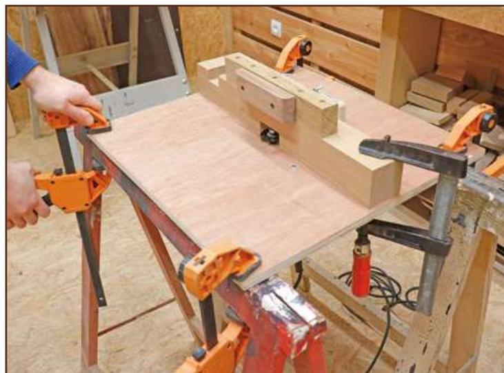
Approchez alors une pièce de bois à usiner en position d'usinage sur la table et en dessous des deux vis de serrage. Insérez le presseur entre ces deux vis et placez les cales nécessaires pour que le presseur se trouve bien au-dessus de la pièce à usiner.
