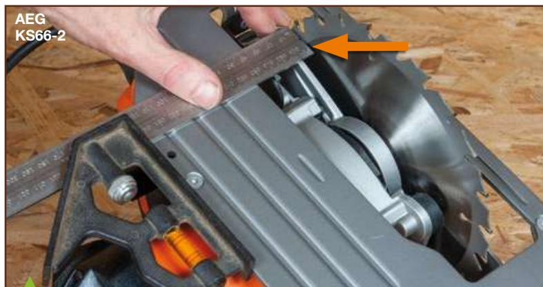
Trois machines présentent un sérieux défaut de parallélisme entre la lame et le bord de la semelle : Einhell (1 mm), Parkside (1,7 mm), et surtout AEG (1,8 mm). Cela se voit aisément sur la photo : mon équerre à combinaisons a ici été réglée sur l'avant de la lame ; une fois reportée à l'arrière, le jour entre son extrémité et la lame est nettement visible.
