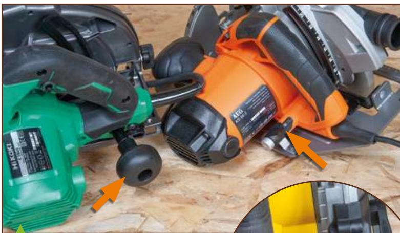
Le levier de réglage de profondeur est plus confortable lorsqu'il est situé à gauche de la poignée arrière ; à fortiori lorsque c'est une généreuse boule (Hikoki) ou une poignée indexable (AEG). À contrario les petits leviers de Ryobi, Skil et Stanley, coincés entre carter de lame et poignée, sont peu maniables.
