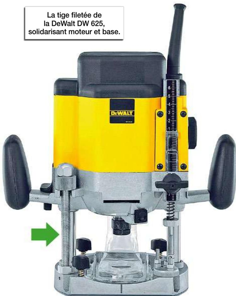
Cette tige porte deux écrous, serrés l'un contre l'autre pour blocage. Vous pouvez juste manœuvrer ces écrous à la main et à la clé, pour régler la hauteur. Vous voulez mieux ? Remplacez ces écrous par un écrou « Nylstop », freiné par une inclusion de plastique. Achetez une clé à tube à sa taille. Pour votre confort, vous pouvez équiper cette clé d'un disque gradué en dixièmes, avec un système de fixation quelconque.
