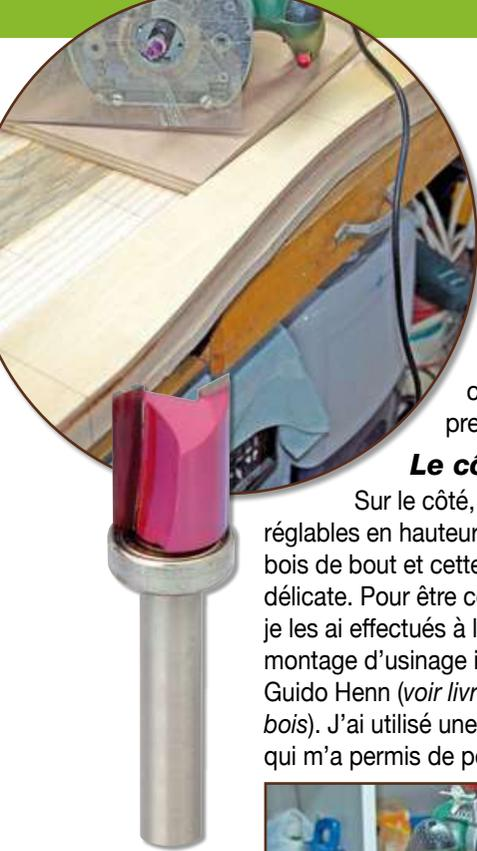
Du fait de l'épaisseur du plateau, l'usinage est cette fois réalisé avec une fraise à copier. Un premier passage est donc effectué roulement contre le gabarit, puis le second, après démontage du gabarit, est réalisé cette fois roulement en appui sur le premier passage de la fraise.
