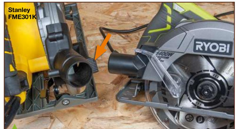
La plupart des leviers de basculement du capot sont confortables, voire généreux, comme sur la Ryobi. Il serait préférable qu'ils ne dépassent pas au-delà de la semelle, comme sur la Stanley (flèche orange), pour pouvoir scier un plancher au plus près d'un mur, par exemple.
