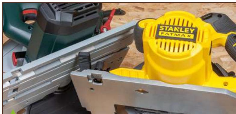
La hauteur disponible entre le dessous du moteur et celui de la semelle est cruciale pour exploiter la hauteur maximale de passe en se guidant contre une règle. Le passage est plutôt bon sur la Metabo, là où pour loger le volumineux moteur Stanley, il faut une échancrure dans la semelle.
