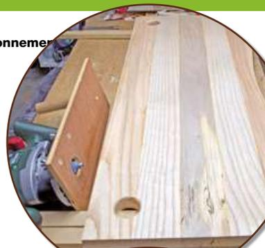
Les passages de câbles sont usinés avec une scie-cloche de 50 mm de diamètre et un support mobile. La partie inférieure de l'orifice est arrondie avec une fraise à quart-de-rond, de façon à ne pas endommager les câbles. J'en profite aussi pour arrondir le chant avant du plateau.
