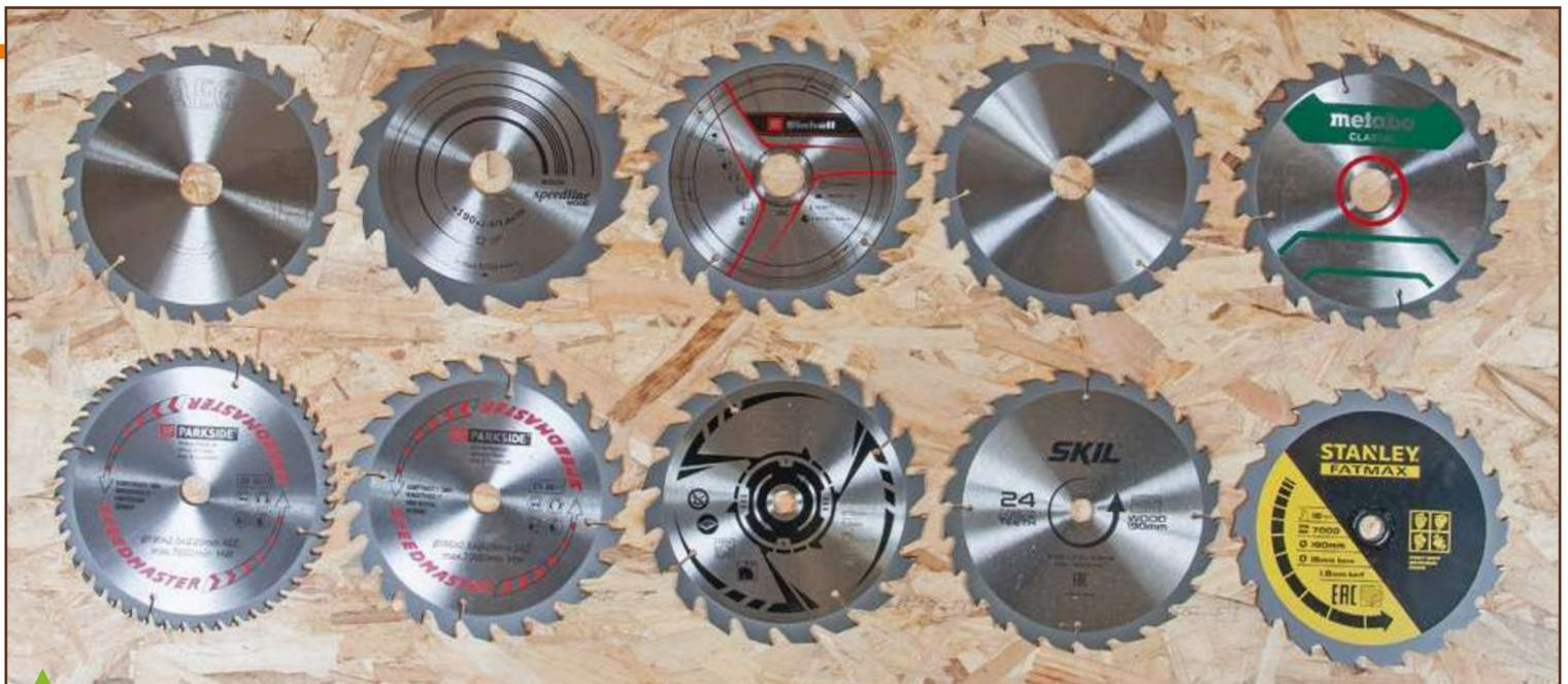
Dix lames pour neuf machines... Eh oui, Parkside en fournit deux différentes, de 24 et 40 dents (les deux lames fournies par Skil étant identiques, je n'en ai mis qu'une sur l'illustration). Plutôt qu'une surenchère sur le nombre de lames, on préférerait plus de qualité ! À noter : l'alésage de 30 mm est certes le plus courant, mais n'est pas pour autant généralisé.
