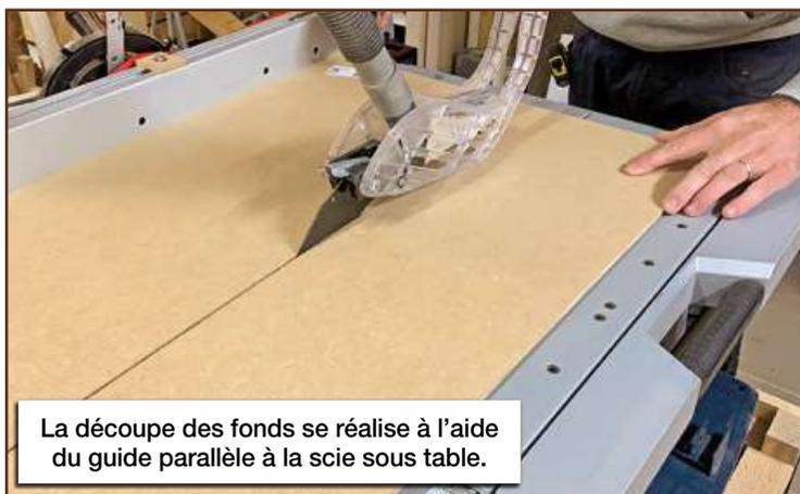
La découpe des fonds se réalise à l'aide du guide parallèle à la scie sous table.
