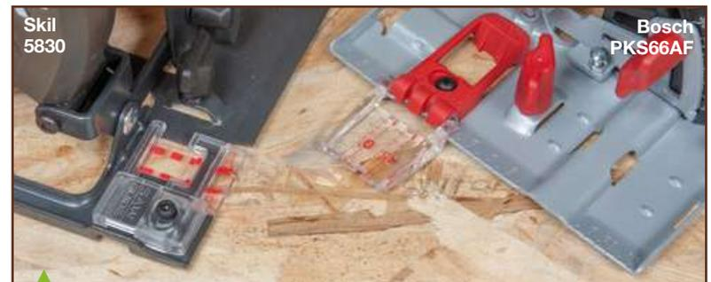
La Skil et la Bosch sont équipées d'un bel index de guidage en plastique transparent, qui est même rabattable pour la Bosch. Ces index ont beau être réglables, j'ai du mal à y voir autre chose qu'un gadget, à moins de travailler « à l'arrache ».
