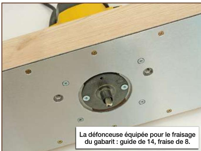
La défonceuse équipée pour le fraisage du gabarit : guide de 14, fraise de 8.
