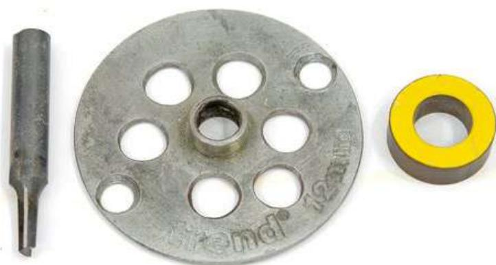
Un jeu d'outillage possible : guides Ø 12, bague Ø 22, fraise Ø 5.
