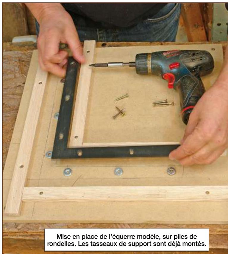
Mise en place de l'équerre modèle, sur piles de rondelles. Les tasseaux de support sont déjà montés.
