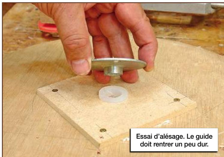
Essai d'alésage. Le guide doit rentrer un peu dur.
