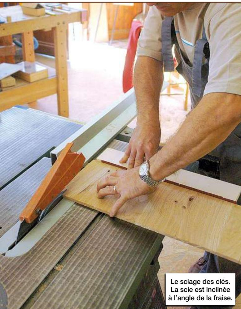
Le sciage des clés. La scie est inclinée à l'angle de la fraise.
