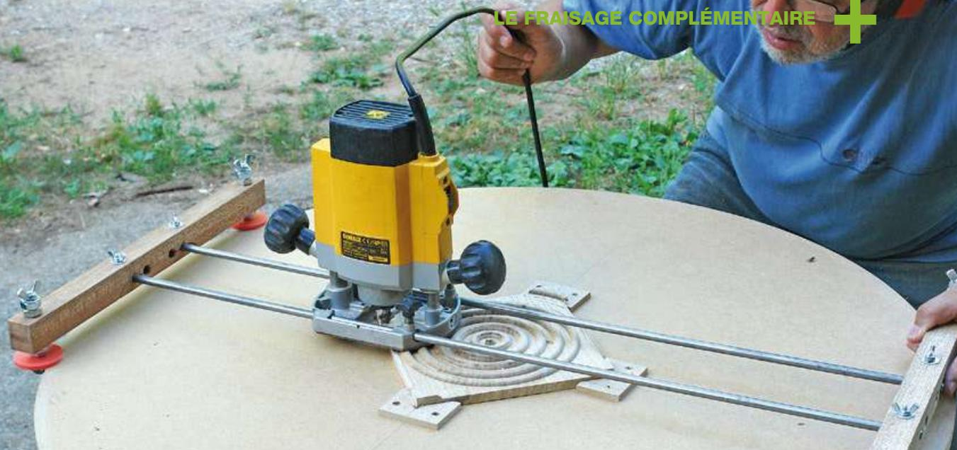
Voici un montage astucieux pour réaliser des fraisages circulaires. Il permet un travail extrêmement précis, il est raisonnablement simple et rapide à fabriquer, et facile à utiliser !
