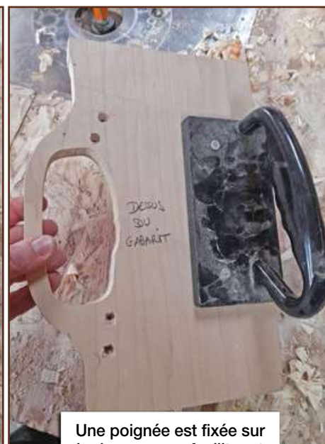
Poursuivre le fraisage intérieur et extérieur pour façonner la seconde moitié de la poignée.
