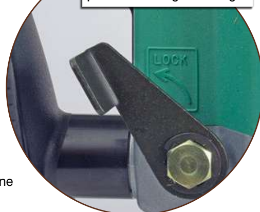
Un levier de blocage simple (Hitachi M8 V). L'écrou central permet de changer son angle.
