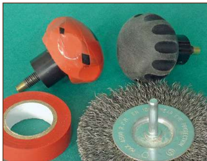
Deux façons de singulariser des poignées tournantes : par habillage ou par brossage.
