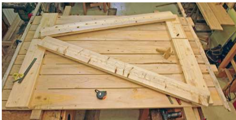
Le platelage solidarisé, et les pièces de renfort à leur place.
