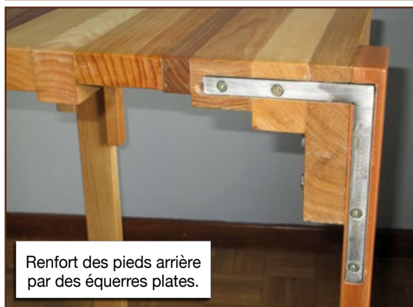
Renforts métalliques sous plateau.
