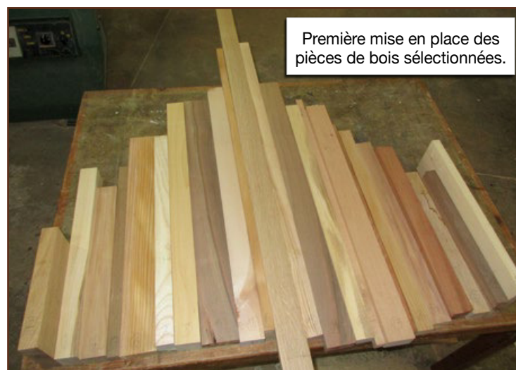
L'emplacement de chaque pièce est attribué avec un numéro. Les différences d'épaisseurs soulignent les différences d'essences.
