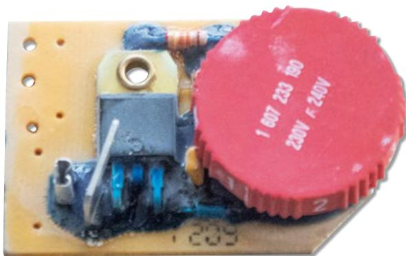
Le variateur de vitesse est aussi une cause fréquente de faux-contact lorsque les pistes du potentiomètre sont obstruées par de la poussière. Celui de la photo est très accessible et assez facilement dégrossissable avec une bombe pour contacts électriques, mais ce n'est hélas pas toujours le cas.
