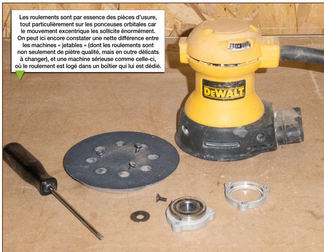
Les roulements sont par essence des pièces d'usure, tout particulièrement sur les ponceuses orbitales car le mouvement excentrique les sollicite énormément. On peut ici encore constater une nette différence entre les machines « jetables » (dont les roulements sont non seulement de piètre qualité, mais en outre délicats à changer), et une machine sérieuse comme celle-ci, où le roulement est logé dans un boîtier qui lui est dédié.
