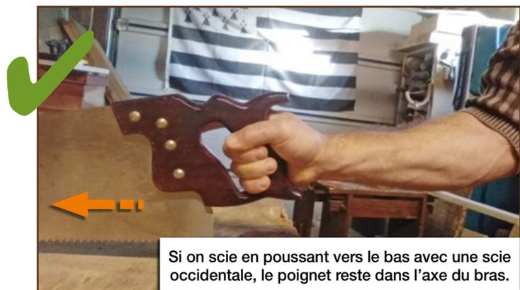
Si on scie en poussant vers le bas avec une scie occidentale, le poignet reste dans l'axe du bras.
