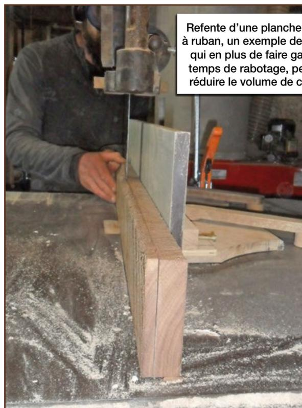
Refente d'une planche à la scie à ruban, un exemple de méthode qui en plus de faire gagner du temps de rabotage, permet de réduire le volume de copeaux.
