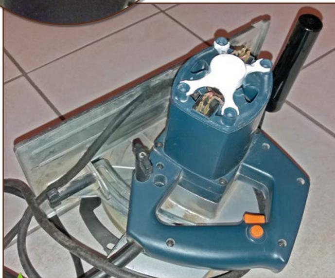
Pour ceux qui sont doués en informatique, l'impression 3D peut être un excellent moyen de réparation. La preuve avec cette pièce fabriquée pour héberger un roulement arrière de scie circulaire. Même sur un élément aussi sollicité, ça tient. Et quand bien même la durée de vie de la pièce serait inférieure à celle de l'originale (moulée avec le carter), une fois le fichier informatique dessiné, réimprimer est aisé et d'un coût modeste.
