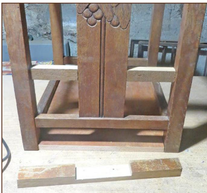
Sur ces mêmes tasseaux utilisés pour la façade avant, on cloue un second tasseau qui va servir à soutenir chaque étage de tiroirs. On le positionne un peu en retrait en fonction de l'épaisseur du contreplaqué utilisé. Une seconde option aurait été de faire une feuillure à la défonceuse. Pour les tasseaux de la façade arrière, on les positionne au même niveau que le second tasseau. Pour les fixer aux dossiers, pré-percez puis clouez.
