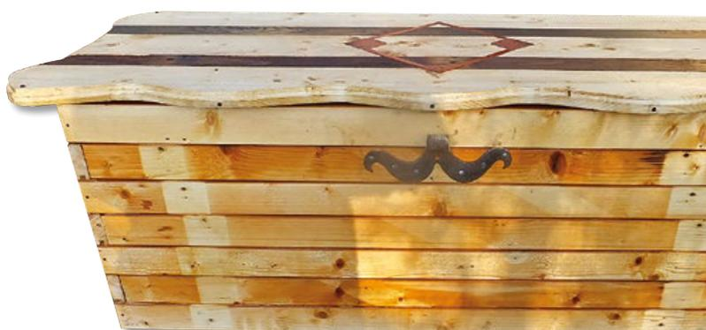
Pour réaliser les faces et côtés de ce coffre, j'ai assemblé alternativement des lames de deux dimensions différentes, une de longueur X, l'autre de longueur X - 2 x l'épaisseur du bois utilisé. On commence par une lame longue pour la façade avant et arrière et une lame courte pour les façades latérales. Pour faire office de charnières, j'ai réutilisé des gonds des volets en formant deux couples liés par un boulon.
