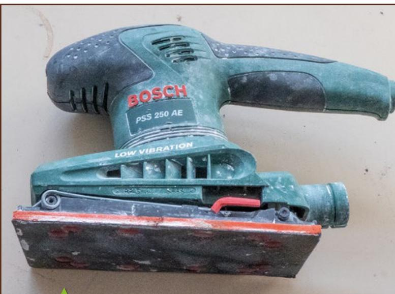
Voici typiquement une ponceuse qui a souffert en travaillant sur du plâtre, et qui n'a pas été nettoyée. Avant même l'ouverture du boîtier on peut parier que les bobinages sont pleins de poussière de plâtre et ont dû chauffer.
