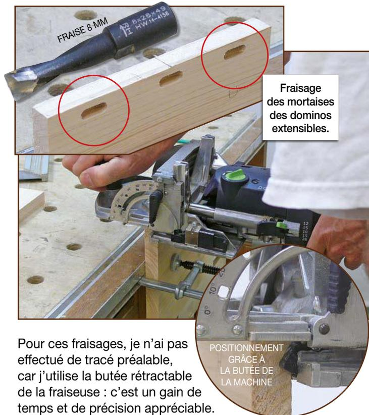
Pour ces fraisages, je n'ai pas effectué de tracé préalable, car j'utilise la butée rétractable de la fraiseuse : c'est un gain de temps et de précision appréciable. Je mets ensuite en place les dominos expansibles (5).
