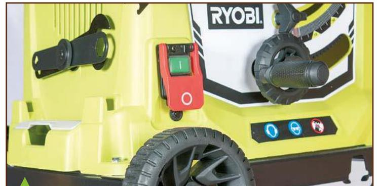
Bel exemple d'un interrupteur coup de genou inaccessible : celui de la Ryobi, pour cause d'encombrement. Ce n'est pas mieux pour la Bosch bleue (rebord du carter juste en dessous) et AEG (trop haut, juste en dessous la table). Seul celui de la DeWalt est vraiment accessible en urgence autrement qu'à la main. Les trois autres scies n'ont pas de coup de genou.
