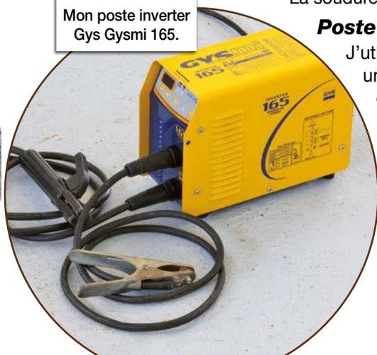
Pour notre usage, il n'est pas nécessaire de disposer d'un poste puissant. On va simplement lui demander de pouvoir souder en continu à une centaine d'ampères, ce qui est suffisant pour utiliser des électrodes de  $\varnothing 2,5$  mm.
