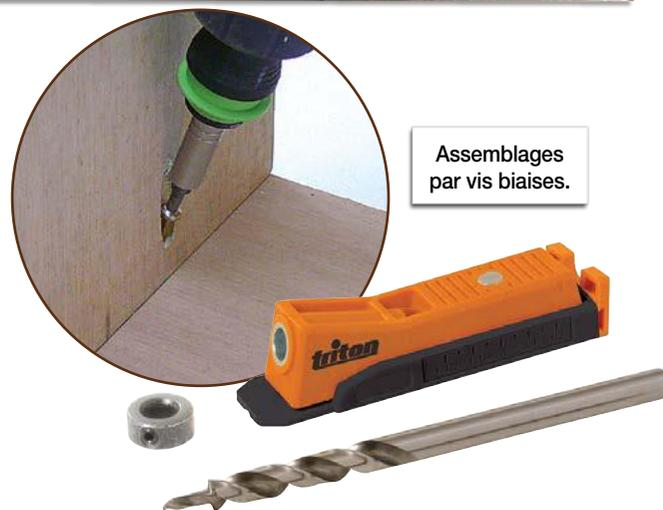
Assemblages par vis biaises.
