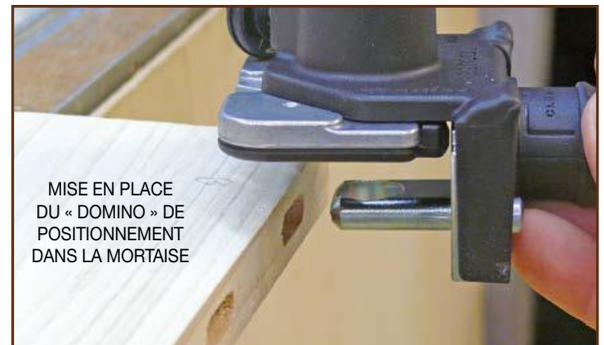
MISE EN PLACE DU « DOMINO » DE POSITIONNEMENT DANS LA MORTAISE
