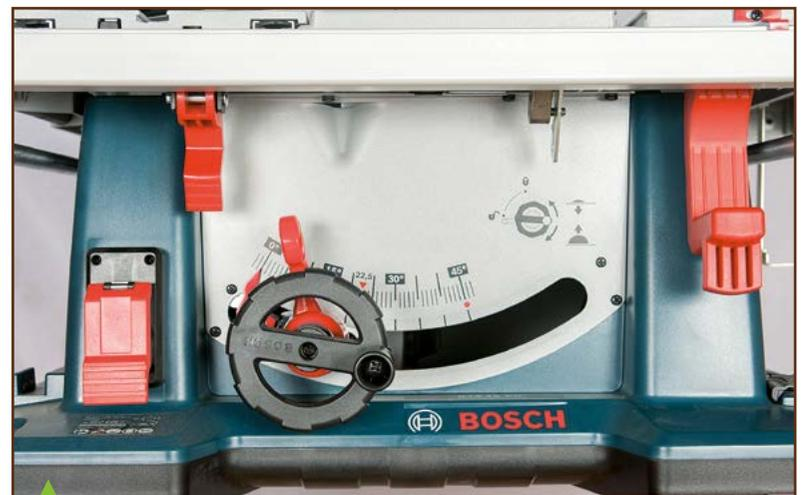
Sur la Bosch bleue (et la DeWalt), le verrouillage d'inclinaison et la manivelle de montée/descente sont placés l'un derrière l'autre. Le réglage d'inclinaison s'effectue à la volée sur ces deux machines. Notez en haut à gauche le levier de blocage du chariot, et en haut à droite celui de blocage de l'extension latérale.
