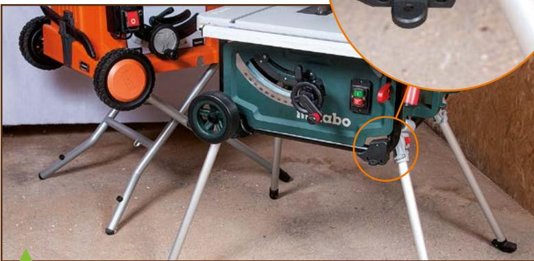
Les piétements de l'AEG et de la Metabo sont complètement intégrés au carter de ces scies. Sur l'AEG, il reste aisément démontable. Mais si l'on veut fixer la Metabo à l'aide de ses pattes de boulonnage, les pieds resteront, sauf démontage important, rangés sous la machine.
