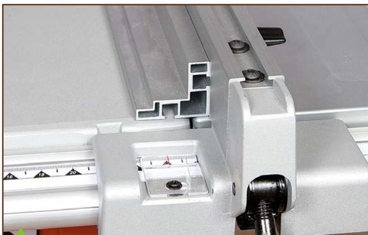
La joue de l'AEG, de la Bosch bleue et de la Ryobi se positionne uniquement à plat, avec deux possibilités dans le cas de la première : le profilé comporte une feuillure supplémentaire sur l'une de ses ailes. La joue de la Bosch verte est un curieux montage qui se clipse à cheval sur le guide (cf. photo de ce dernier).
