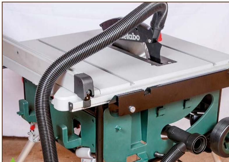
L'aspiration est l'un des points forts de la Metabo : un tuyau et un Y sont fournis d'office pour raccorder simultanément le carter de lame et la cape. Or, vu le manque de standardisation des aspirations, dénicher les diamètres idoines pour les machines dépourvues de ces accessoires peut être délicat. Pour la Ryobi et la Bosch verte, sans prise d'aspiration sur la cape, la question ne se pose même pas.
