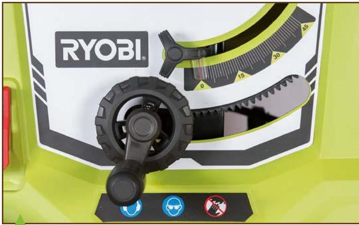
Sur les autres machines, le basculement est contrôlé par un système à crémaillère. C'est cette fois le volant d'inclinaison qui se trouve en arrière de la manivelle de montée/descente, et le verrouillage de l'inclinaison est indépendant.
