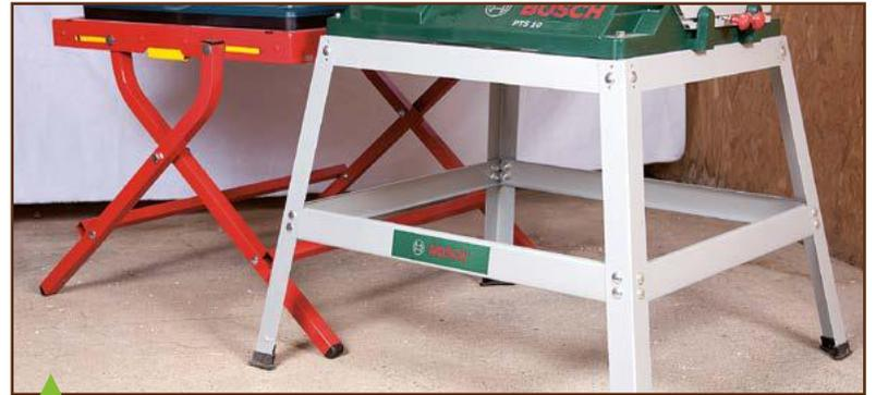
Les piétements reçus avec les scies Bosch ne sont pas ceux que j'attendais. Celui de la bleue, quoique repliable, n'a pas de roues. Et celui de la verte est un simple assemblage statique de cornières en tôle.
