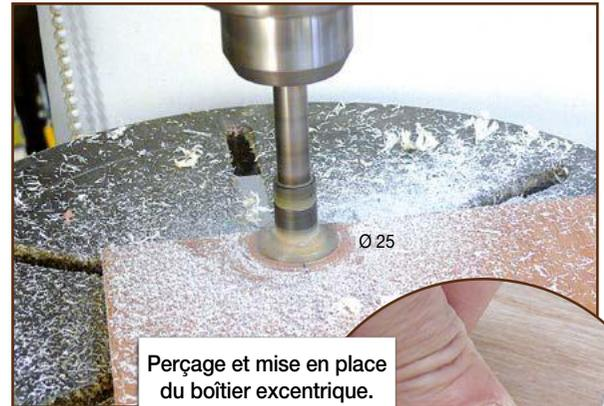
Perçage et mise en place du boîtier excentrique.
