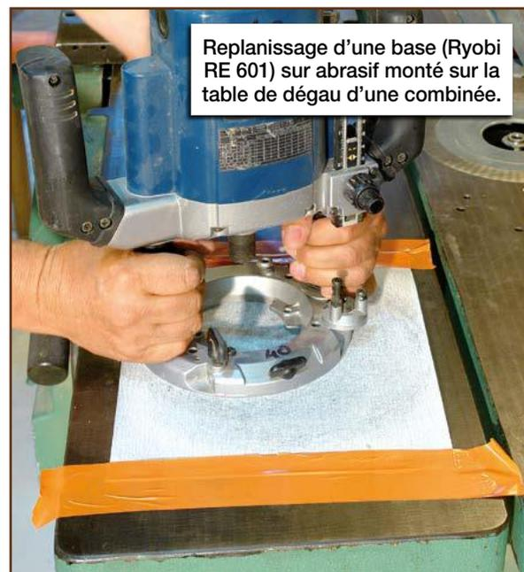
Replanissage d'une base (Ryobi RE 601) sur abrasif monté sur la table de dégau d'une combinée.
