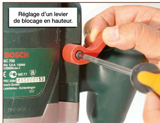
Réglage d'un levier de blocage en hauteur.
