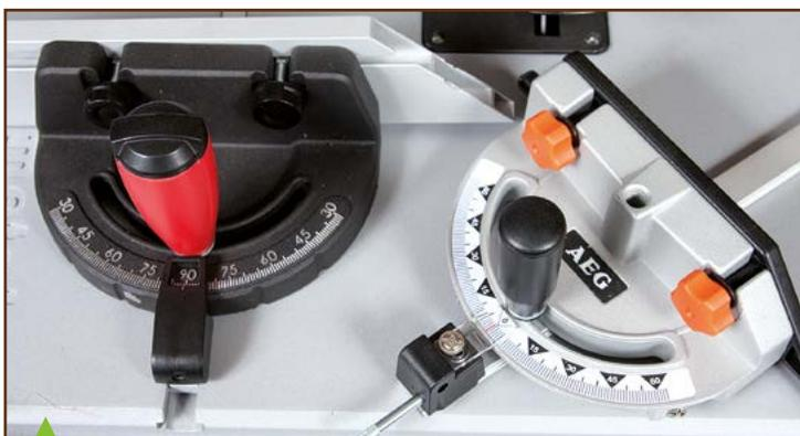
Les guides d'onglet d'AEG et Metabo présentent la particularité d'aller au-delà de 60° là où tous les autres se limitent à 45°. Détail amusant, ces deux guides sont gradués dans des logiques inverses : le 0° de l'un est le 90° de l'autre, et donc 60° pour l'un est 30° pour l'autre.
