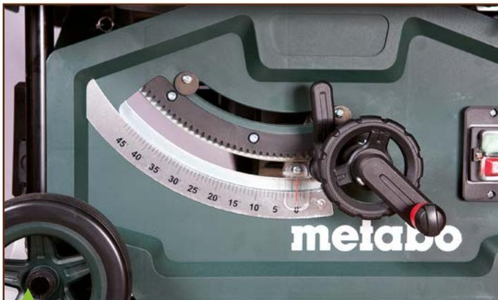
La Metabo est la seule machine dont le moteur se trouve à droite de la lame ; la commande d'inclinaison va donc vers la gauche, et la lame bascule vers la droite. Notez que, pour la même raison, l'interrupteur se trouve à droite.
