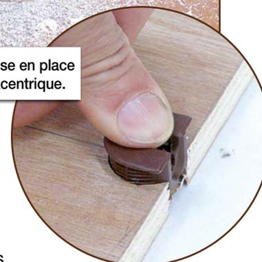
Mettre ensuite en place les boîtiers excentriques. Il ne reste plus qu'à assembler les deux pièces et à faire tourner les boîtiers excentriques pour finaliser l'assemblage. Le montage et le démontage sont très aisés.
