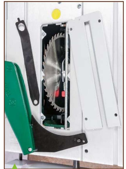
Les deux Bosch et la Metabo sont équipés d'un levier de blocage d'arbre et le démontage de la lame ne requiert qu'une seule clef de service. Mais le couteau diviseur de la Bosch verte n'est absolument pas réglable.
