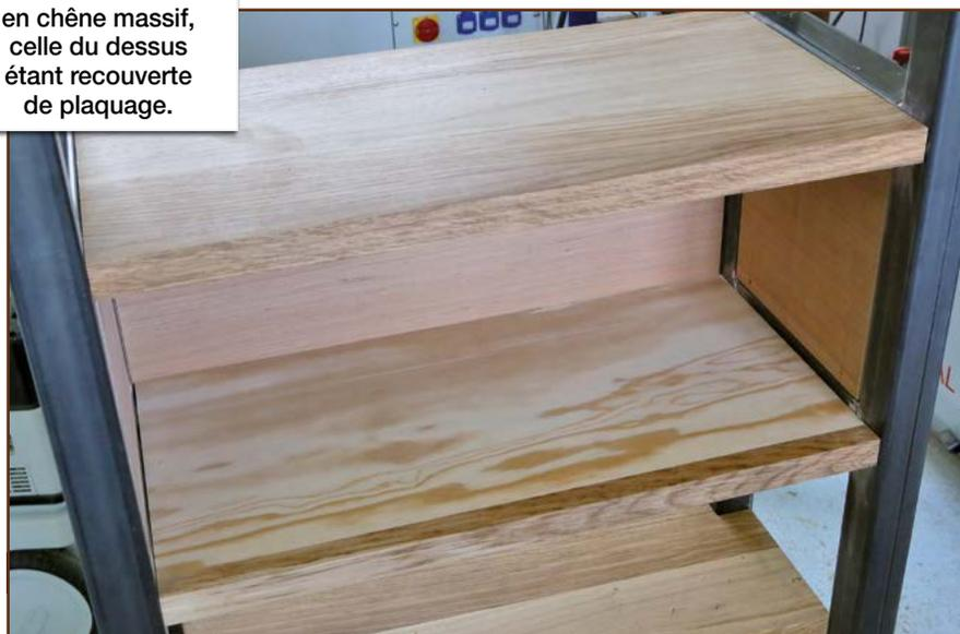
Les caissons centraux sont principalement fabriqués en contreplaqué, tant pour les dessus et dessous que pour les flancs. Pour ces derniers, il y a eu du changement en cours de fabrication, d'où la superposition de deux épaisseurs de contreplaqué côté intérieur. Pour faire plus simple, vous pouvez vous contenter de découper les flancs dans votre panneau massif, et vous les fixerez par l'intérieur sur des tasseaux affleurants (voir schéma ci-dessous).
