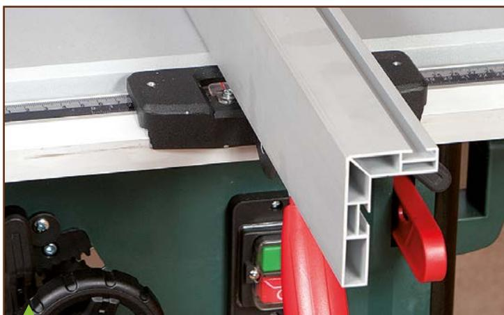
La joue de la Metabo et de la Einhell peut se placer soit à plat soit comme sur la photo à cheval sur le guide. En la plaçant ainsi en avant de l'axe de lame, elle permet alors de refendre un bois nerveux en toute sécurité.
