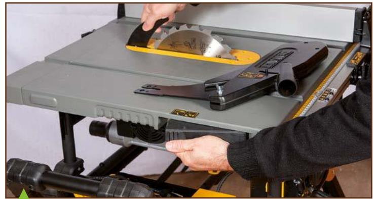
Sur la DeWalt, une ingénieuse commande par câble permet d'installer sans démontage l'un ou l'autre des deux couteaux diviseurs fournis. Le levier se trouve sur le côté gauche de la machine.
