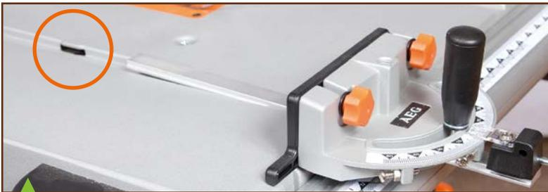
La rainure de table de l'AEG n'est en T qu'à trois endroits de la table. Avec sa tige plutôt courte, le guide d'onglet se déséquilibre lorsqu'il est placé en bord de table.
