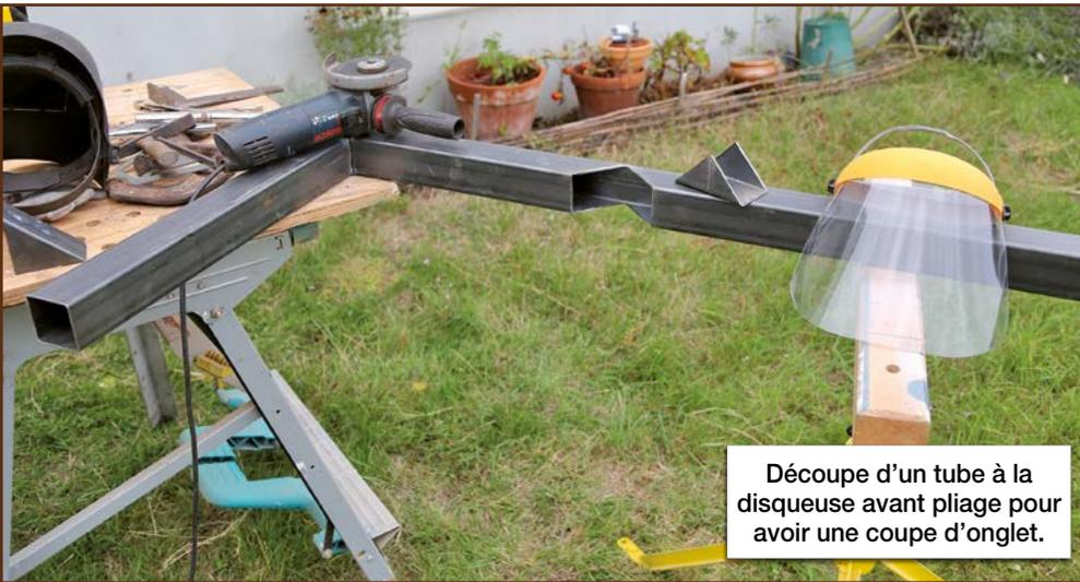
Découpe d'un tube à la disquieuse avant pliage pour avoir une coupe d'onglet.
