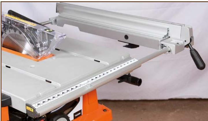
• **DeWalt** : la règle est moulée avec la table, et le guide est solidaire de deux profilés aluminium qui coulissent simultanément de gauche à droite grâce à une unique molette actionnant un système de crémaillères. Le mouvement, fluide et aisé, contrôle donc simultanément l'avant et l'arrière, avec très peu de jeu. Un levier verrouille l'ensemble à la position choisie.
