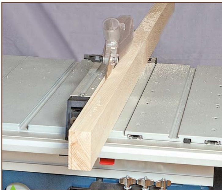
Un test de puissance en délignage pour solliciter les machines a révélé quelques moteurs un peu faibles, mais aucun n'a pour autant calé. Au contraire, celui de la Bosch bleue (ou son électronique) m'a semblé conçu pour apporter un surcroît de puissance en cas de besoin important ponctuel.
