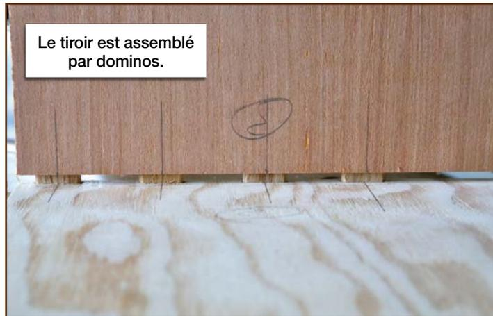
Les côtés sont en 15 mm, 10 mm pour la façade et l'arrière et 5 mm pour le fond.
