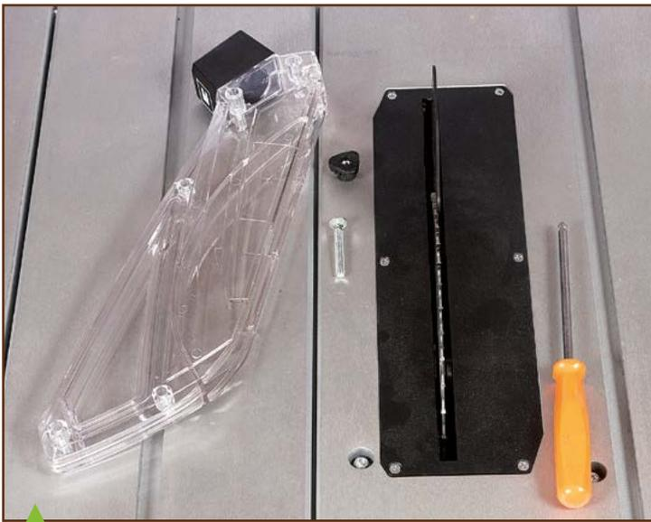
À contrario, l'insert de la Einhell, maintenu par six vis cruciformes est long à retirer. Ici aussi la cape doit être démontée au préalable, en dévissant l'écrou moleté et le boulon qui la maintiennent sur le couteau diviseur.
