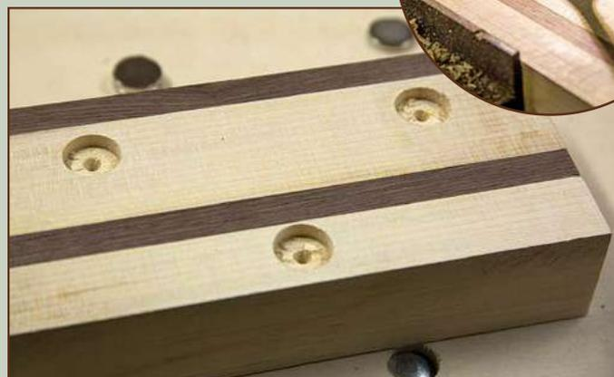
J'utilise une mèche à bois plate, car c'est la seule mèche du diamètre de mon projet dont je dispose (Ø 18 mm). Mais, dans l'idéal, une Forstner ou mèche à façonner est plus adaptée, car, sur des pièces de faible épaisseur, il est possible d'être handicapé par la longue pointe d'une mèche plate, qui risque de traverser. Si vous disposez d'un ensemble de mèches à bouchonner, il est possible également que vous trouviez votre bonheur.
