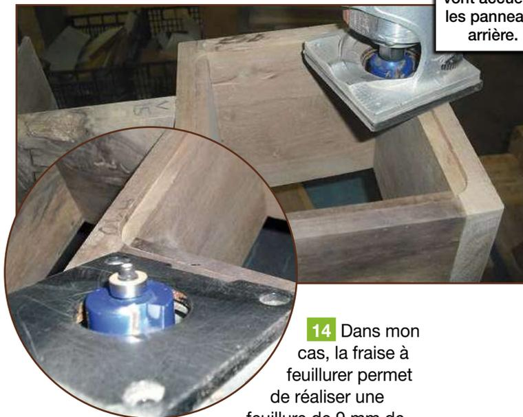
**14** Dans mon cas, la fraise à feuilurer permet de réaliser une feuilure de 9 mm de large. Deux feuilures côte-à-côte ne peuvent donc pas atteindre les 22 mm d'épaisseur de mes montants. Si je veux mettre un seul fond recouvrant plusieurs niches en même temps, il faudra enlever au ciseau à bois les 4 mm restants (22 mm - 2 feuilures de 9 mm).
