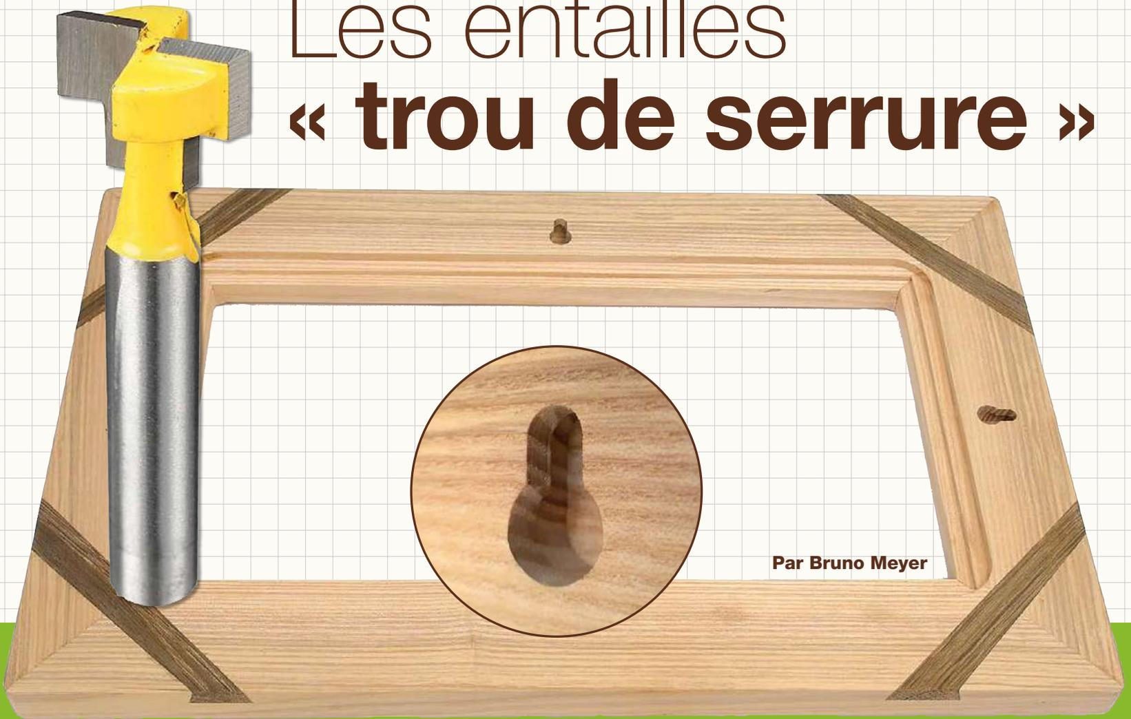
Petites ou grandes, légères ou pesantes, certaines de nos réalisations doivent être fixées au mur. Pour cela, il existe une solution simple : la réalisation d'entailles spécifiques permettant d'accrocher l'ouvrage au mur par des vis. Avec une fraise dédiée assez courante, cette opération est rapide et simple – quand on sait !
