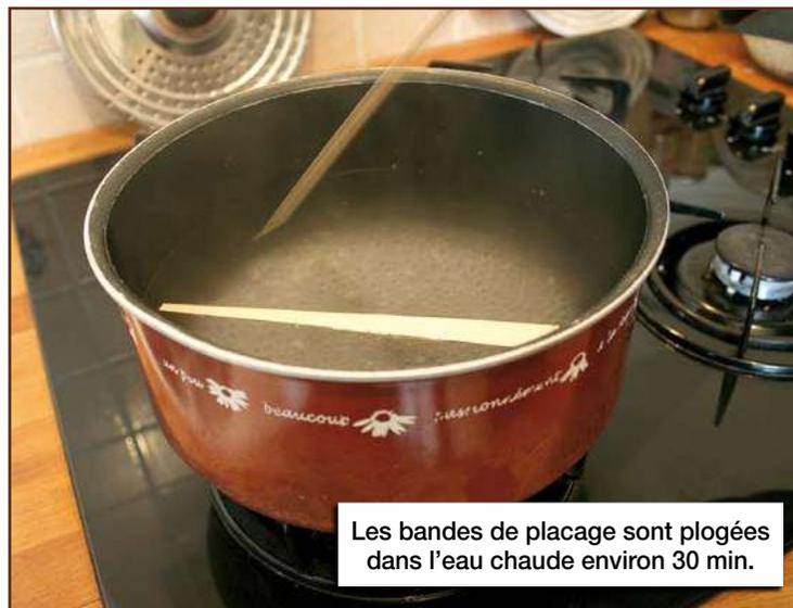
Les bandes de placage sont plogées dans l'eau chaude environ 30 min.
