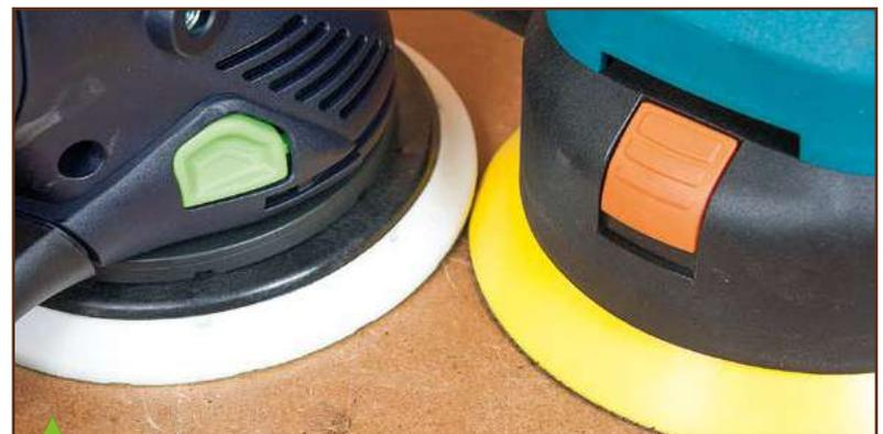
La Festool et la Virutex sont les seules machines équipées d'un poussoir de blocage d'arbre. Il pourrait aussi se justifier sur la Metabo, mais la compacité de la machine ne le permet sans doute pas, d'où son remplacement par une clef de service (fournie, et à ne pas perdre, car il s'agit d'un modèle très plat).
