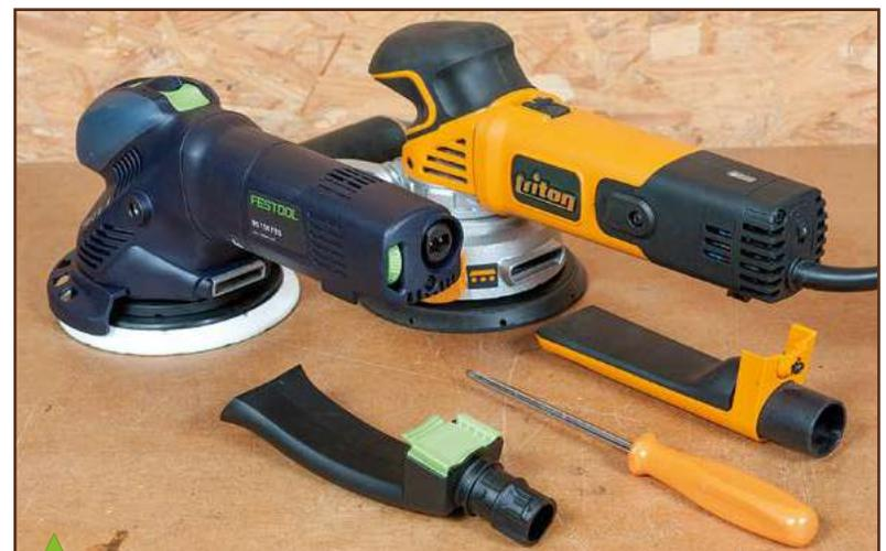
Le bloc de connexion à l'aspirateur de la Festool et de la Triton se démonte aisément : par simple pression sur un bouton (évidemment de couleur verte) pour l'une, par dépose d'une vis cruciforme sur l'autre. Cela doit être intéressant pour un travail de lustrage, qui ne produit pas de poussière, mais cela ne concerne guère les boiseux... À moins de travailler sans aspirateur, mais qu'on ne compte pas sur moi pour y inciter !
