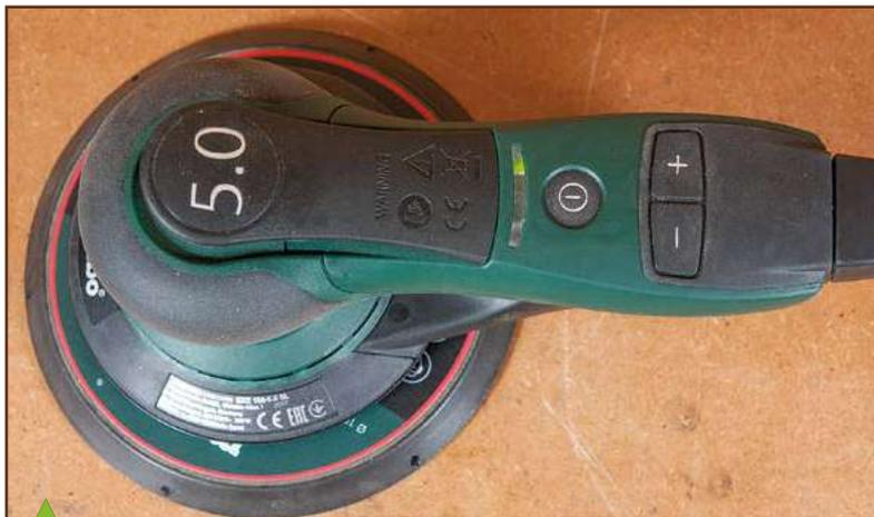
Les commandes de la Metabo sont spécifiques : un interrupteur de mise en marche (avec témoin lumineux), deux boutons pour incrémenter/décroître les six vitesses, et un levier de paume (ou de pouce) pour la mise en rotation. La mention 5.0 sur ce levier indique l'amplitude du mouvement d'oscillation (il existe une version 2,5 mm, moins adaptée aux boiseux que nous sommes).
