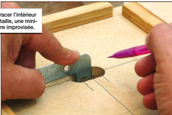
**Notez sur le gabarit** les caractéristiques importantes : grand diamètre de la fraise à trou de serrure, diamètre du guide, profondeur de plongée et modèle de défonceuse si vous en possédez plusieurs (ou l'envisagez). Noter quel usage a ce gabarit n'est pas forcément du temps perdu !
