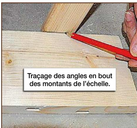
L'angle d'inclinaison de l'échelle est déterminé en plaçant le montant en position contre le lit. L'angle de coupe est tracé en partie basse d'un des montants à l'aide d'une chute posée sur le sol. Les coupes sont réalisées à la scie à coupe d'onglet. L'angle est relevé à l'aide d'une fausse équerre et utilisé pour le traçage des emplacements des barreaux sur les montants de l'échelle.
