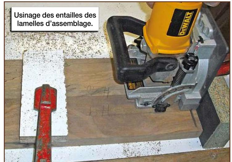
Usinage des entailles des lamelles d'assemblage.
