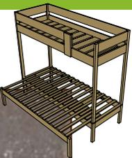
Le montant du garde-corps et la traverse avant, sont percés pour le passage des boulons poêlier. La partie arrière des trous est lamellée au Ø 13 mm pour recevoir rondelles et écrous.
