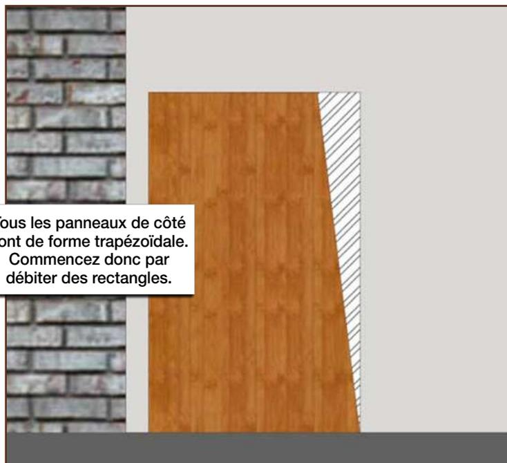
Tous les panneaux de côté sont de forme trapézoïdale. Commencez donc par débiter des rectangles.
