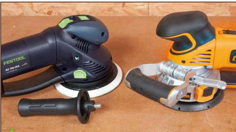
Sur les machines à moteur horizontal, Festool opte pour une poignée latérale de type meuleuse. La solution de Triton est bonne : poignée orientable de gauche à droite et de bas en haut, mais le levier de blocage (ouvert sur la photo) est bien trop dur à manœuvrer !
