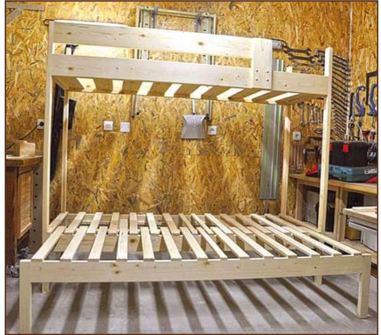
La partie mobile est parfaitement réglée, l'échelle s'adapte exactement à la traverse haute : il est temps de tout démonter pour réaliser les opérations de finition. Prenez soin de bien identifier chaque pièce pour faciliter le remontage. Réalisez enfin un ponçage soigné au grain 150 puis 180 suivi d'un bon époussetage, puis appliquez par exemple un vernis à l'eau avec un pistolet basse pression.
