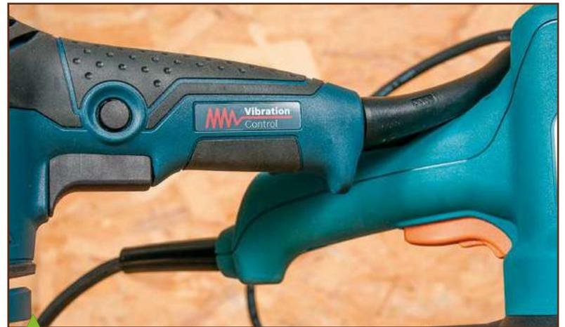
Trois des interrupteurs de type gâchette (ici Bosch) sont verrouillables en marche grâce à un bouton poussoir. Si l'anneau moulé autour du bouton évite tout arrêt intempestif, il complique la manipulation pour les gauchers. La minuscule « gâchette dans la gâchette » de Virutex est ingénieuse et l'ensemble très doux à manœuvrer, quelle que soit la main utilisée.
