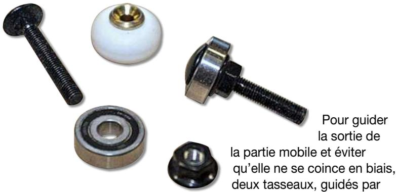
Pour guider la sortie de la partie mobile et éviter qu'elle ne se coince en biais, deux tasseaux, guidés par deux roulements à billes, sont fixés sous les lattes mobiles. Deux butées de fin de course sont également installées (sur la même platine que les roulements).
