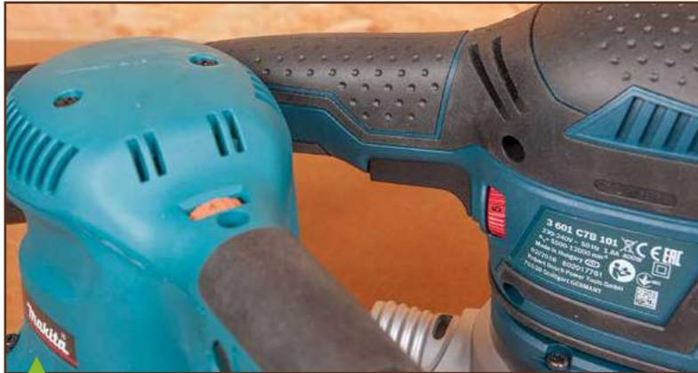
Le variateur de vitesse de la Bosch est inhabituellement placé sur le côté droit de la machine : c'est ingénieux, car il est ainsi aisé à manipuler même en marche, d'un doigt de la main qui tient la poignée. Il en est de même pour le variateur de Makita, placé sur le dessus. Avec les autres machines, il faudra utiliser la seconde main.
