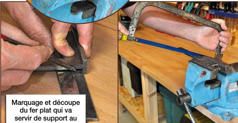
Marquage et découpe du fer plat qui va servir de support au roulement et à la butée.
