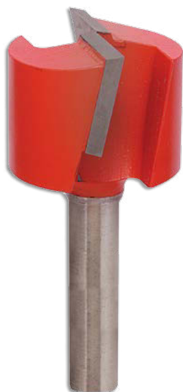
Une fraise à surfacer. Remarquez les plaquettes carbure inclinées pour une meilleure coupe fauchante.
