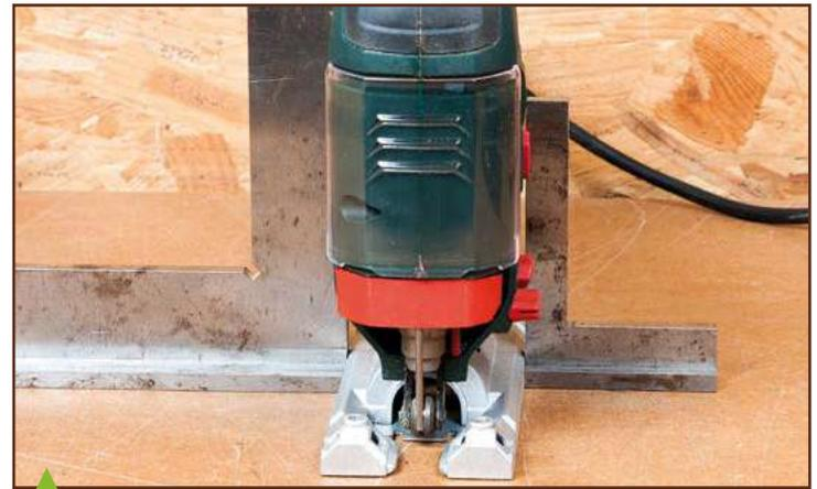
**Sur un chantier d'agencement, il peut être utile de guider une machine contre une cloison ou un rebord de meuble. Toutes les machines ne le peuvent hélas pas, et c'est vraiment dommage quand la gêne n'est due qu'à la saillie des boutons de commande.**
