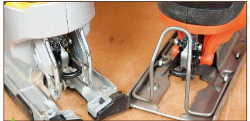
Solution originale mais pertinente, adoptée par Stanley et Black+Decker, la commande de changement de lame ne se fait pas par une bague entourant l'axe, mais par un petit levier qui se soulève aisément d'un doigt.
