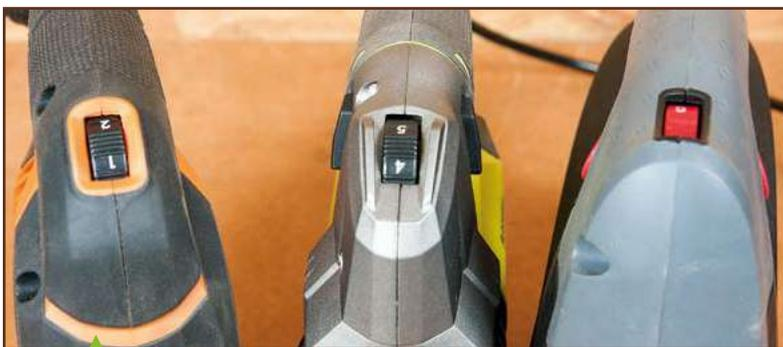
**Sur une scie à poignée étrier, l'avant de la machine est le meilleur emplacement possible pour le variateur : il est ainsi immédiatement accessible en cours de travail par le pouce de la main qui tient la scie. Utile par exemple lorsqu'on s'aperçoit que l'on est en train de faire fondre le PVC d'un gabarit en cours de fabrication !**
