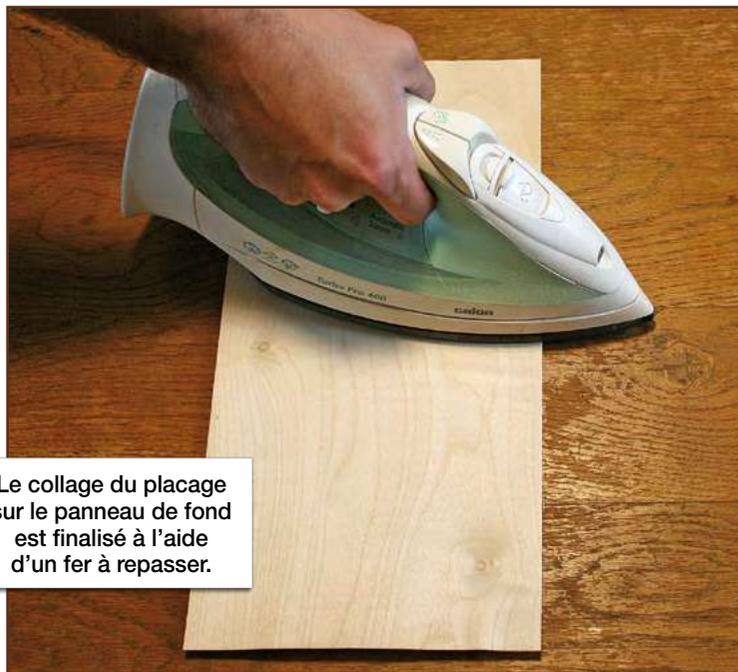
Le collage du placage sur le panneau de fond est finalisé à l'aide d'un fer à repasser.
