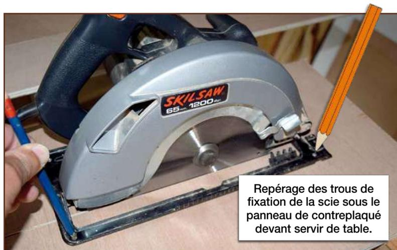
Repérage des trous de fixation de la scie sous le panneau de contreplaqué devant servir de table.
