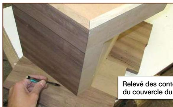
**39** Prolongez avec une règle les tracés de côtés p4 et p5 jusqu'à l'intersection des deux.
