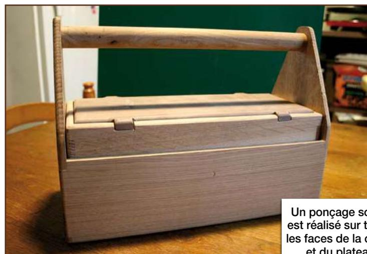
Un ponçage soigné est réalisé sur toutes les faces de la caisse et du plateau.
