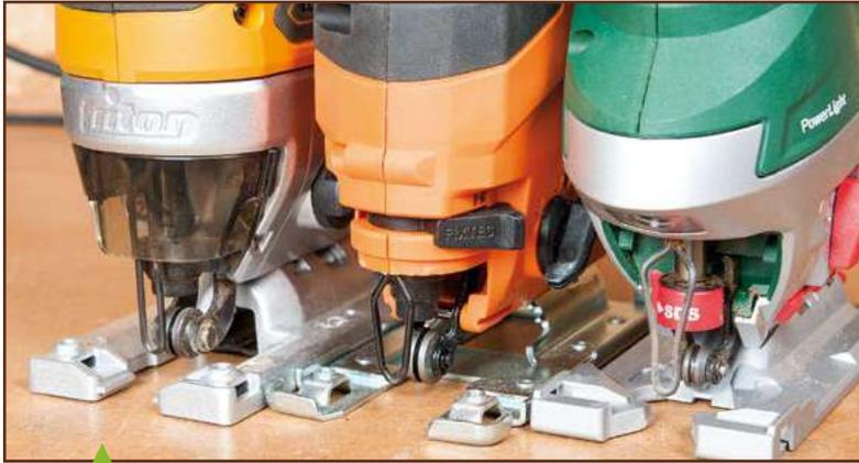
**Le changement rapide de lame par rotation horizontale est le plus choisi par les fabricants, avec diverses variantes. La lame étant toujours éjectée lors du retrait, il vaut mieux la tenir (sans se brûler si elle vient de servir !) : sa projection sur un sol en béton n'en améliore pas l'affûtage !**
