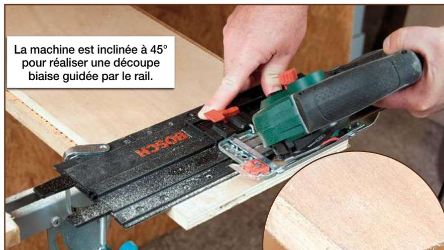
La machine est inclinée à 45° pour réaliser une découpe biseau guidée par le rail.
