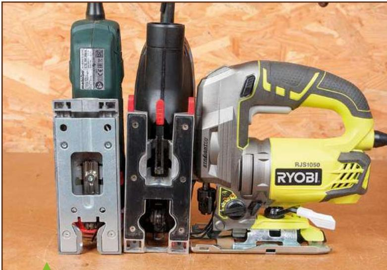
La Metabo, la Bosch bleue et la Black+Decker requièrent un outil pour incliner la machine, par le dessous de la semelle. Le réglage de la Skil et de la Bosch verte conserve le même principe, la vis étant directement équipée d'un levier. Sur les autres (ici Ryobi), le levier, situé sous le moteur, est aisément accessible sans retourner la machine.
