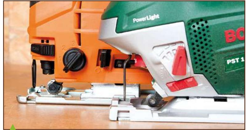
**La commande du mouvement pendulaire, généralement à quatre positions (sauf, Skil, qui en ajoute une), se trouve toujours juste à l'arrière de la lame sur le côté gauche, accompagnée de l'interrupteur de soufflerie lorsqu'il y en a une (sauf DeWalt, sur la face opposée).**
