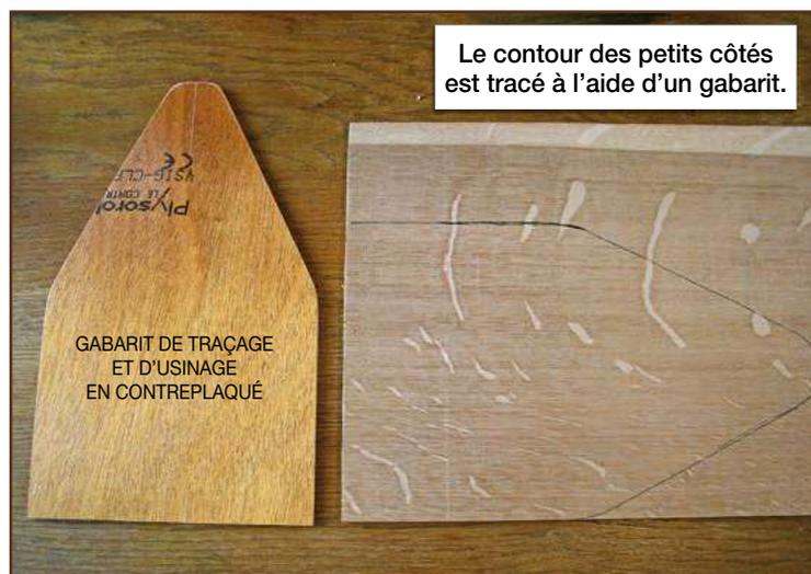
**5** Réalisez la découpe des deux panneaux à la scie sauteuse en laissant une surcote d'environ 2 à 3 mm pour permettre le détournage à la défonceuse.
