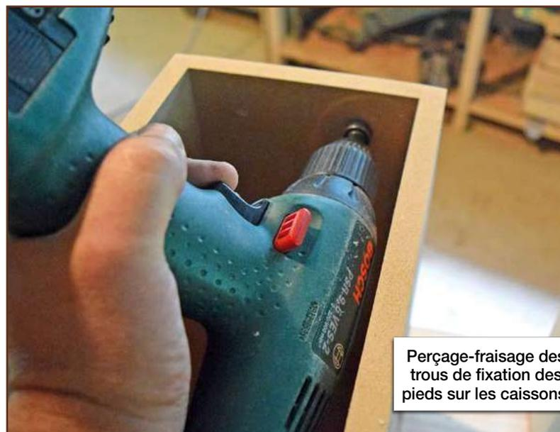
Perçage-fraisage des trous de fixation des pieds sur les caissons.
