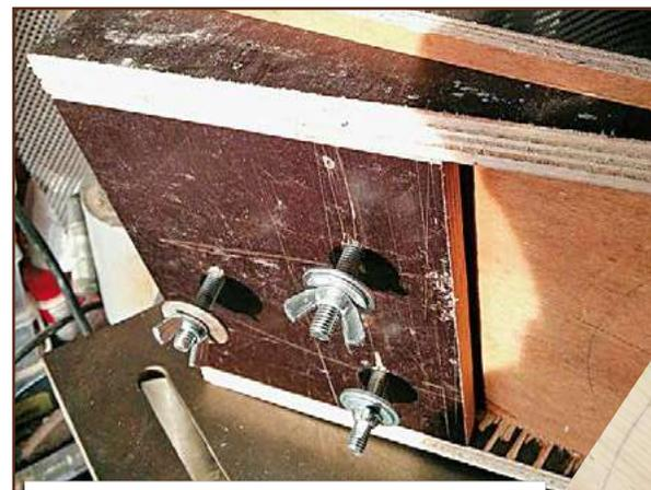
Trois vis TRCC assurent la fixation du plan incliné sur la table de la perceuse.
