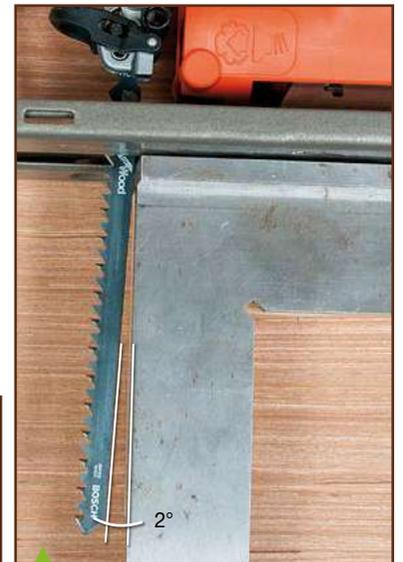
La lame inclinée ne permet pas un parfait raccord de coupe dans les angles chez Stanley et Black+Decker, à moins de soulever l'arrière de la scie.
