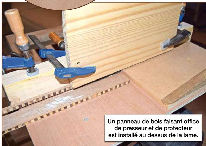
Un panneau de bois faisant office de presseur et de protecteur est installé au dessus de la lame.
