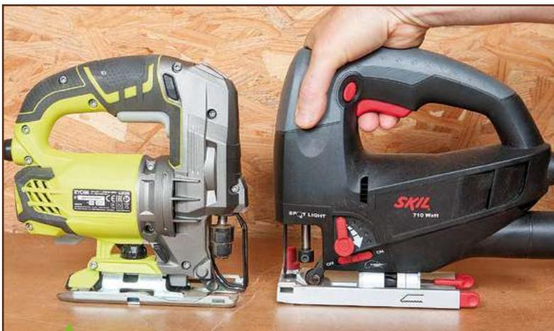
**Skil a manifestement compris l'intérêt de tenir la machine par l'avant, à l'aplomb de la lame, pour chantourner : le corps est moulé pour recevoir les doigts, la gâchette et son blocage tombent bien sous la main. A contrario la Ryobi, de forme anguleuse et peu confortable à cet endroit, n'est guère conçue pour cela.**
