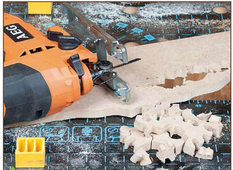
**Le test en chantournage est avant tout un test de vélocité : plus la coupe est tortueuse et plus les courbes sont serrées, plus la machine doit être mobile ; la compacité de l'outil est ici un sérieux atout.**
