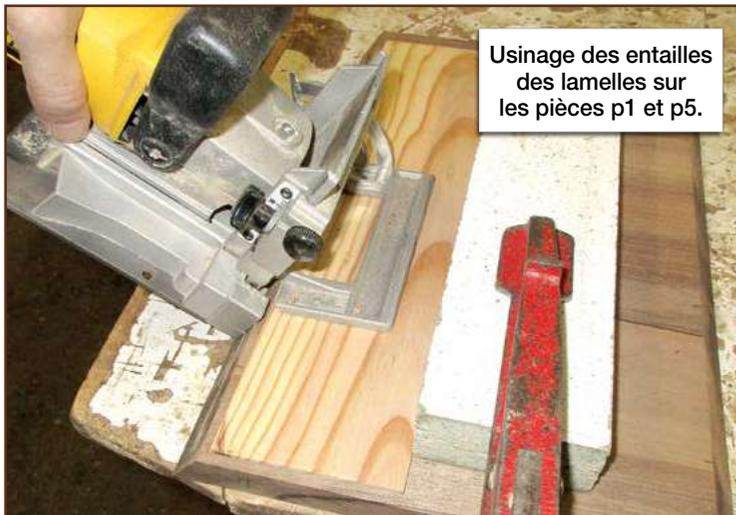
Usinage des entailles des lamelles sur les pièces p1 et p5.
