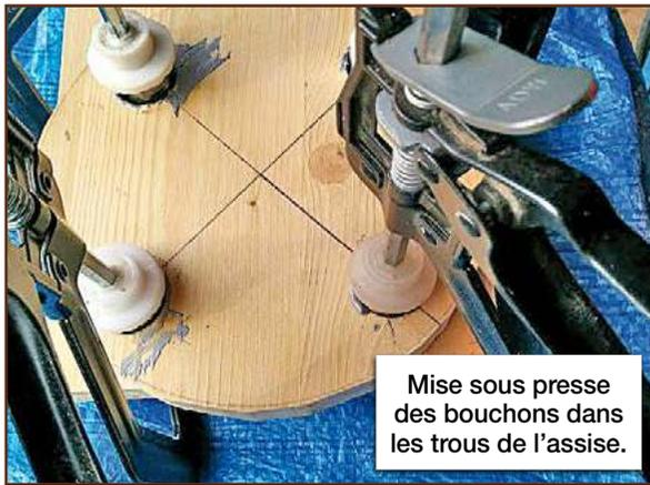
Mise sous presse des bouchons dans les trous de l'assise.
