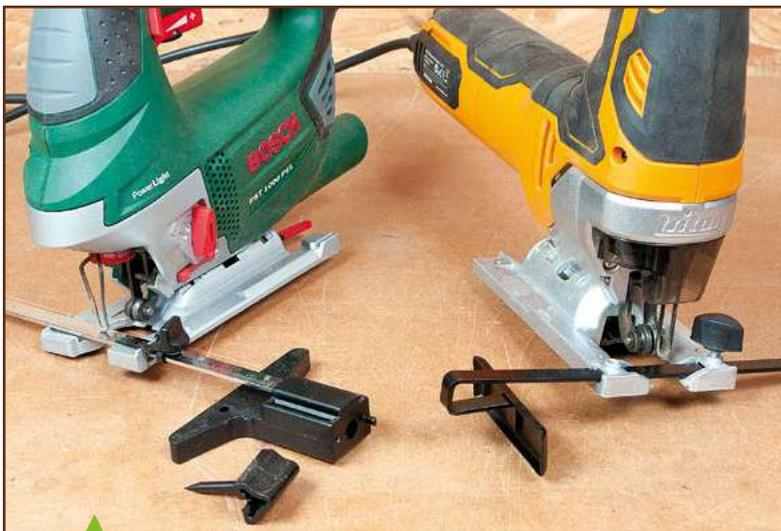
Bosch (vert) et Triton livrent de série un guide parallèle. Celui de Bosch inclut même un pivot pour utilisation en compas : l'un des clips en plastique qui le maintiennent dans son logement a cassé dès le premier démontage.
