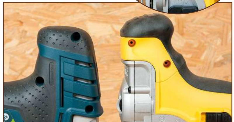
**Pour chantourner aisément des courbes serrées, la tenue de la scie est bien plus confortable par le champignon que par le moteur, trop en arrière de la lame. La forme des champignons de la Bosch et de la Metabo ne facilite pas leur maniement par ce seul point de tenue, au contraire de celui de DeWalt, très facile à guider par l'arrière.**
