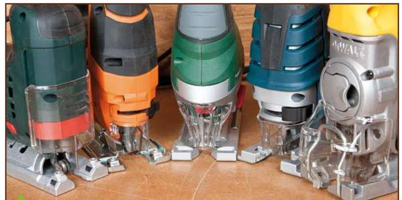
Quatre fabricants fournissent un protecteur clipsable à l'avant de la machine. Et chez Metabo, ce protecteur est installé à demeure et coulisse de haut en bas en fonction des besoins. Un protecteur existe aussi chez Triton, mais, solidaire du changement de lame, il ne couvre que la partie haute de cette dernière.
