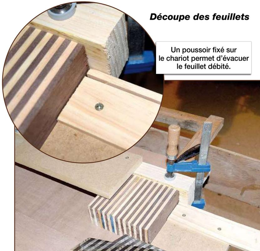
à bien conserver l'alternance des couleurs ! Pensez aussi à utiliser du papier de protection pour éviter que le sandwich se retrouve collé au montage ou aux cales de serrage.
