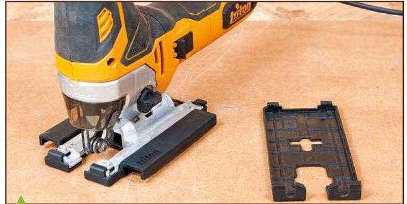
Six des fabricants livrent leur scie avec une semelle additionnelle en plastique améliorant la stabilité de la machine. Triton fournit en outre une semelle permettant le guidage ; le rail n'est pas livré, mais il serait aisé de le fabriquer avec un tasseau et une bande de contreplaqué.
