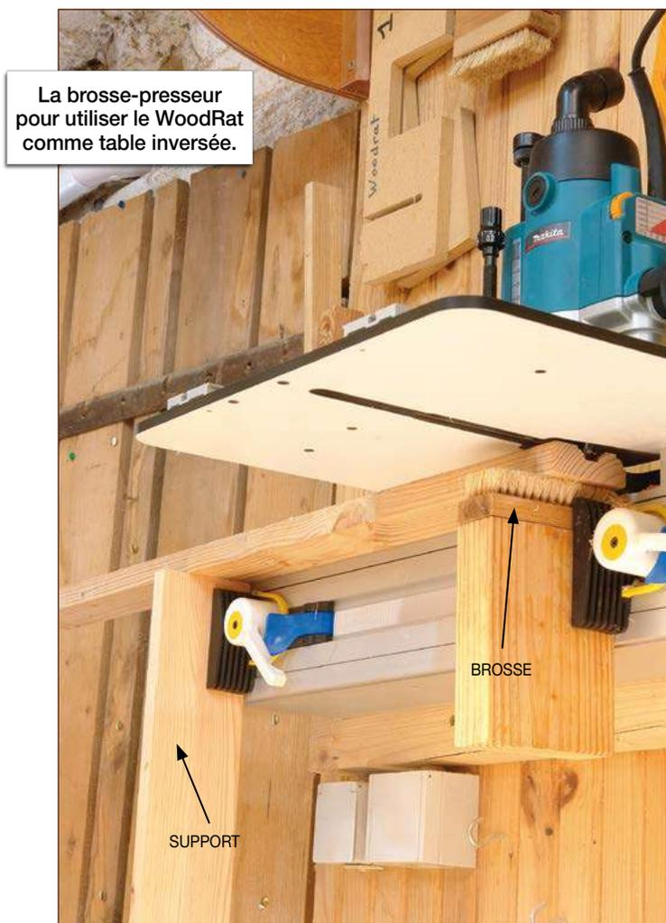
Il fallait juste y penser ! En plus, ce système est antirejet. Un bout de bois quelconque, serré dans la presse gauche, supporte l'arrière de la pièce. Le WoodRat fonctionne alors comme une table de défonceuse retournée tête en bas. Là, plus question de travail en avalant : la pièce doit être poussée de gauche à droite : logiquement le sens contraire de celui d'une table classique.
