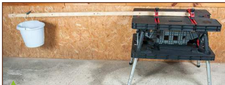
Le Keter est champion toutes catégories lors des tests de basculement transversal : le tasseau auquel est suspendu le seau d'eau commence même à ployer avant que l'établi ne bascule.
