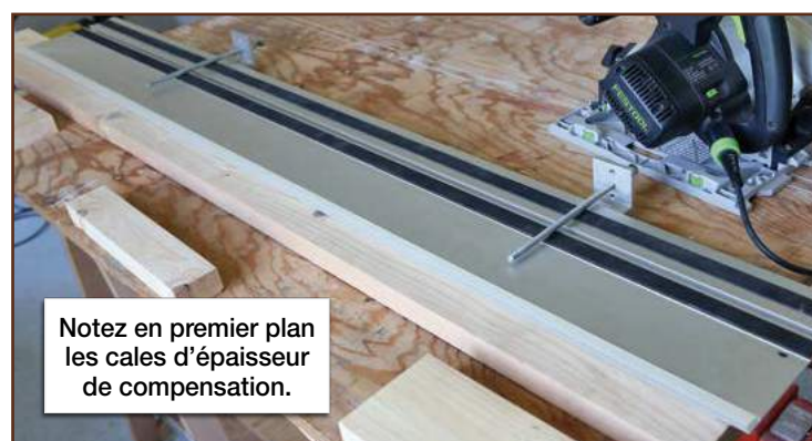
Simple et efficace ! La cornière pourrait parfaitement être remplacée par une chute de bois.
