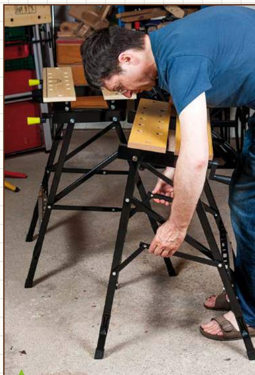
Les deux piétements les plus simples, le Ryobi « RWB02 » et le Noname, se referment simplement en repliant les traverses latérales inférieures, articulées en compas.
