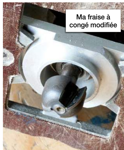
Mon jeu de roulements qui me permettent de faire des rainures de 12, 8 et 6 mm de profondeur.
