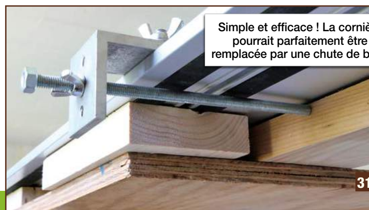
Notez en premier plan les cales d'épaisseur de compensation.
