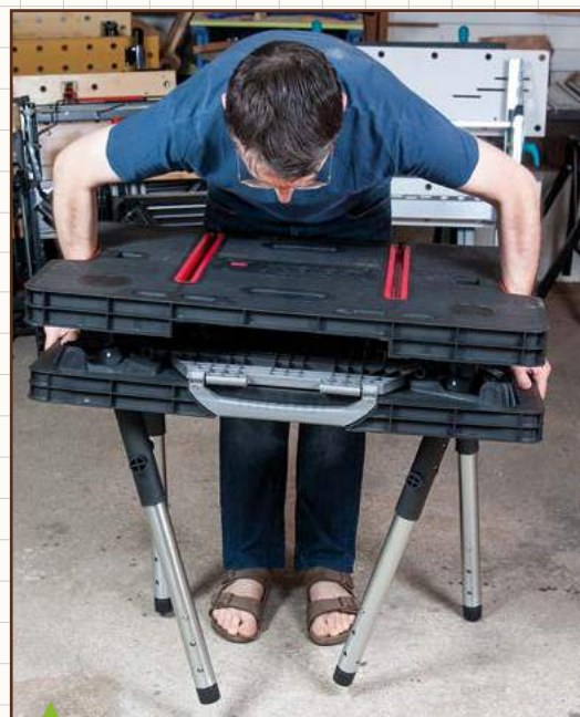
Le Keter se replie en une seule opération... à condition d'être en position basse, sinon il faut au préalable ramener ses pieds un par un à longueur minimale pour qu'ils s'intègrent directement dans leur logement, sous le plateau inférieur. À noter : Keter a prévu des anneaux permettant de fixer une sangle (non fournie) pour transporter l'établi replié.
