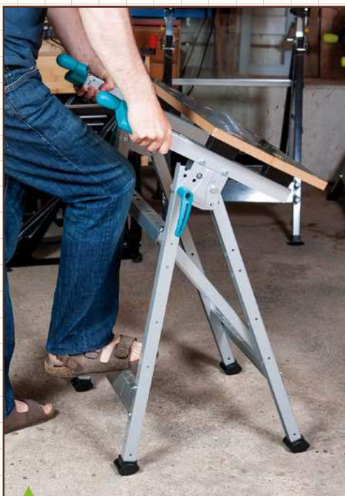
Après desserrage des leviers latéraux de blocage, le « Master 200 » requiert d'avoir pris le coup de main pour débloquent d'un coup sec le plateau : je suis loin d'y être toujours parvenu du premier coup ! La réouverture est heureusement plus aisée.
