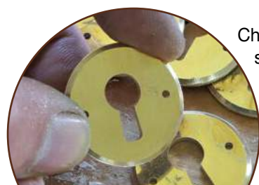
Les entrées de serrures fraisées dans une tôle de laiton de 1,5 mm.
