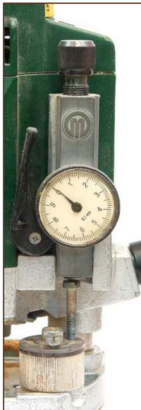
La butée micrométrique et le micrométrique de profondeur : deux commodités qui n'ont pas tout à fait le même usage.
