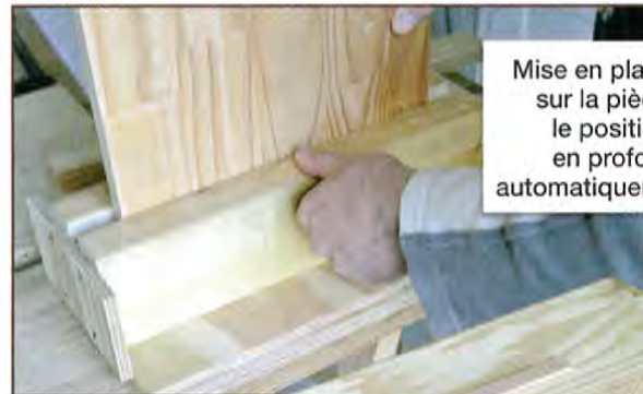
La cale de positionnement en profondeur de la pièce dans le gabarit.
