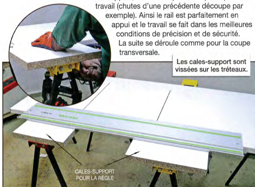
Les scies plongantes sur rail permettent de réaliser facilement les découpes arrêtées.
