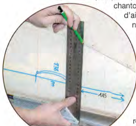
Tracé des repères pour le chantournement des pieds.
