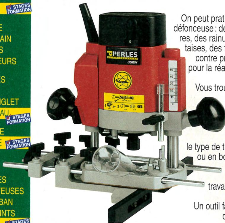
On peut pratiquement tout faire avec une défonceuse : des assemblages, des moulures, des rainures, des feuillures, des mortaises, des tenons, plates-bandes, profil contre profil, des coupes d'onglets... pour la réalisation de quantité d'objets, mobilier et autres.
