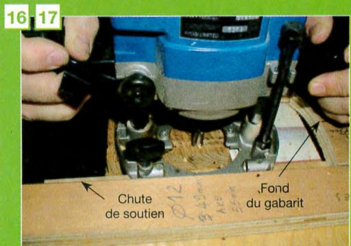
**17** Réglez la profondeur d'usinage à 7 mm environ et réalisez la rainure en deux passes, en partant de l'ouverture du U et en progressant vers le fond (il s'agira en fait d'une « feuilure » car elle va venir jusqu'à l'extrémité de la pièce).
