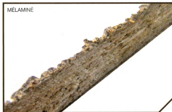
– La sciure doit pouvoir être évacuée le plus rapidement possible. En effet, en s'accumulant, la sciure pourrait provoquer un « bourrage », puis un échauffement et une déformation de la lame (rappelons qu'une scie circulaire portative tourne entre 2 000 et 6 000 tours/minutes !). Ce type de situation peut provoquer également un blocage de la lame dans le matériau et donc être une source d'accident.
