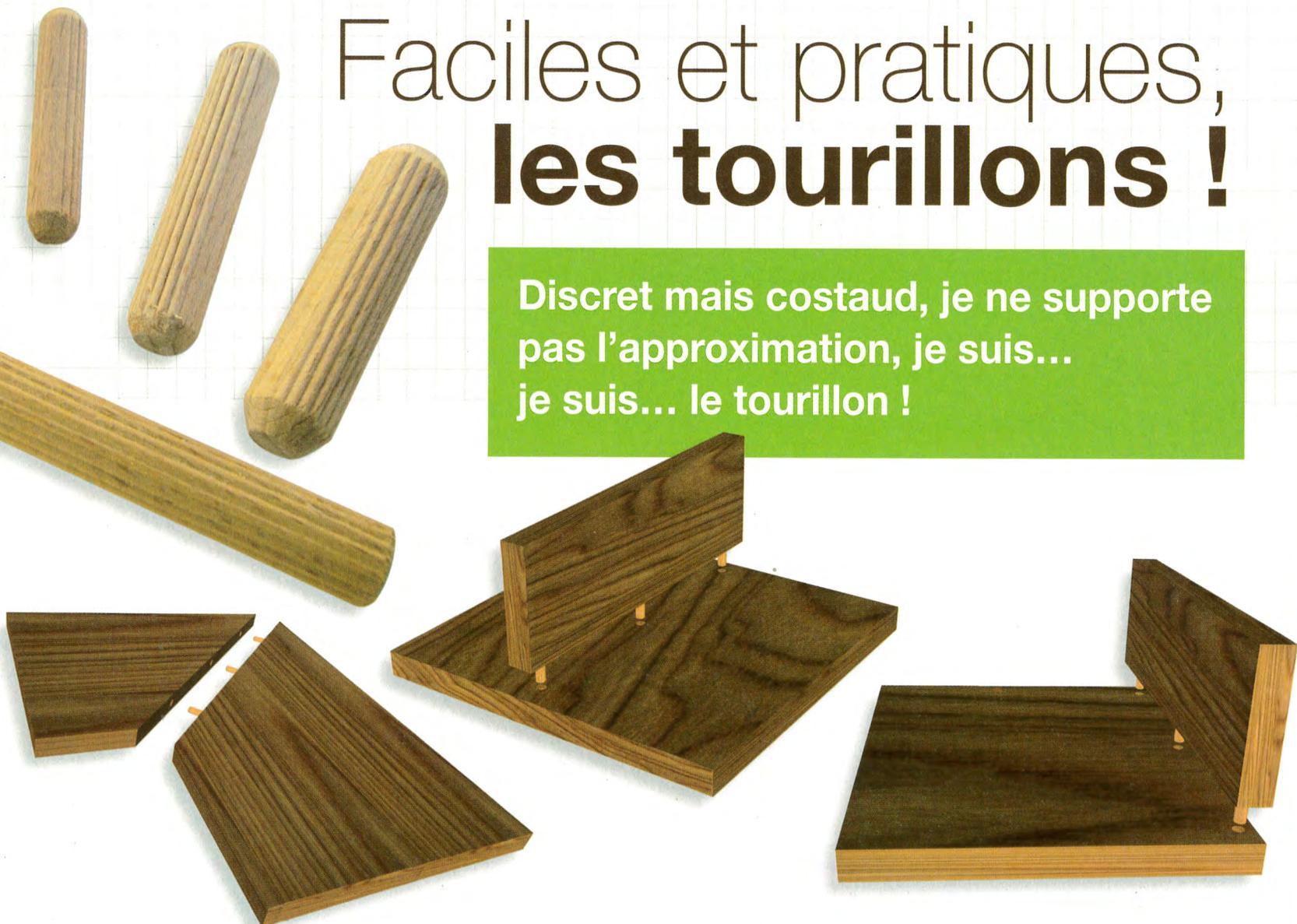
Discretion, robustesse, précision : voici résumées les trois caractéristiques principales d'un assemblage par tourillons. Le tourillonnage consiste à **créer un lien invisible et le plus solide possible entre deux pièces**. Pour réaliser ce lien, on utilise de petits cylindres de bois qu'on appelle des tourillons et qu'il va s'agir d'insérer sur une partie de leur longueur dans chacune des pièces à assembler. L'ensemble sera collé pour assurer un maintien ferme et définitif.
