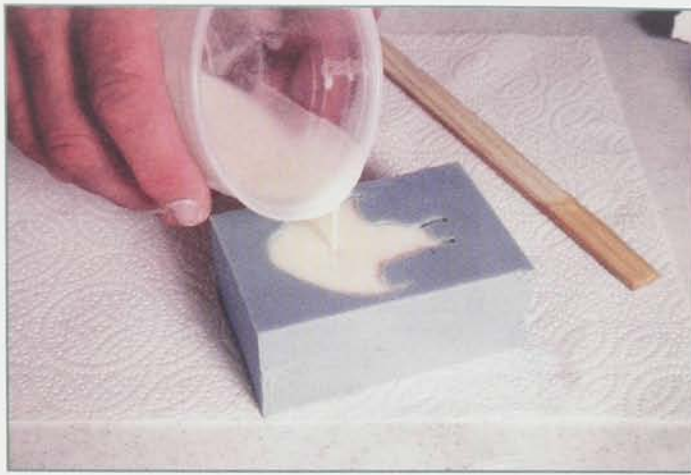
A sure and steady pour prevents air bubbles.
