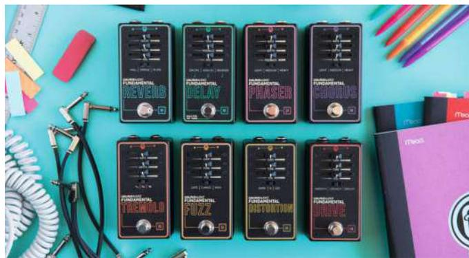
Walrus Audio stellen mit der Fundamental Series eine Reihe vergleichsweise preiswerter Pedale mit klassischen Effekten vor. Der erste Schwung der Serie umfasst die Effekte Reverb, Delay, Phaser, Chorus, Tremolo, Fuzz, Distortion und Drive. Die Bedienflächen sind einheitlich und verfügen je über einen Dreifach-Graphic-EQ und einen 3-Wege-Schalter.
