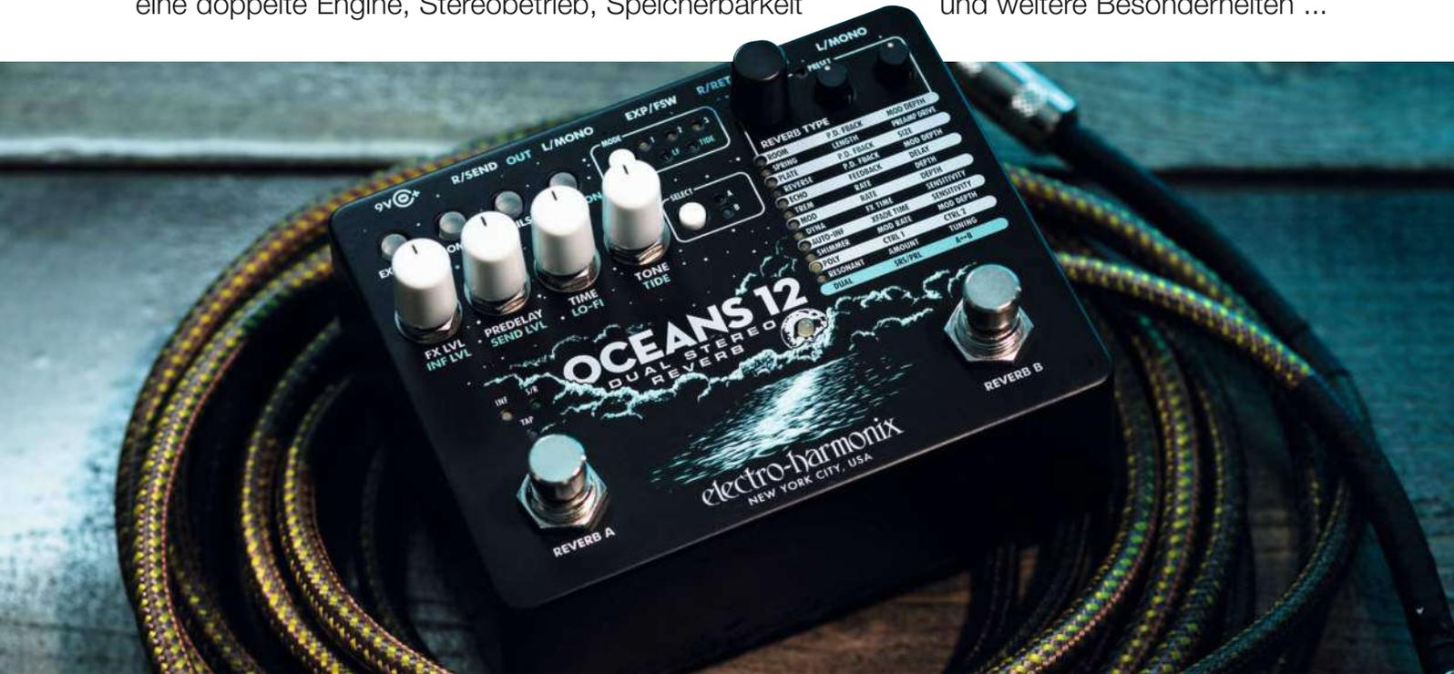
**D**as breite, gewohnt robust in einem Metallgehäuse untergebrachte Pedal bietet vier doppelt belegte Regler, einen Push-Encoder, zwei Stift-Potis und sechs Tasten. Hinzu kommen zwei Fußtaster, etliche Status-LEDs, Stereoein- und -ausgänge sowie ein Eingang für ein Expression-Pedal beziehungsweise bis zu drei zusätzliche Fußschalter. Ein Netzteil gehört ebenfalls zum Lieferumfang.
