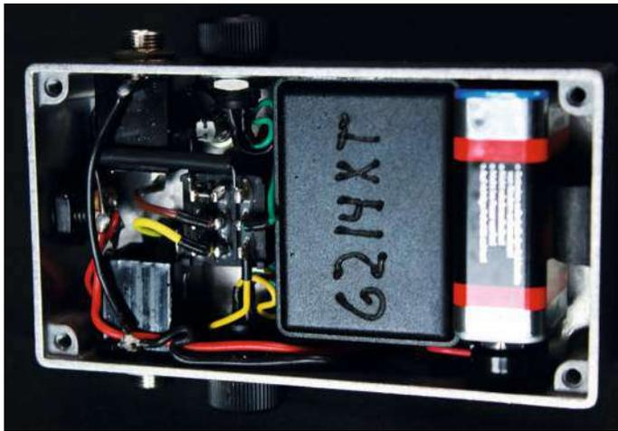
Innenraums einnimmt. Supercool übrigens, dass die Seriennummer oder Schaltungsbezeichnung mit dem Lötkolben in den Deckel der Kapsel eingebrannt ist – Pedal-Nerds, das ist für uns!
