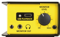
PRO-USB: wandelt digitale Audiosignale für niederohmige Analogsignale um.
