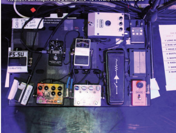
Boss-Fußschalter für das Eventide und das Amp-Master-Volume, MXR Carbon Copy, Boss TU-2, MXR Talk Box, Electrosonics Wireless System, Dvk GoldTop, Doug Aldrich Rocket Fuel Majik Box, Dunlop MC-404 Wah, MXR Phase 90
