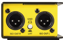
Die ISO-OUT-Buchsen verbinden die Ausgangssignale mit den Eingängen eines Mischpults oder ähnlichen Audiogeräten.
