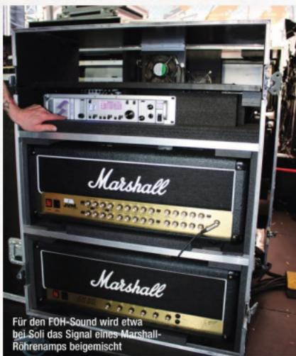
Für den FOH-Sound wird etwa bei Soli das Signal eines Marshall-Röhrenamps beigemischt
