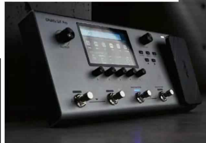
Das zurzeit erfolgreichste Effektpedal ist das DNAfx GiT Pro (€ 289), ein Multieffekt-Pedal mit Amp-Models, IRs und Exp./Vol.-Pedal.
