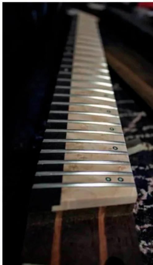
*Dank CAD-Software und CNC-Fräse können Griffbretter aus gleich mehreren Materialien und mit kunstvollen (Lum-) Inlays realisiert werden.*
