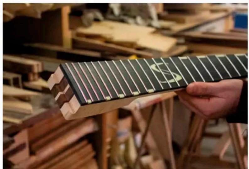
An der Bundierstation kommt es zur Hochzeit mit den fertig geschliffenen Hälsen, hier werden die Griffbretter vor dem Einsetzen der Bünde aufgeleimt.
