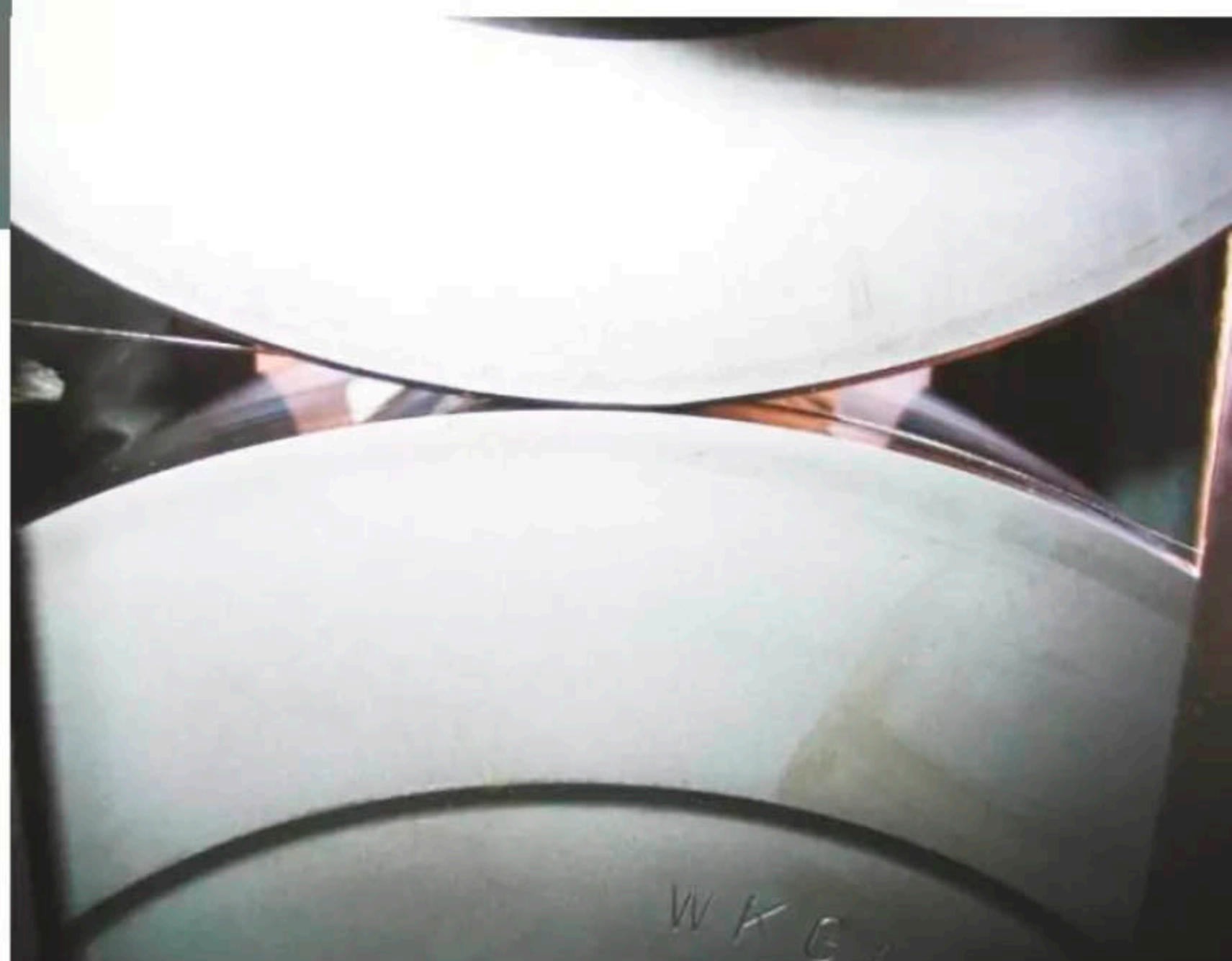
Mit mächtigen Walzen wird der Flachdraht in Form gebracht.
