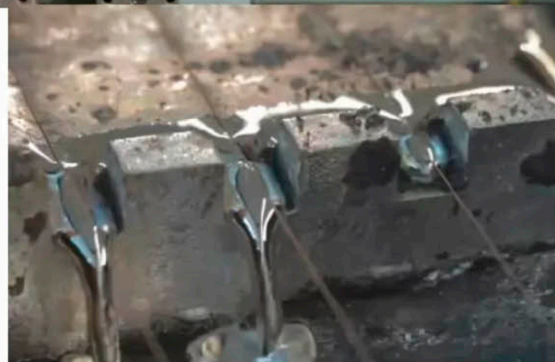
Ein Zinn-Bad schützt den Saitenkern später vor Korrosion.
