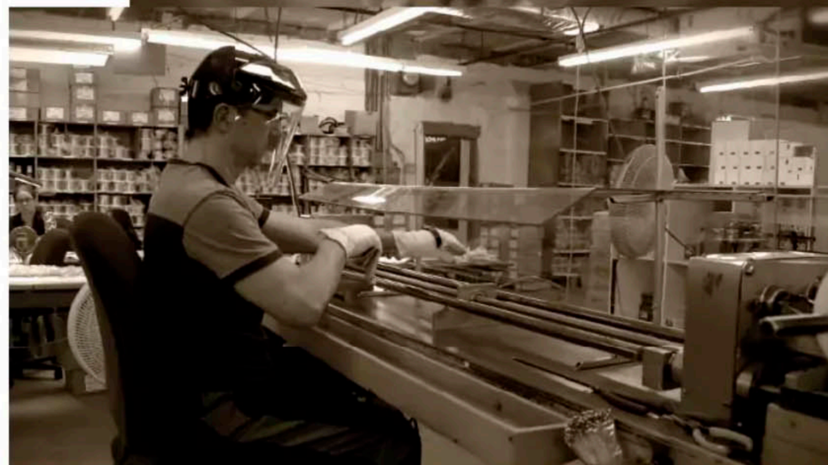
Ein Mitarbeiter von DR-Strings führt den Wicklungsdraht per Hand.
