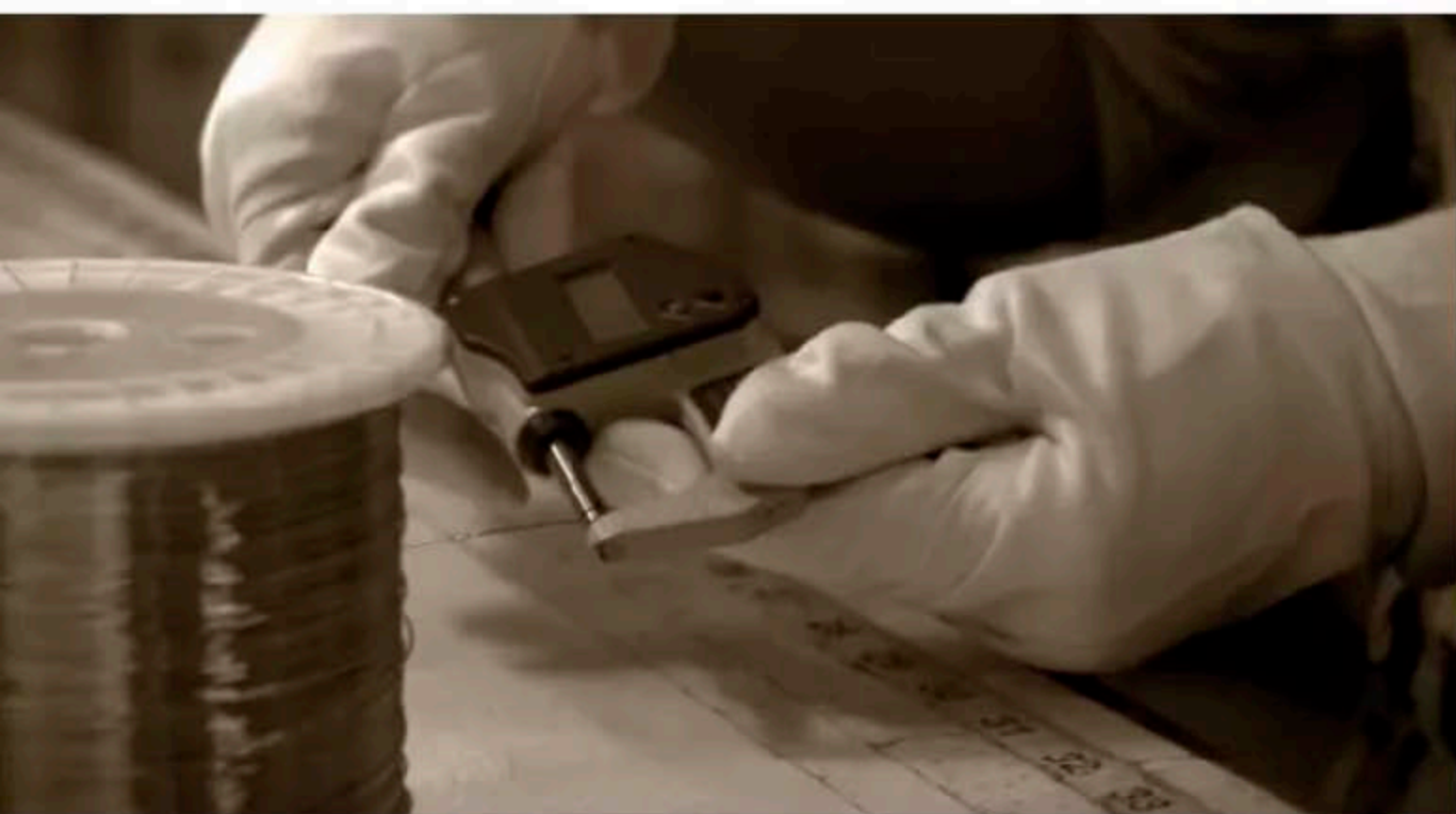
Der Wicklungsdraht kommt auf Spindeln an und wird auf seine Eigenschaften geprüft.
