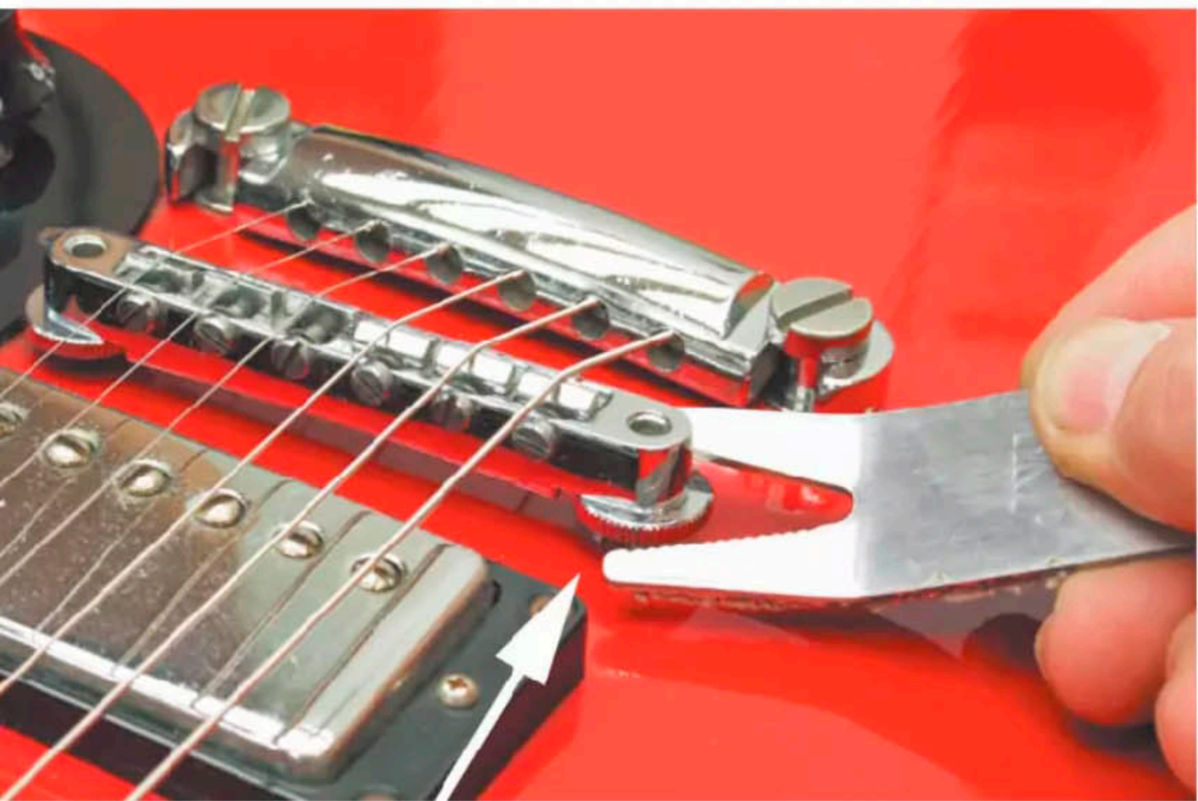
Abb. 5: Tune-o-matic. Hier reguliert man per Rändelmutter.
