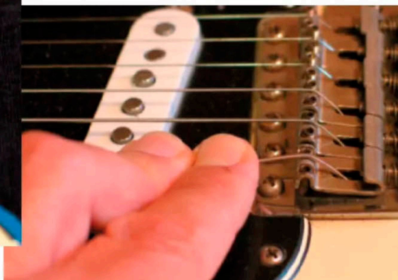
Hinter der Brücke abknicken
