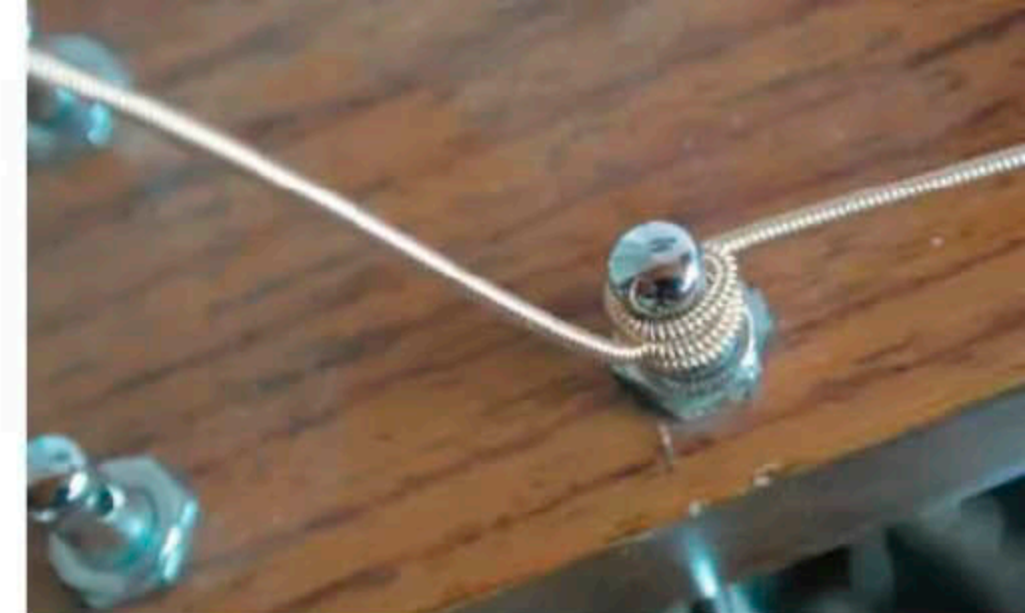
Dann noch zwei bis drei Wicklungen fein säuberlich nebeneinander, auf der Achse nach unten laufend, legen.
