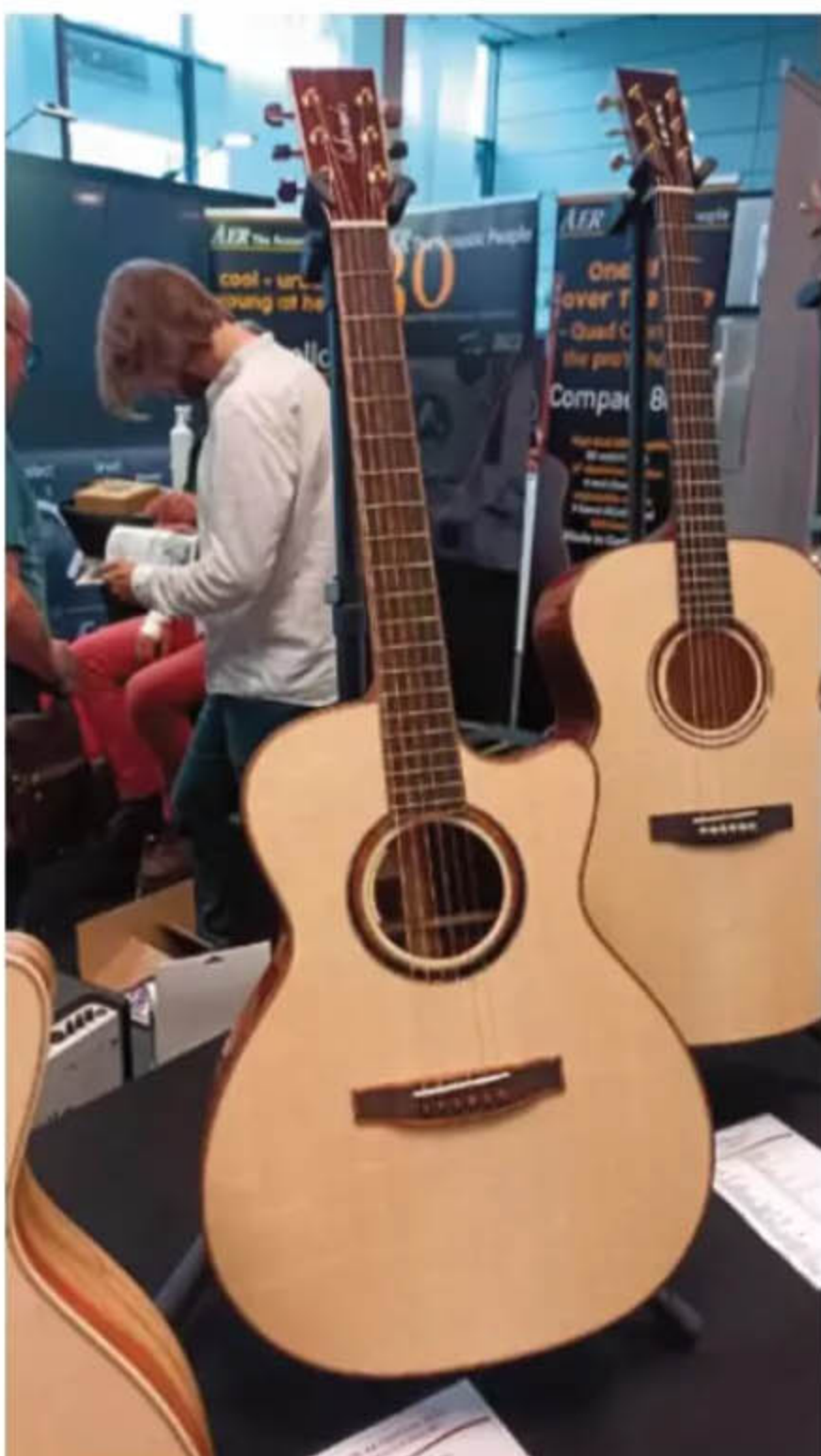
Auch Lakewood hatte mit der M-44 Edition 2020 Grand Concert Neues im Gepäck. Decke aus 4A europäischer Haselfichte, Boden/Zargen Grenadillo, Zedernhals, Bindings aus Koa, L.R.Baggs Anthem Pickup und Hiscox/Lakewood-Hardcase.
