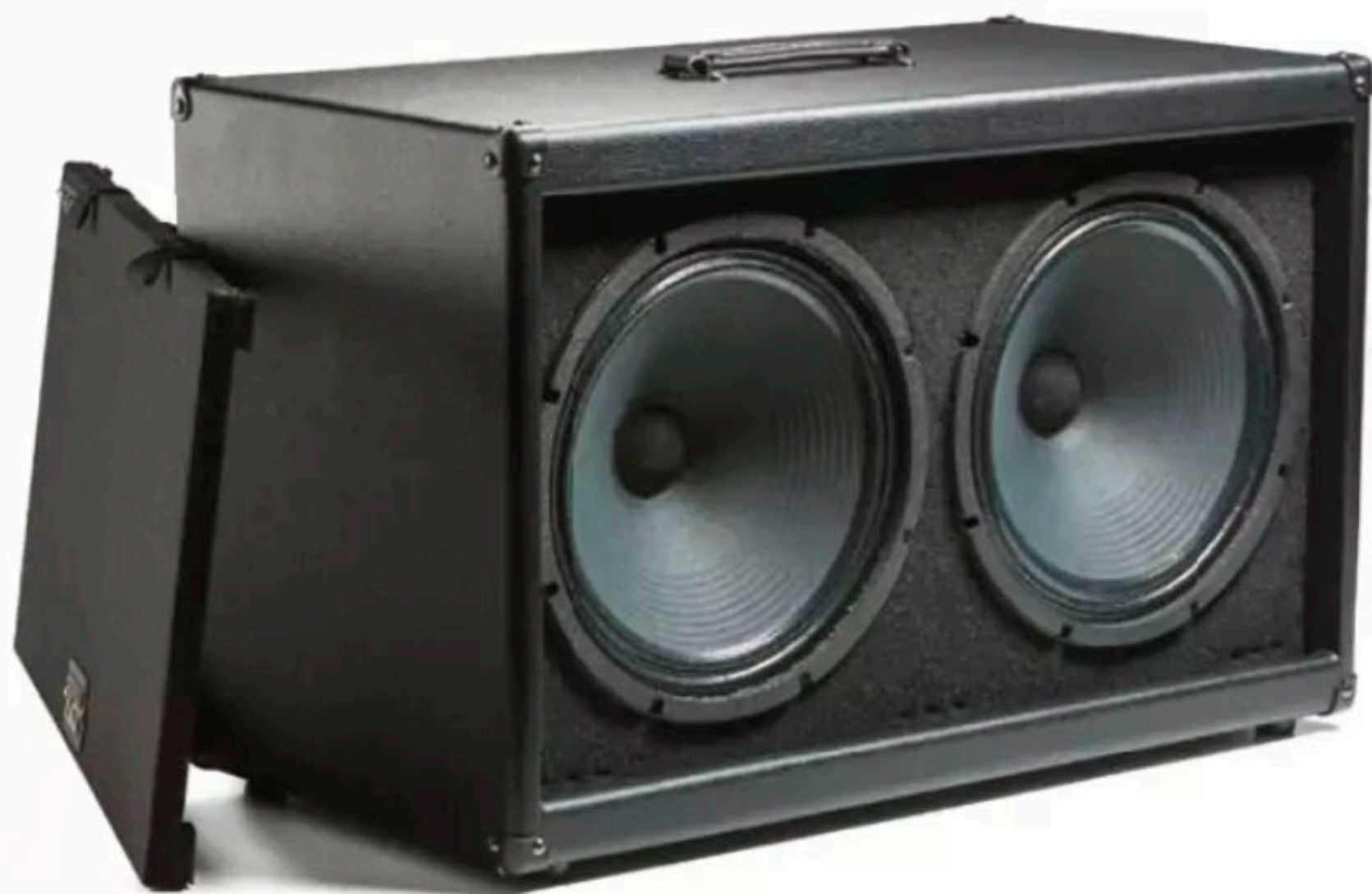
Klassische geschlossene 2x12"-Bauweise – hier mit „Front Mounted“-Lautsprechern für ein etwas breiteres Abstrahlverhalten und Filz auf der Schallwand zum Absorbieren von ungewollten Reflektionen.
