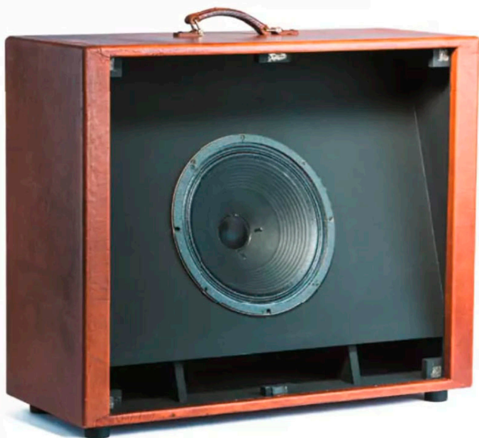
JM Speakers kombinieren bei ihrer „The Trunk“-Box ein großes Bassreflexgehäuse mit einer stark angeschrägten Schallwand, für mehr Ortbarkeit und Bassgehalt.
