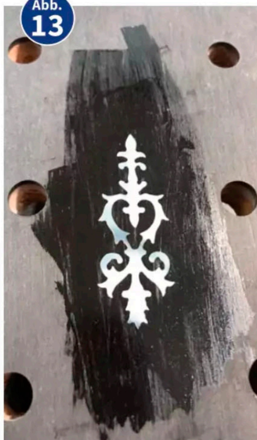
Nachfüllen mit einer transparenten Schicht Epoxydharz
