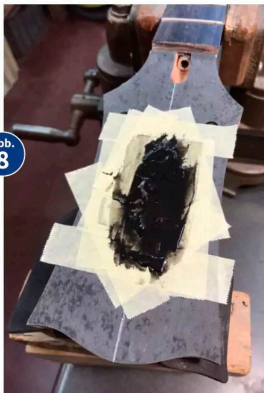
Satt aufgefüllt: die Fräsung mit eingelegtem Inlay
