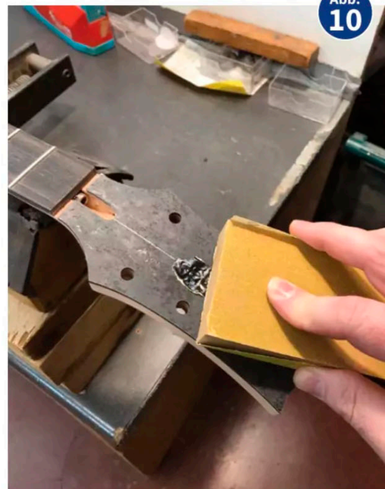
Der Füller wird mit einem Schleifklotz beigearbeitet.
