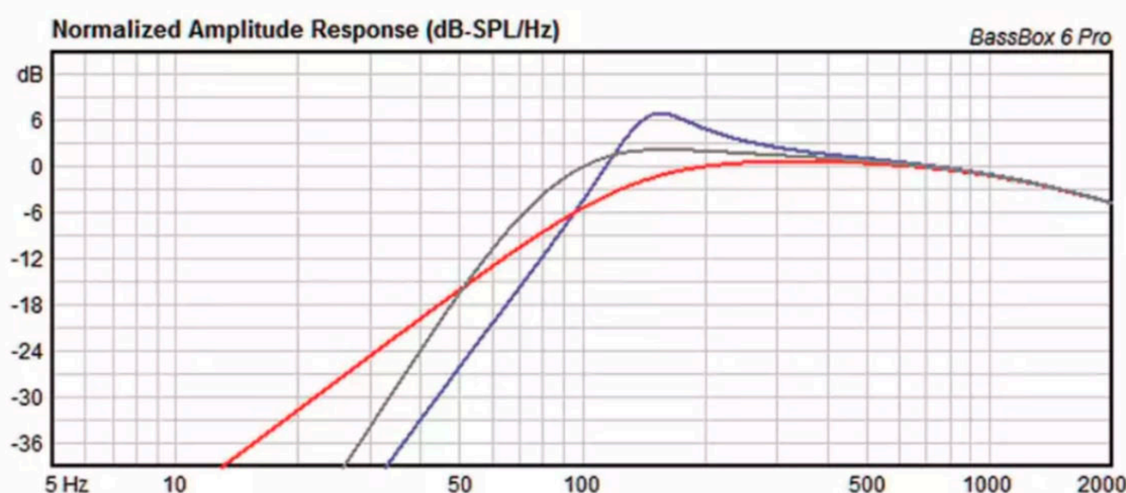
Das Bass-Verhalten von offenen (Blau), geschlossenen (Rot) und Bassreflexgehäusen (Schwarz) im Vergleich.
