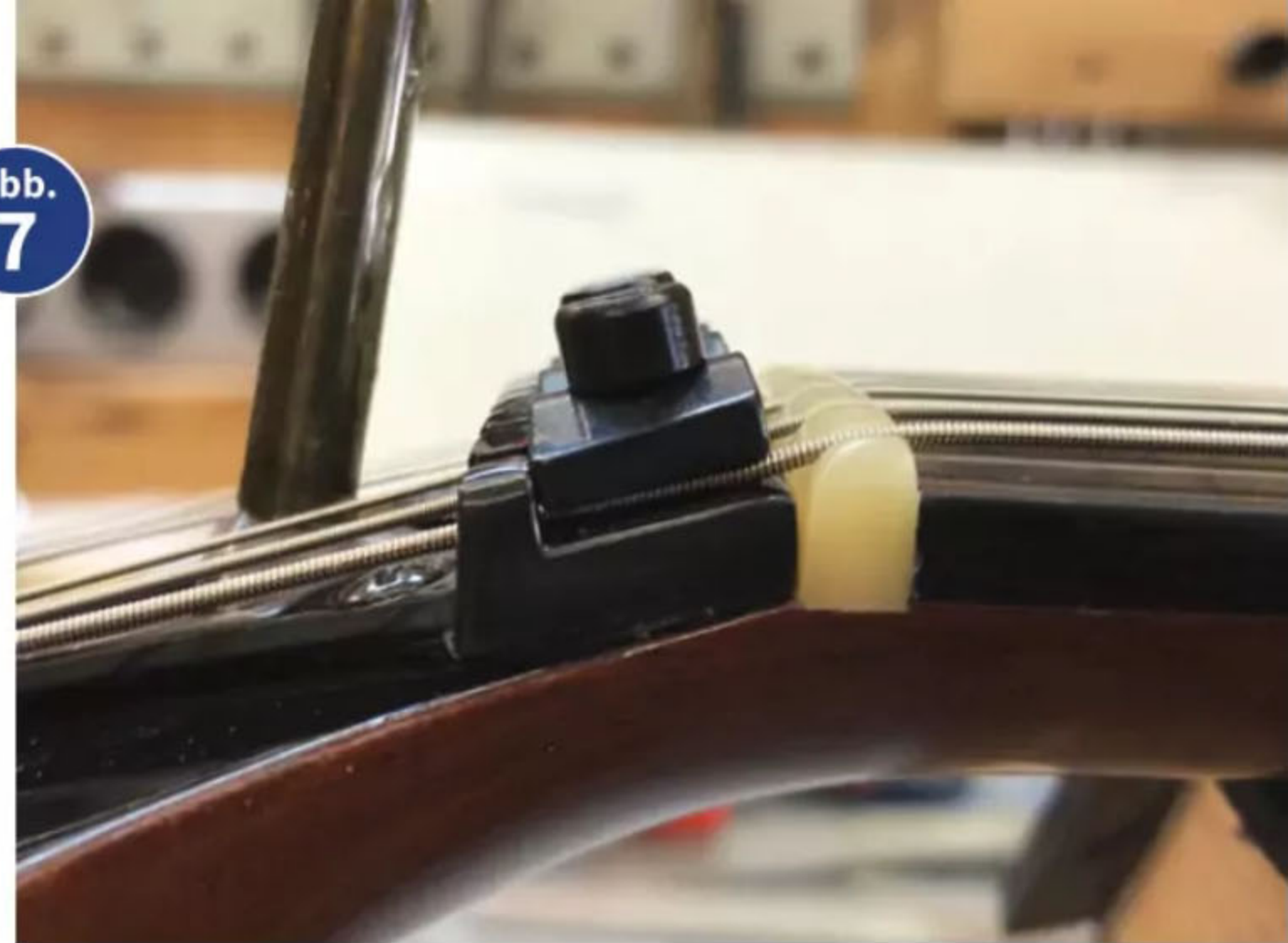
Der Klemmsattel fertig montiert
