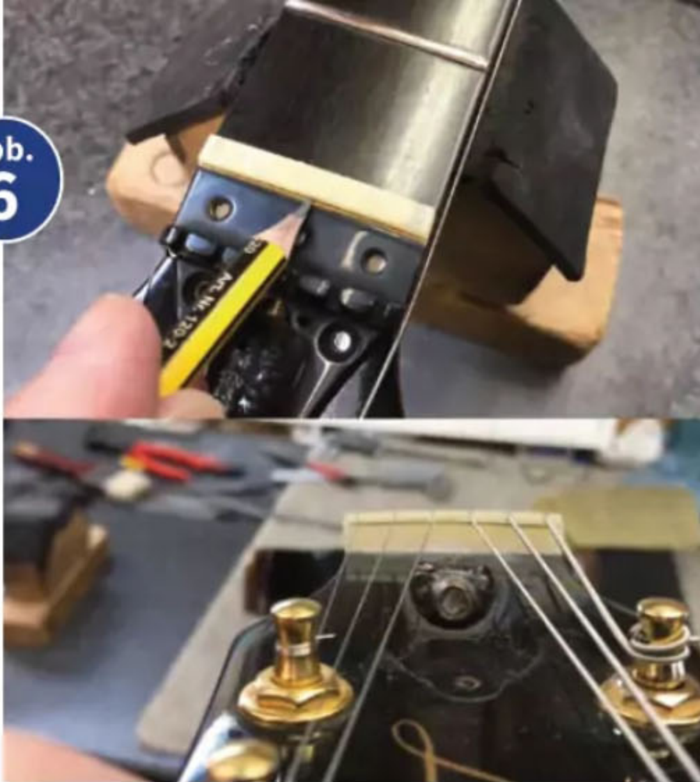
Anreißen und Feilen des Sattels
