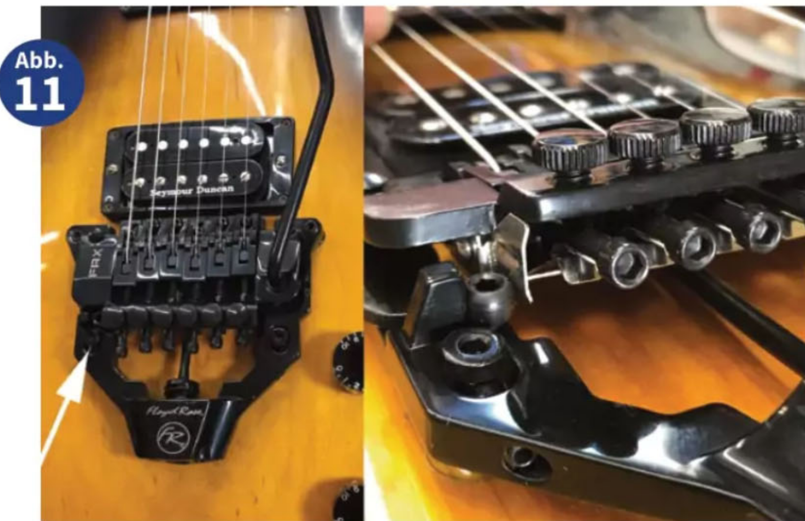
Die Stoptail-Bolzen liefern die Statik.
