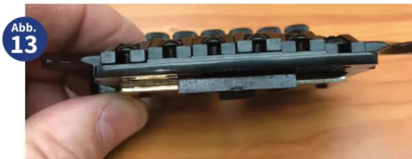
Gestufte Grundplatte mit gleichhohen Reitern
