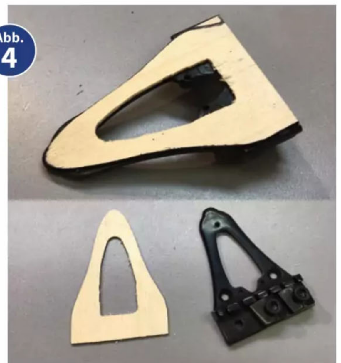
Unterfüttern des Klemmsattels
