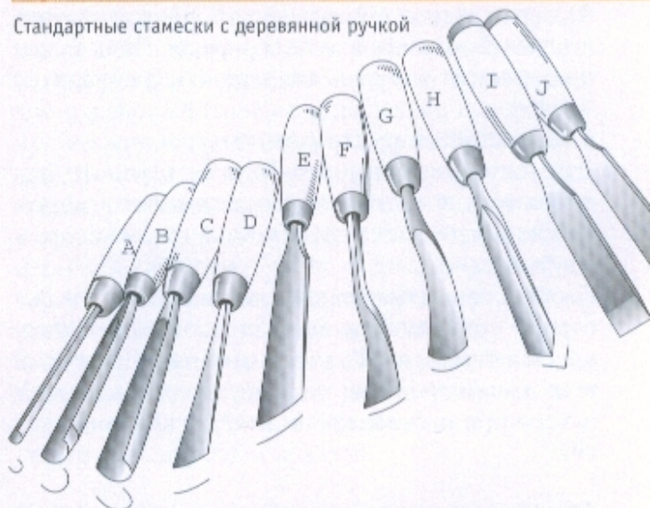
РИСУНОК 1. Стамески и их полотна: А и В. Средние стамески. С. Крутая стамеска. Д. Отлогая стамеска. Е. Прямая стамеска. Ф. Церазик. Г. Ключарза. Н. Уголок. I. Резак. J. Косяк
