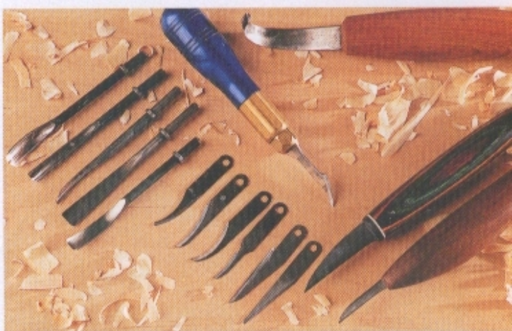
СВЕРХУ ВНИЗ ПО ЧАСОВОЙ СТЕЛКЕ: нож со сменным лезвием, нож с изогнутым лезвием, два ножа с фиксированным лезвием; лезвия и стамески для ножа первого типа
