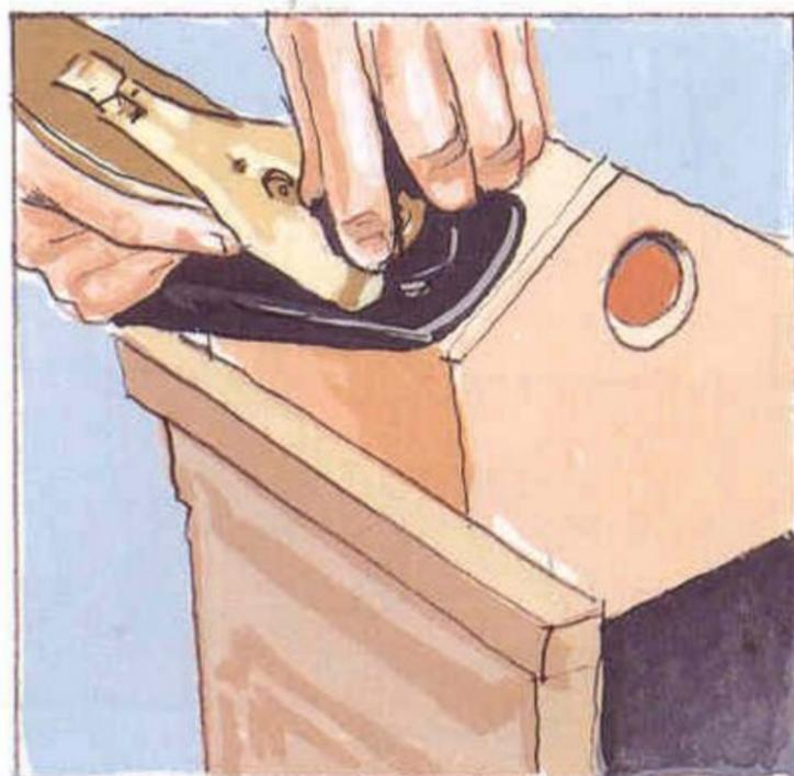
**12** Assemblez la cabine avec de la colle et des clous à tête de diamant, laissez sécher, et égalisez les surfaces à l'aide d'un rabot.
