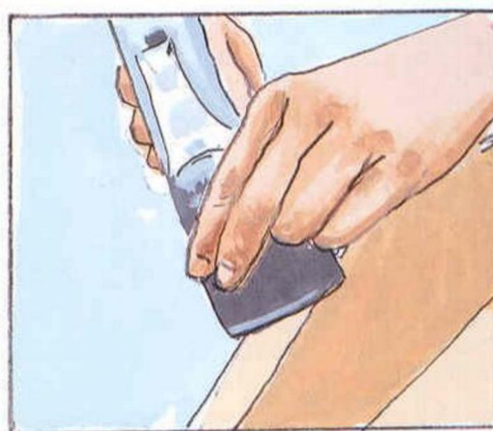
**3** Avec un rabot, taillez les bords de l'avant-toit en biseau à un angle de 45°. Vérifiez l'exactitude du travail avec une équerre à onglet ou une fausse équerre à coulisse réglée à 45°.
