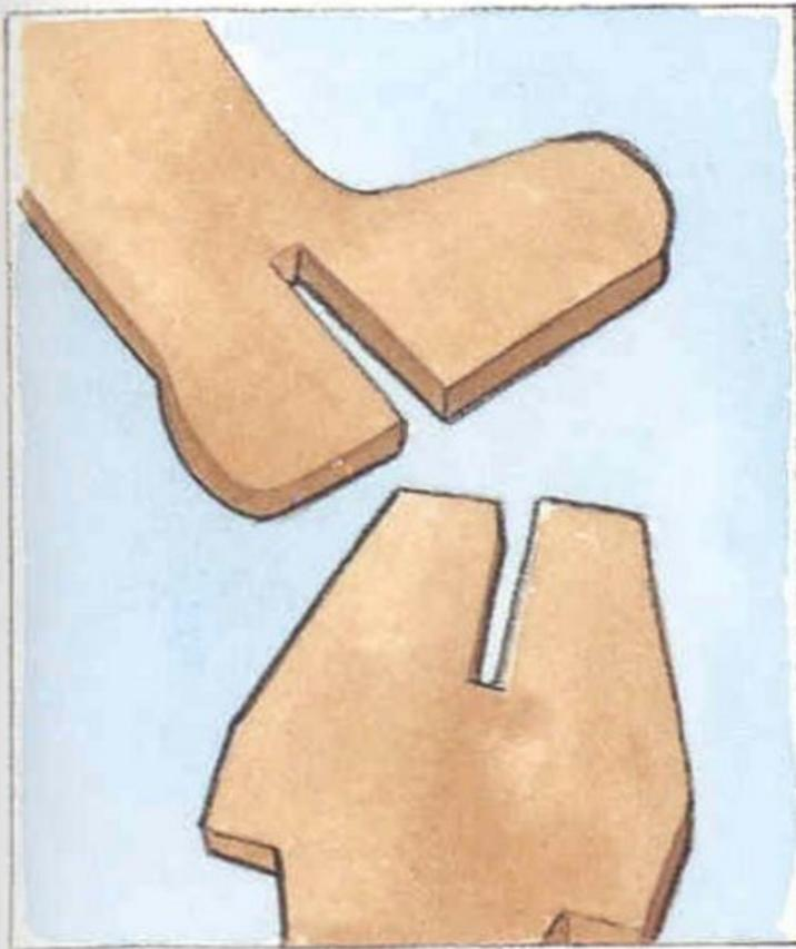
3 Préparez le piquet du pied de la même façon avec le reste du panneau de FDM le plus épais. Découpez une encoche dans le bas de la botte du jardinier et une autre sur le dessus du piquet. Les deux encoches doivent se trouver au centre et avoir une profondeur d'environ 150 mm. Elles doivent avoir une largeur de 25 mm pour que les deux pièces forment un joint solide.
