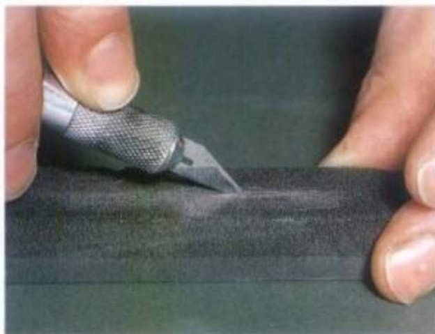
Para mantener afilada la hoja se lija su parte posterior.
