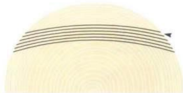
El corte rotatorio por mitades se empieza por la albura del tronco.
