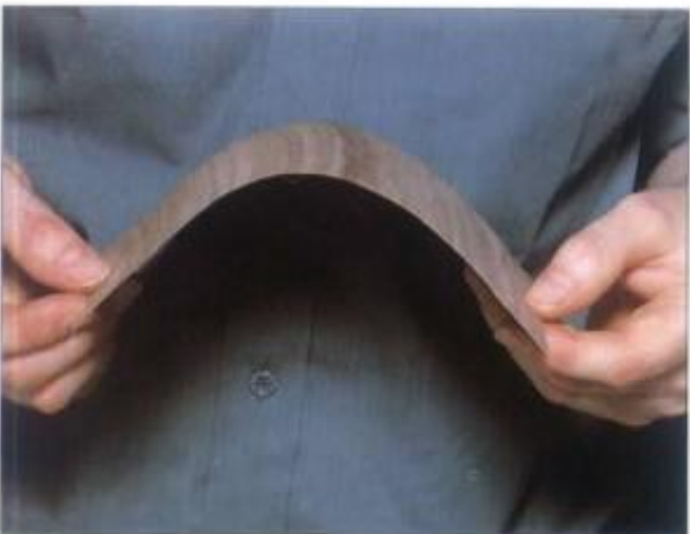
Las láminas se doblan con dificultad por el reverso.
