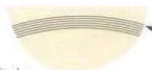
El corte rotatorio por mitades inverso se empieza por el corazón del tronco.
