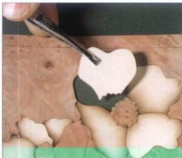
La pieza a sombrear es ligeramente mayor que la ventana. Después se recorta hasta que encaje en ella.
